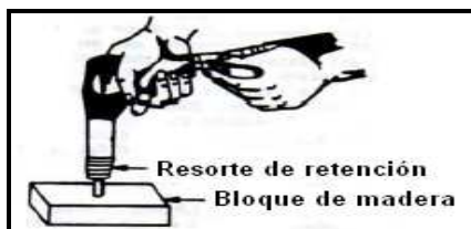
Figura 4.154. Ajuste de la pistola Remachadora en el Bloque de Madera. Fuente: Investigación documental. Tomado de: Manual de la IAFA.
