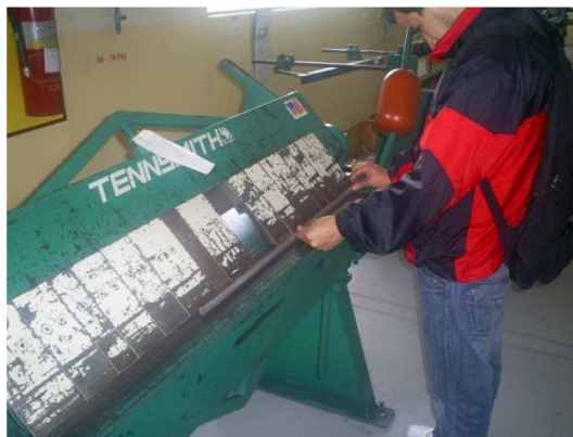
Figura 4.56. Doblado de las pestañas en la dobladora de caja. Fuente: Investigación de campo. Editado por: Luis Calderón.
