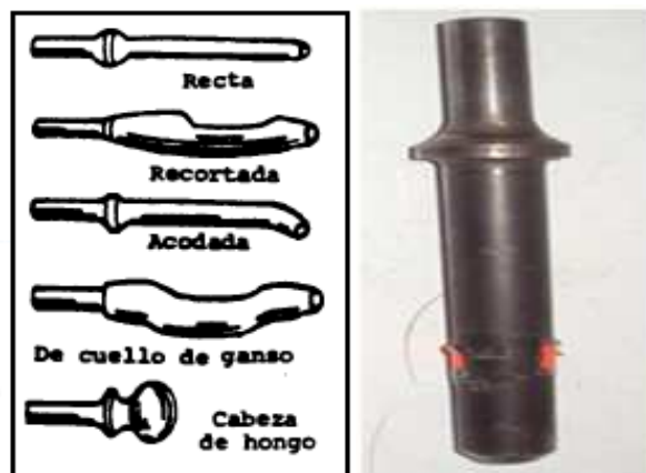
Figura 3.40 Tipos de Buterolas. Fuente: Investigación documental y de campo. Tomado de: Manual de la IAAFA y fotografías.
