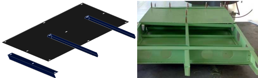
Figura 4.180. Ubicación de los larguerillos y el revestimiento pequeño para remachar. Fuente: Investigación de campo. Editado por: Luis Calderón.
