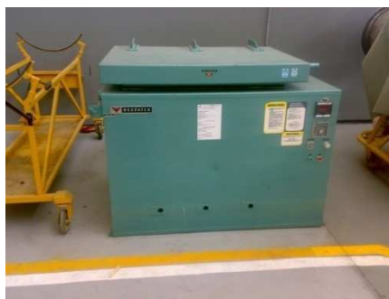
Horno de tratamiento térmico
