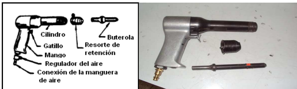
Figura 3.43. Nomenclatura de la Pistola Remachadora. Fuente: Investigación documental y de campo. Tomado de: Manual de la IAAFA y fotografías.
