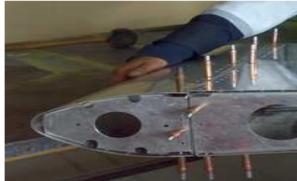
Figura 4.145. Perfil alar sujetado a la pestaña delantera de la viga del borde de ataque. Fuente: Investigación de campo. Editado por: Luis Calderón.
