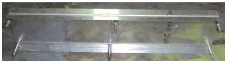
Figura 4.27. Viga del borde de ataque (Front Spar). Fuente: Investigación de Campo. Editado por: Luis Calderón.
