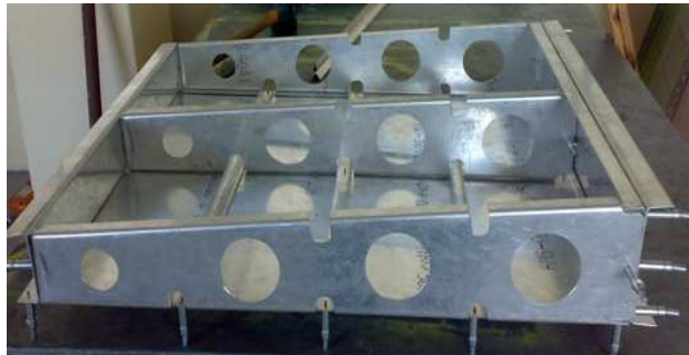
Figura 4.124. Larguerillos y costillas maestras sobrepuestas. Fuente: Investigación de campo. Editado por: Luis Calderón.
