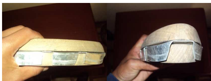
Figura 4.94. Doblado de las pestañas en el molde. Fuente: Investigación de campo. Editado por: Luis Calderón.
