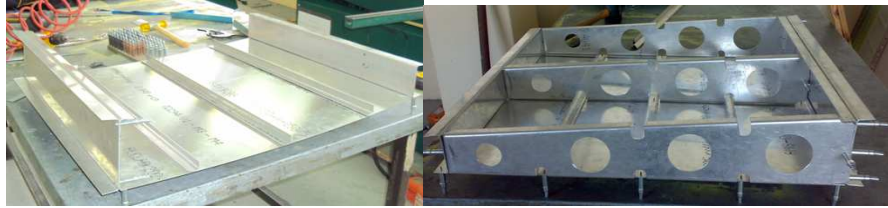
Figura 4.172. Partes sujetadas con clecos para proceder a remachar. Fuente: Investigación de campo. Editado por: Luis Calderón.
