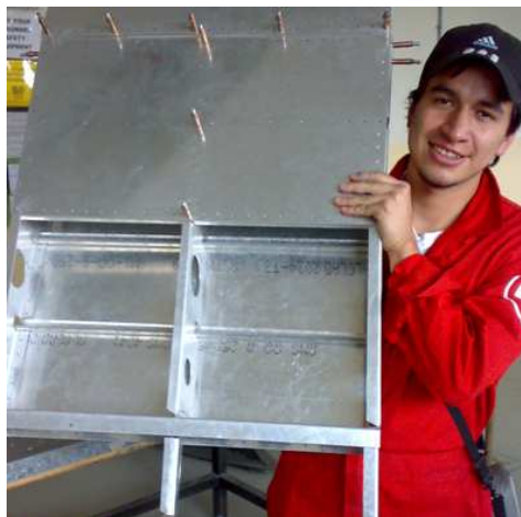
Figura 4.141. Revestimiento, larguerillos y pestaña de la viga del borde de ataque taladradas.
