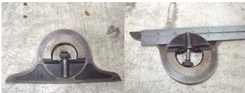
Figura 3.15. Transportador de ángulos. Fuente: Investigación documental. Tomado por: http://www.bricotodo.com/medir.htm .
