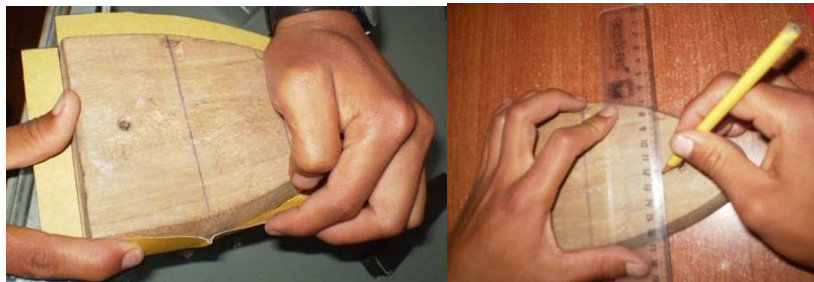
Figura 4.84. Trazado de las líneas ubicación de las ranuras. Fuente: Investigación de campo. Editado por: Luis Calderón.
