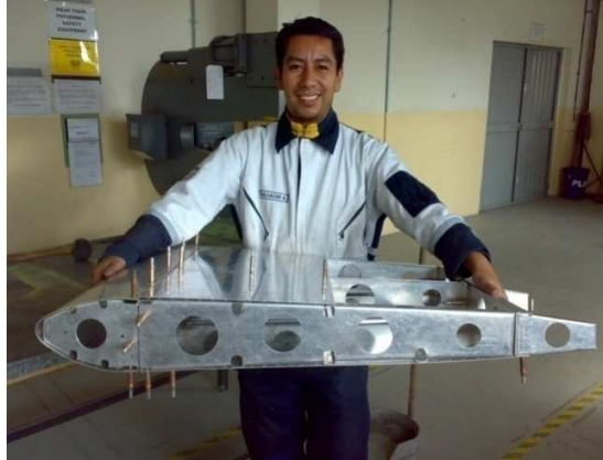
Figura 4.148. Partes ensambladas con clecos. Fuente: Investigación de campo. Editado por: Luis Calderón.
