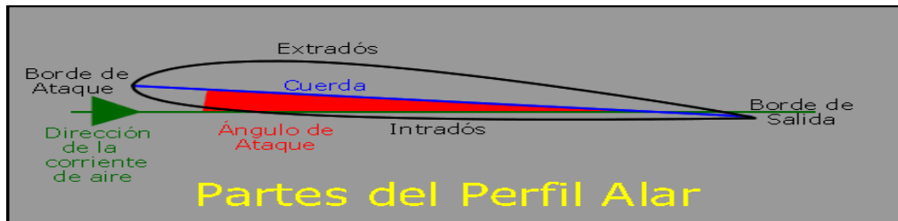
Figura 2.7. Partes del Perfil Alar.
