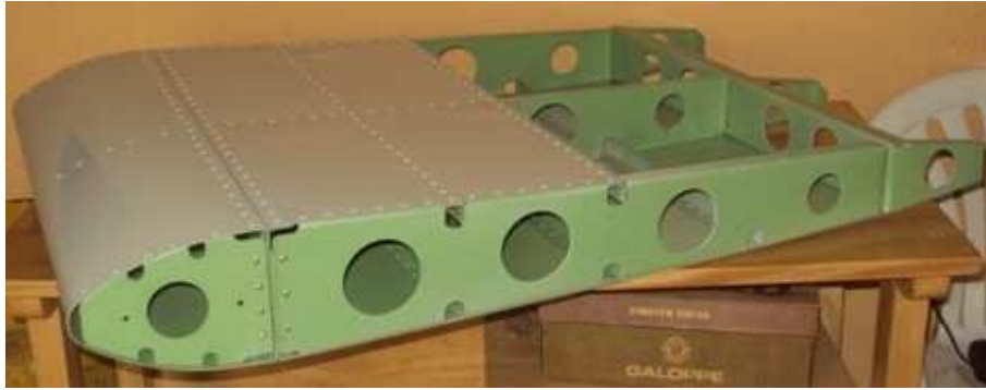
Figura 4.183. Prototipo estructural de ala terminado. Fuente: Investigación de campo. Editado por: Luis Calderón.
