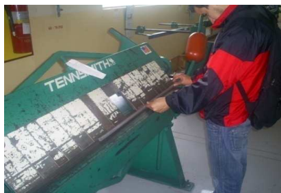
Figura 4.102. Doblado en la dobladora de caja. Fuente: Investigación de campo. Editado por: Luis Calderón.
