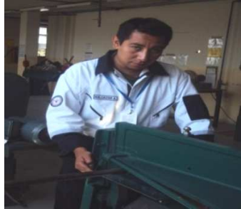
Figura 4.105. Corte de la lámina en la cizalla hidráulica. Fuente: Investigación de campo. Editado por: Luis Calderón.
