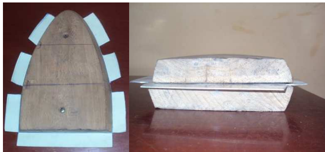
Figura 4.91. . Orificios taladrados en los moldes y costilla delantera falsa. Fuente: Investigación de campo. Editado por: Luis Calderón.
