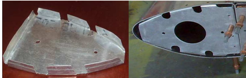
Figura 4.95. Costilla delantera falsa terminada. Fuente: Investigación de campo. Editado por: Luis Calderón.
