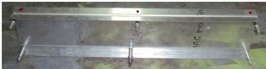
Figura 4.71. Marcas para taladrar las pestañas delanteras de la viga del borde de ataque. Fuente: Investigación de campo. Editado por: Luis Calderón.
