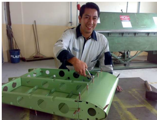
Figura 4.176. Perfil alar sujetado con clecos. Fuente: Investigación de campo. Editado por: Luis Calderón.
