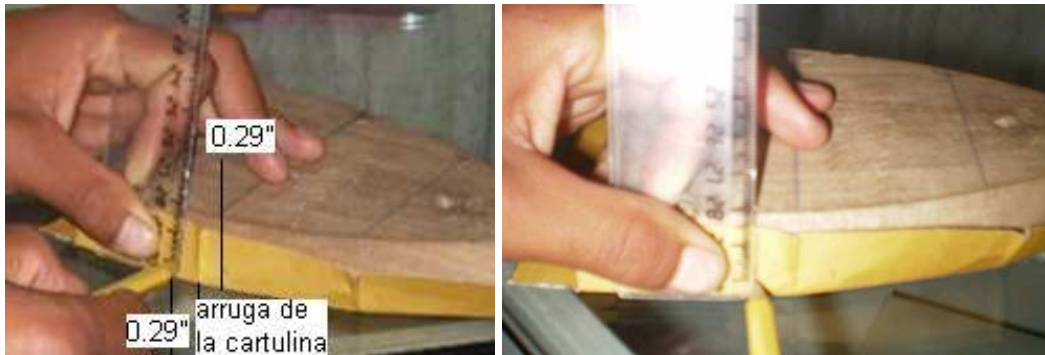
Figura 4.85. Trazado de las líneas para las ranuras a 0.29" Fuente: Investigación de campo. Editado por: Luis Calderón.
