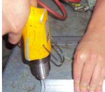
Figura 4.53. Taladrado de los orificios de Alivio de Tensión. Fuente: Investigación de campo. Editado por: Luis Calderón.
