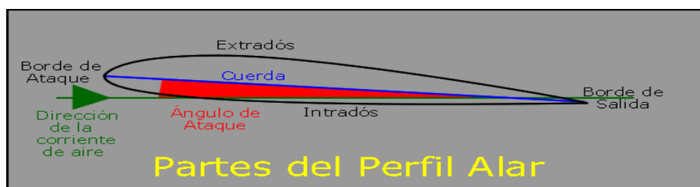
Figura 6. Partes del Perfil Alar.
