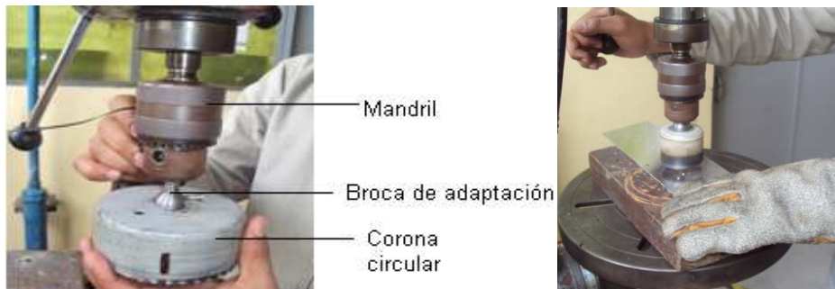
Figura 4.63. Perforación de los agujeros de aligeramiento. Fuente: Investigación de campo. Editado por: Luis Calderón.
