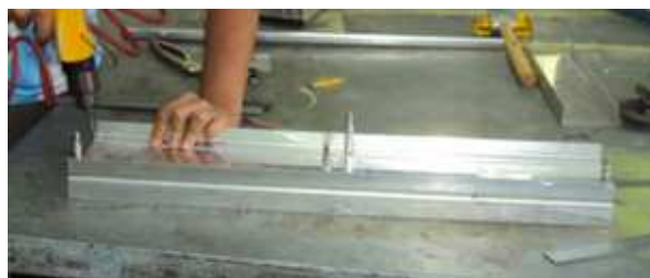
Figura 4.45. Taladrado en las pestañas posteriores y la viga del borde de ataque.
