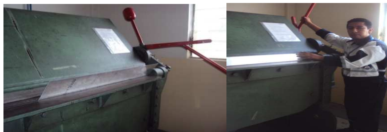
Figura 4.23. Doblado de la viga. Fuente: Investigación de Campo. Editado por: Luis Calderón.
