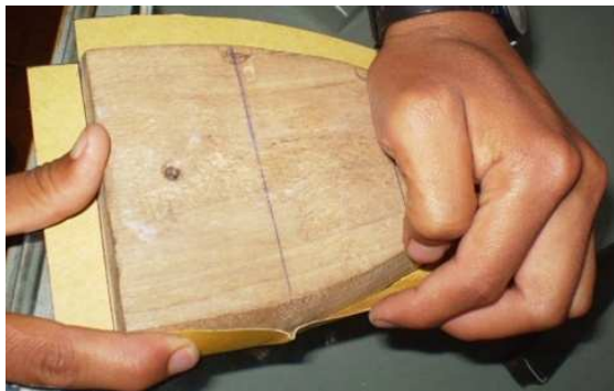
Figura 4.81. Doblado de las pestañas de la cartulina hacia adentro para ver donde se arruga. Fuente: Investigación de campo. Editado por: Luis Calderón.
