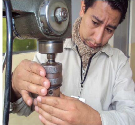
Preparación del taladro de pedestal.
