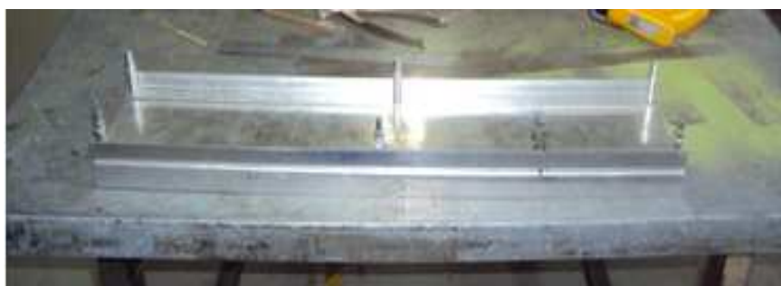
Figura 4.40. Pestañas posteriores para la viga del borde de ataque. Fuente: Investigación de campo. Editado por: Luis Calderón.
