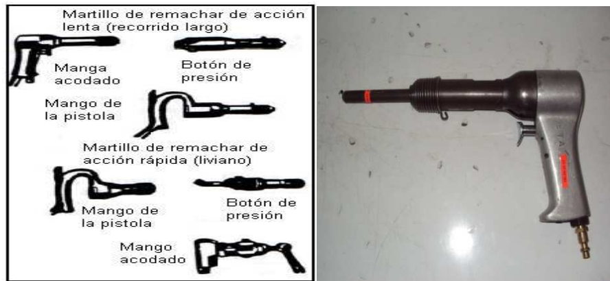
Figura 3.41. Pistolas remachadoras. Fuente: Investigación documental y de campo. Tomado de: Manual de la IAAFA y fotografías.
