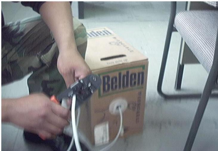
**12. PREPARACION DEL CABLE PARA EL CONECTOR RJ -45**
