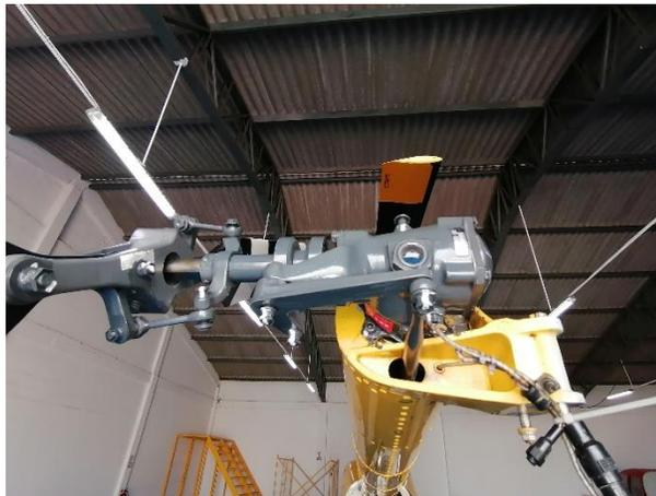
*Nota.* La figura muestra la inspección de la Gearbox del rotor de cola y el nivel de aceite.
