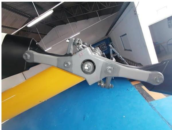
*Nota.* La figura muestra la inspección de la condición del Hub, Hub Plates y del cojinete Elastomérico del rotor de cola.
