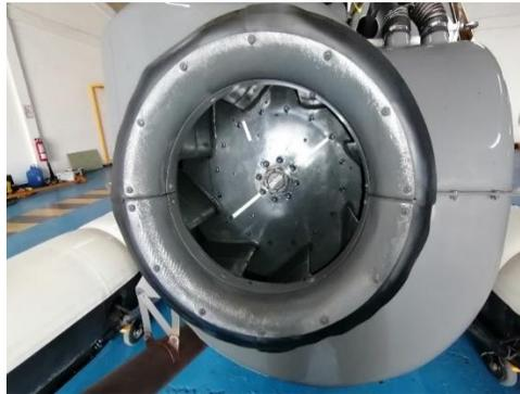
*Nota.* La figura muestra la inspección de la condición del conjunto Fanwheel y los bordes de ataque de las aspas, así como la alineación del pin.
