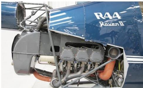
*Nota.* La figura muestra la Planta Motriz de la aeronave Robinson R44 visto del lado izquierdo. Tomado de (Helicopter, 2013)
