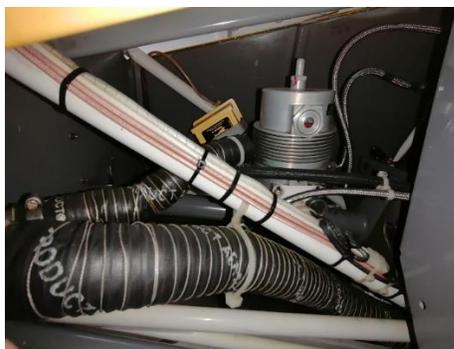
*Nota.* La figura muestra la inspección de la manguera de refrigeración del reservorio hidráulico y Telatemp.
