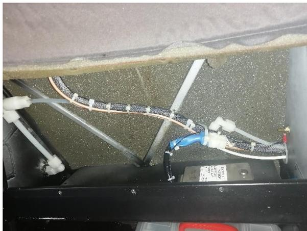
*Nota.* La figura muestra la inspección del cableado eléctrico y de la unidad de control del alternador.
