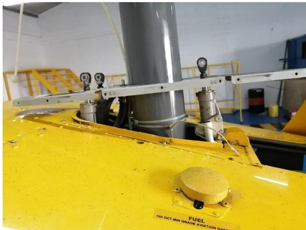
*Nota.* La figura muestra la inspección de las tijeras inferiores del Swashplate que se encuentran montados en los seros hidráulicos.
