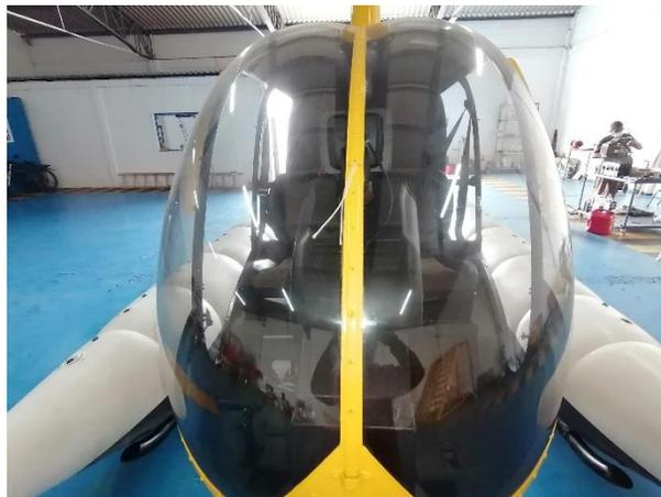
*Nota.* La figura muestra la inspección de la condición del parabrisas y sus juntas.
