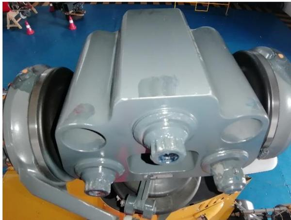
*Nota.* La figura muestra la inspección del Hub del Rotor Principal y la fricción de los pernos “Teeter” y “Coning”
