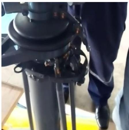
*Nota.* La figura muestra la inspección del conjunto de los tubos Push-Pull verticales del Mast Fairing
