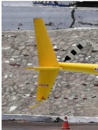
*Nota.* La figura muestra el empenaje del Helicóptero Robinson r44
