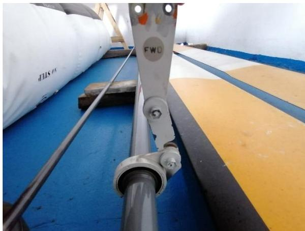
*Nota.* La figura muestra la inspección de la condición del d mper del drive Shaft.
