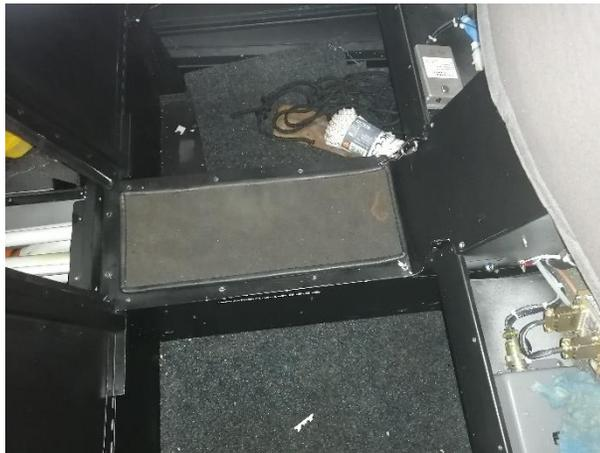
*Nota.* La figura muestra la inspección del interior de la cabina en busca de algún elemento caído o suelto.
