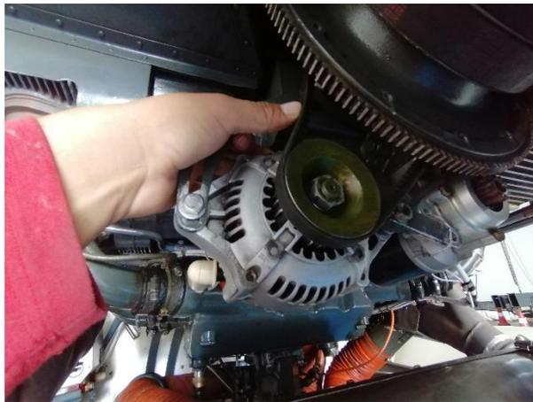
*Nota.* La figura muestra la inspección de la banda del alternador.
