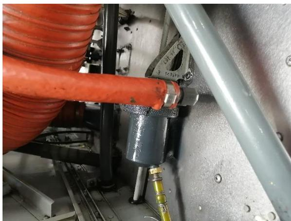
*Nota.* La figura muestra la inspección y lubricación del Gascolator.
