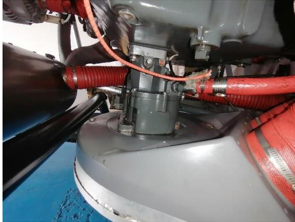
*Nota.* La figura muestra la inspección de la caja de aire y filtro de aire.
