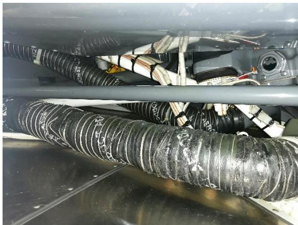
*Nota.* La figura muestra la inspección de la condición de las mangueras de enfriamiento de la MRGB.
