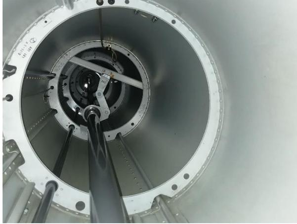
*Nota.* La figura muestra la inspección de la condición interna del Tailcone.
