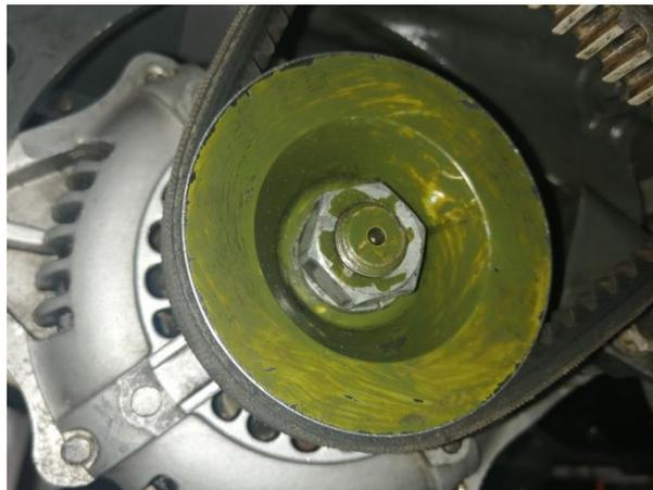
*Nota.* La figura muestra la inspección de la condición del alternador y de su polea.
