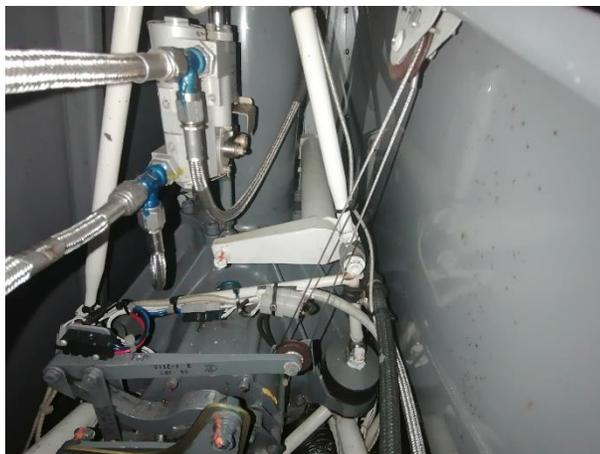
*Nota.* La figura muestra la inspección del conjunto de freno del helicóptero.
