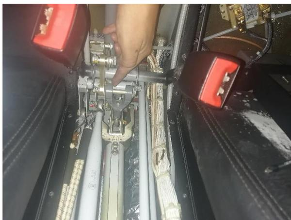
*Nota.* La figura muestra la inspección de la horquilla y tubo de torsión.
