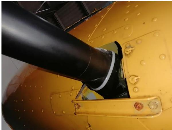
*Nota.* La figura muestra la inspección de los puntos de sujeción de los travesaños del Tren de Aterrizaje.
