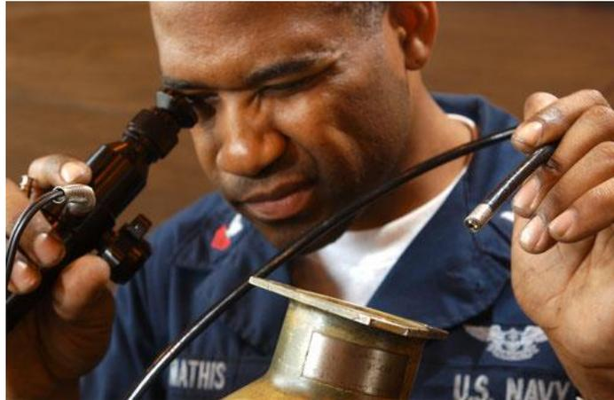
*Nota.* La figura muestra una inspección visual indirecta con una herramienta auxiliar “Baroscopio”. Tomado de (Atehortua, 2019).
