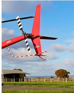
*Nota.* La figura muestra los Estabilizadores de la aeronave Robinson R44 a la misma altura del rotor de cola. Tomado de (Rugged, 2017)
