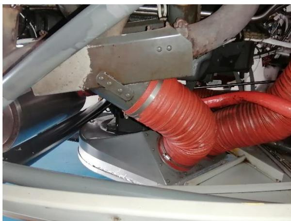
*Nota.* La figura muestra la inspección de la manguera del calentador del carburador.
