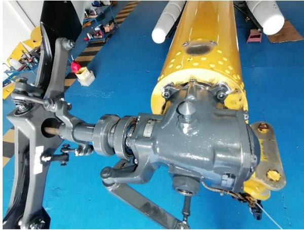
*Nota.* La figura muestra la inspección de los Rod Ends, tubo Push-Pull, pitch control y bellcrank del rotor de cola.
