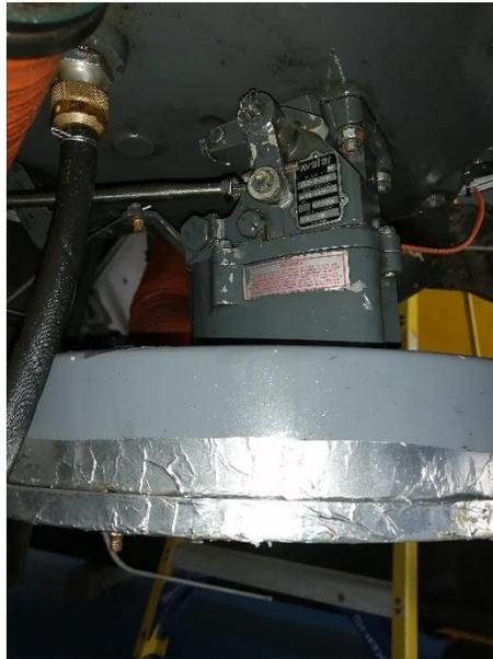
*Nota.* La figura muestra que la caja de aire este colocado cinta de aluminio para ayudar a su sellado (Solo en Clipper I).
