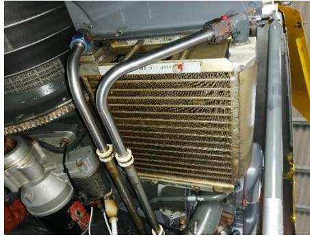
*Nota.* La figura muestra la inspección de los Baffles del enfriador de aceite.
