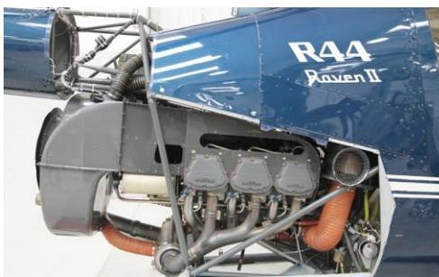
*Nota.* La figura muestra el motor de combustión interna de 6 cilindros opuestos del R44 visto del lado izquierdo. Tomado de (Helicopter, 2013)
