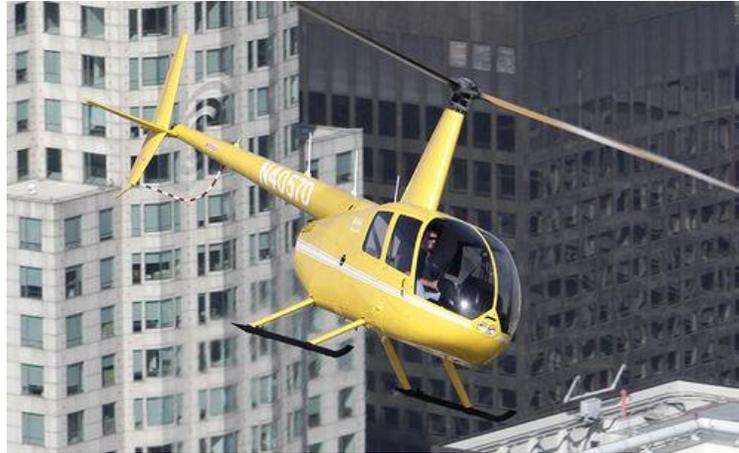
*Nota.* La figura muestra el Fuselaje de la Aeronave Robinson R44 Clipper I con tanques de combustible de tipo vejiga. Tomado de (AeroExpo, 2019)
