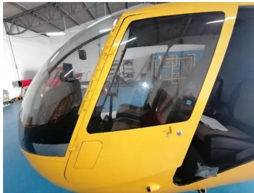
*Nota.* La figura muestra la inspección del conjunto de la puerta lateral izquierda.
