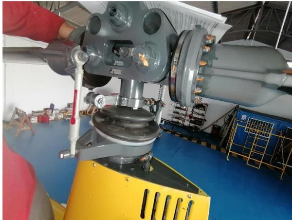
*Nota.* La figura muestra la inspección de los Linkages, sus Rod Ends, Coter Pins de los pernos Teeter y Coning, así como las líneas de torsión del Hub del Rotor Principal.
