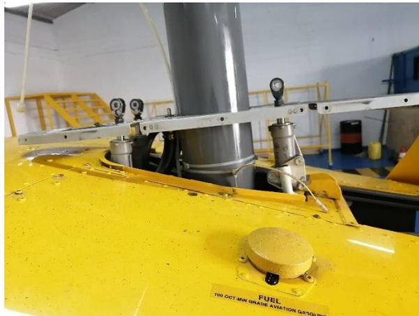
*Nota.* La figura muestra la inspección de la condición del conjunto de los servos hidráulicos delanteros y posteriores.
