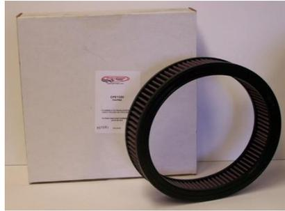
*Nota.* La figura muestra el filtro de aire de marca Challenger que se inspecciona por condición o cada 500 Horas. Tomado de (Aviation, Parts Executive. Inc, 2005)
