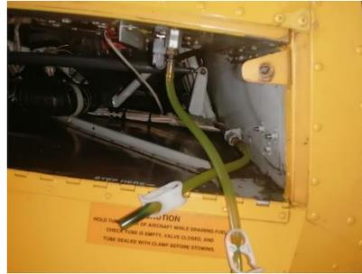
*Nota.* La figura muestra la inspección de los drenes, resorte y sello de los tanques de combustible.
