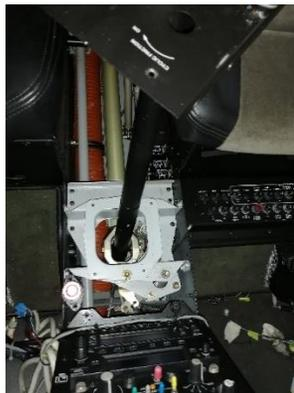
*Nota.* La figura muestra la inspección del tubo del cíclico.
