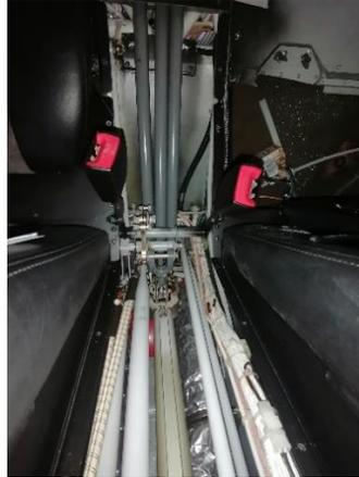
*Nota.* La figura muestra la inspección de los tubos “Push-Pull” del cíclico, así como los Tubos “Push-Pull” verticales que se dirigen al Hub.
