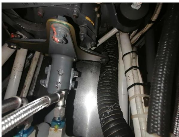
*Nota.* La figura muestra la inspección del Flex Plate delantero y sus arandelas.
