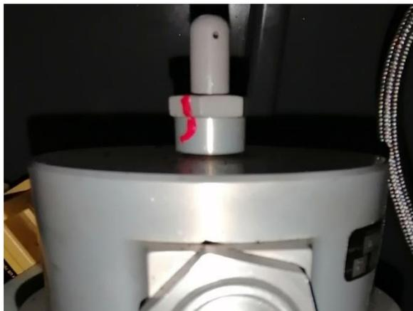
*Nota.* La figura muestra la inspección de la seguridad del torque y línea de fe del tapón del reservorio hidráulico.
