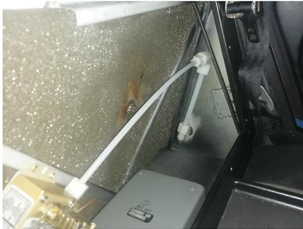
*Nota.* La figura muestra la inspección del cableado, así como líneas del Pitot y Estático.
