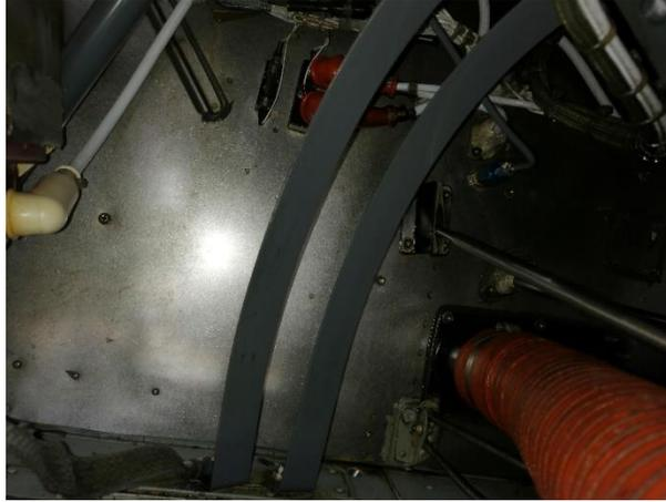
*Nota.* La figura muestra la inspección de la pared de fuego vertical y cableado eléctrico de la misma.
