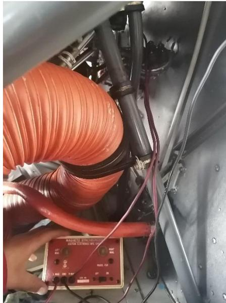
*Nota.* La figura muestra la sincronización de magnetos al grado determinado por el motor.
