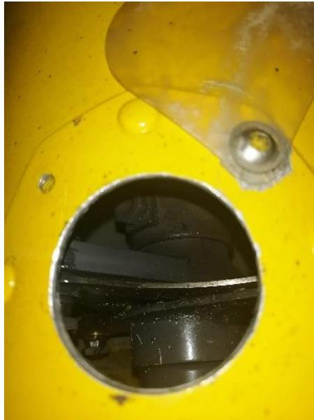
*Nota.* La figura muestra la inspección de la condición del Flex Plate y Yokes posteriores.
