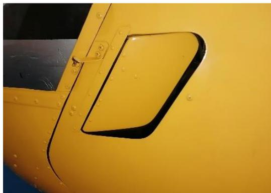
*Nota.* La figura muestra la inspección de la condición de la tapa de ventilación de la puerta lateral izquierda.
