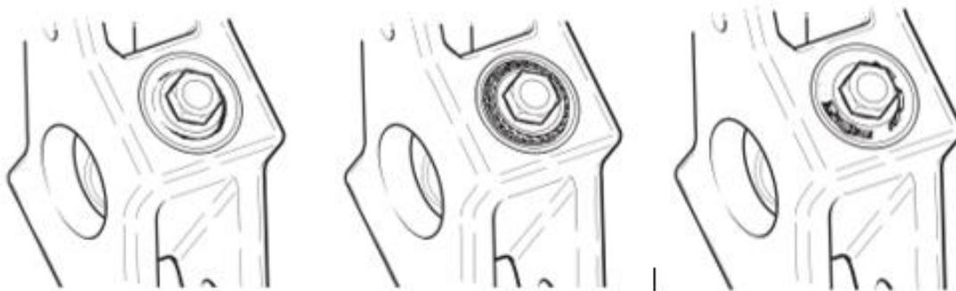
*Nota.* La figura muestra un Elastomeric Bearings con fatiga, con contaminación de aceite y uno con sobre velocidad”. Tomado de (Robinson, Helicopter Company, 2021)
