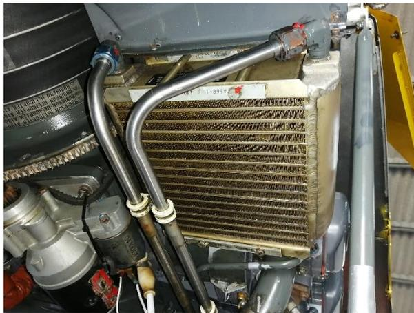
*Nota.* La figura muestra la inspección del “Oil Cooler”, líneas de aceite, Ty-raps y abrazaderas.
