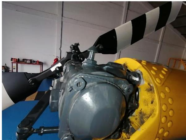
*Nota.* La figura muestra la inspección sellos del posteriores del drive Shaft al rotor de cola.
