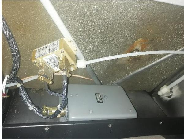
*Nota.* La figura muestra la inspección del controlador del gobernador, así como las tomas de drenaje del sistema de Pitot y Estático.
