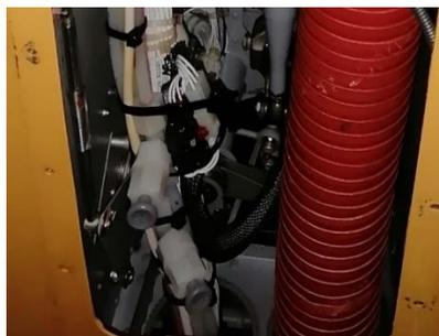
*Nota.* La figura muestra la inspección de las líneas estáticas y de Pitot.
