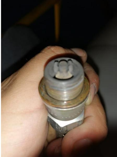
*Nota.* La figura muestra la inspección de una bujía por condición.
