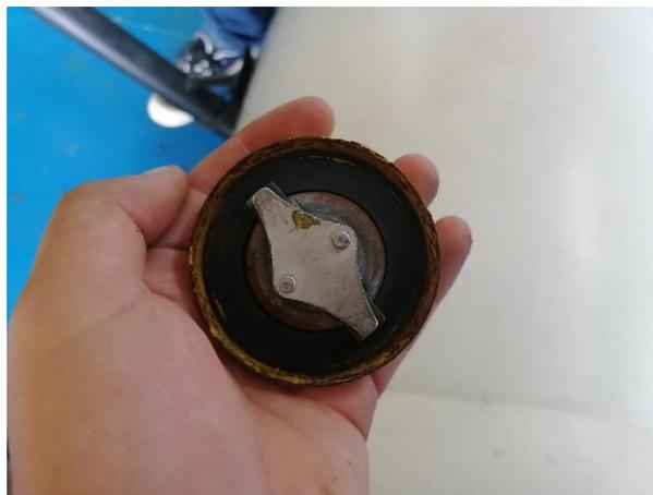
*Nota.* La figura muestra la inspección de la condición de las tapas de combustible.
