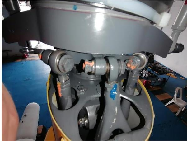
*Nota.* La figura muestra la inspección del funcionamiento de la tijera superior, brazo, rodamiento de bola y espaciadores del Swashplate.
