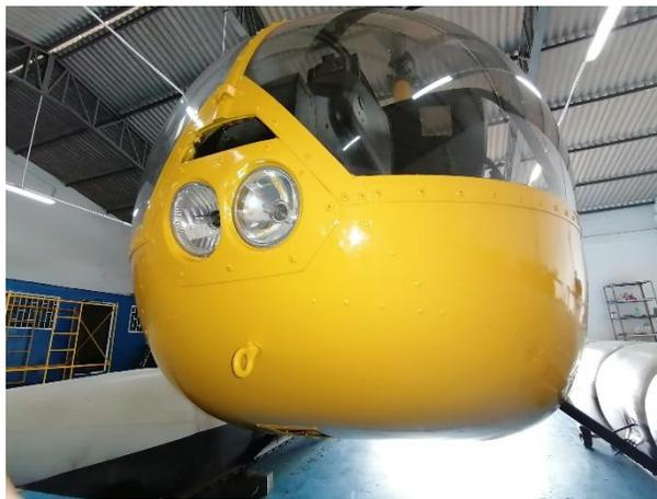
*Nota.* La figura muestra la inspección de la “skin” y remaches de la cabina
