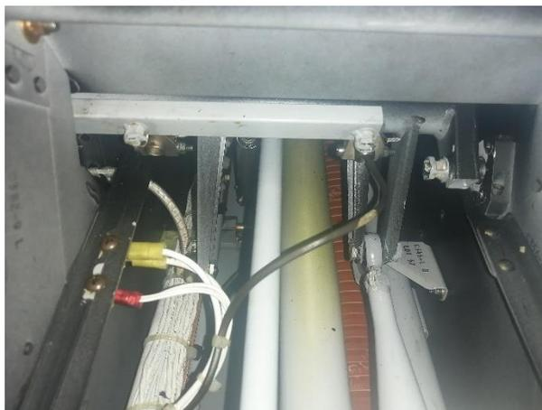
*Nota.* La figura muestra la inspección de la lata y soldaduras que sostiene el conjunto Bellcrank de la sección 4E.
