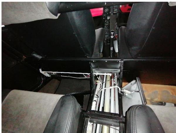
*Nota.* La figura muestra la inspección del conjunto de conexión, motor y brazo del colectivo.
