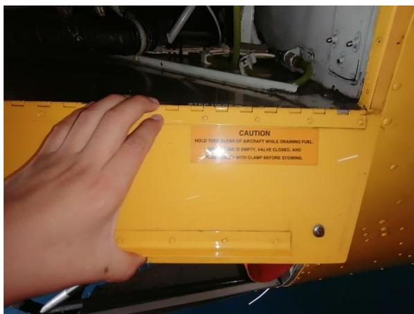
*Nota.* La figura muestra la inspección de la compuerta, bisagras, Yoke de la MRGB, y el cableado eléctrico.
