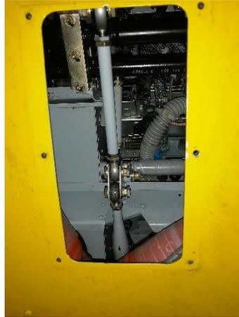
*Nota.* La figura muestra la inspección del tubo “Push-Pull” y Rod Ends del rotor de cola.
