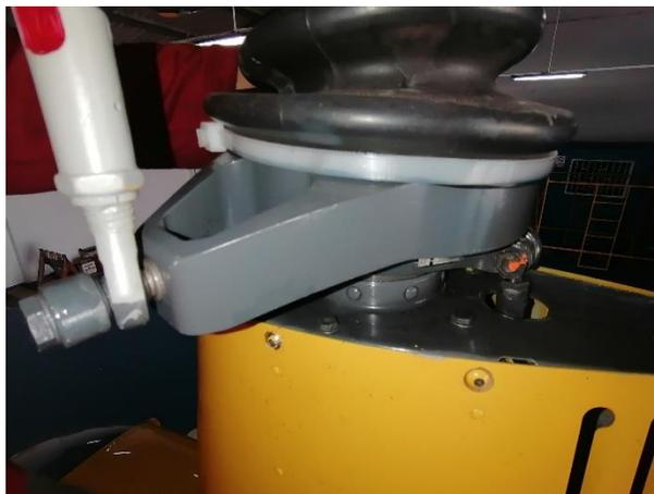
*Nota.* La figura muestra la bota del Swashplate que se debe retirar para inspeccionar el área de Slider.
