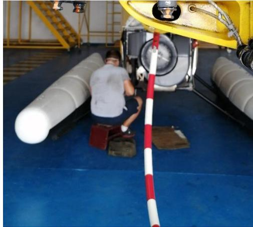
*Nota.* La figura muestra la inspección del protector del rotor de cola.
