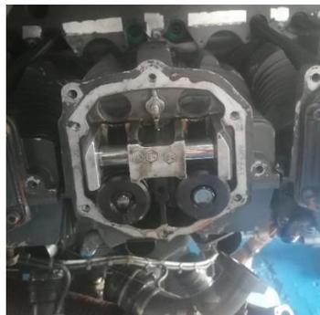
*Nota.* La figura muestra la inspección de las válvulas de admisión y escape de los cilindros.
