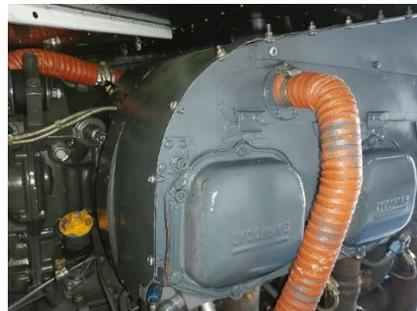
*Nota.* La figura muestra la inspección de todas las tapas de válvulas de los cilindros.
