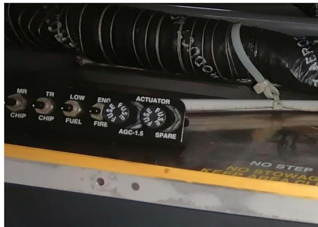
*Nota.* La figura muestra la inspección de la condición de la carcasa, así como de los switch y fusibles.
