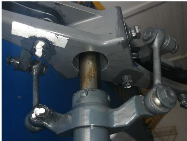
*Nota.* La figura muestra la inspección de los pitches links y sus Rod Ends.
