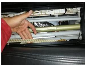
*Nota.* La figura muestra la inspección de los cordones elásticos.
