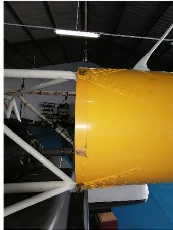
*Nota.* La figura muestra la inspección de los puntos de sujeción de la cola a la estructura superior de tubos de aceros.
