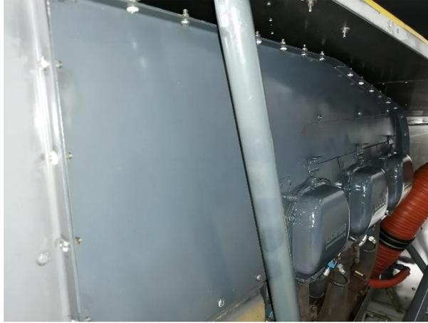
*Nota.* La figura muestra la inspección de los paneles del motor y mangueras.
