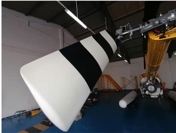
*Nota.* La figura muestra la inspección de las palas del rotor de cola.
