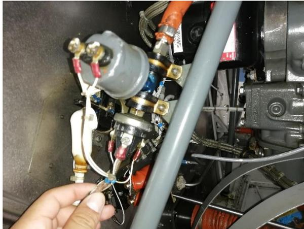
*Nota.* La figura muestra la inspección de la condición el cableado eléctrico del motor.
