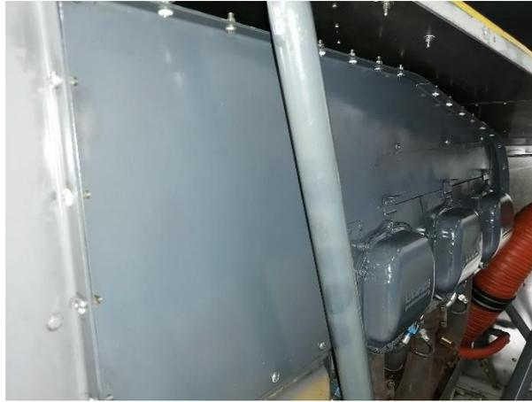
*Nota.* La figura muestra la inspección de los paneles de enfriamiento del motor.
