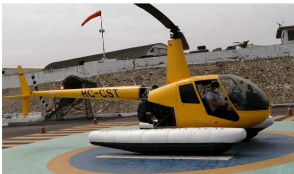
*Nota.* La presente Figura muestra el helicóptero Robinson R44 Clipper I con Flotadores Fijos de la empresa DELIPESCA S.A. en el cual se desarrollará la Inspección de 100 Horas.
