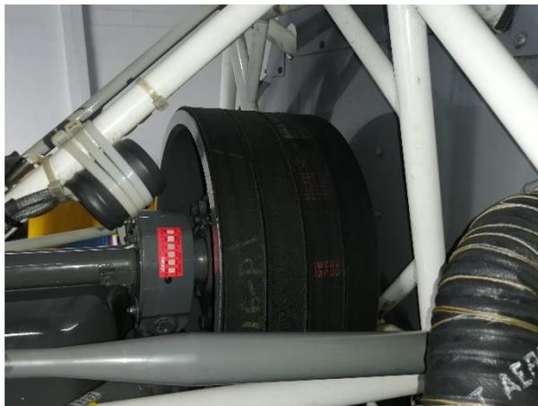
*Nota.* La figura muestra la inspección de las ranuras de la polea superior y de las bandas.
