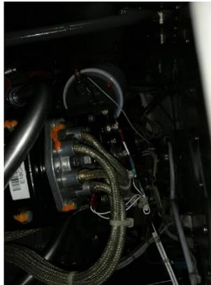
*Nota.* La figura muestra la inspección del magneto del lado izquierdo del motor.
