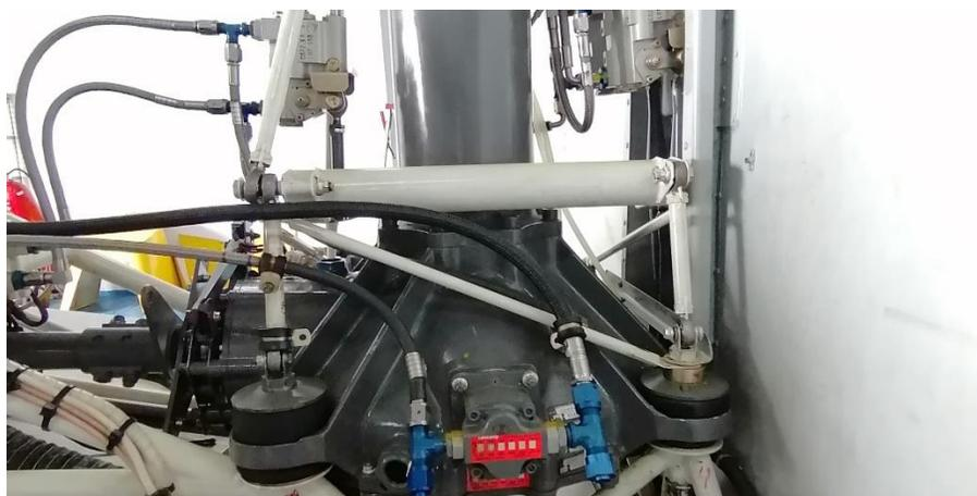
*Nota.* La figura muestra la inspección del conjunto del “Jackshaft” y el tubo Strut.
