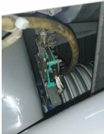
*Nota.* La figura muestra la inspección del interruptor del actuador con MASTER SWITCH en la posición ON.
