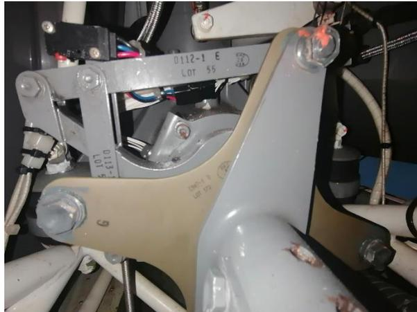
*Nota.* La figura muestra la inspección de los Yokes delanteros el de la MRGB y el del eje del Clutch.
