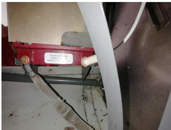
*Nota.* La figura muestra la inspección de las conexiones y condición de la batería.
