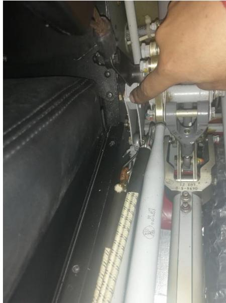
*Nota. La figura muestra la inspección del Rod End y del Tubo del Torsión de la Válvula de Corte del Combustible.*
