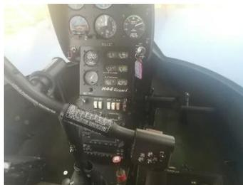
*Nota.* La figura muestra la bandeja de radios y áreas de los pedales del rotor de cola que van a ser inspeccionados.
