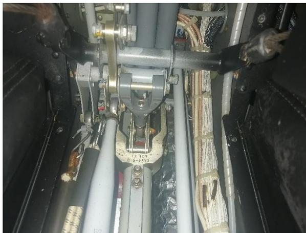
*Nota.* La figura muestra la inspección del conjunto del Yoke y el extremo posterior del tubo de torsión del cíclico.
