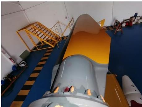
*Nota.* La figura muestra la inspección de toda la superficie de las palas del rotor principal según los procedimientos a continuación.
