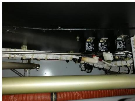
*Nota.* La figura muestra la inspección del cableado eléctrico en túnel delantero sección 3A.
