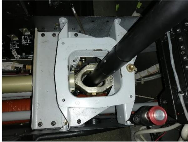
*Nota.* La figura muestra la inspección del conjunto de la caja del cíclico sin cobertor.
