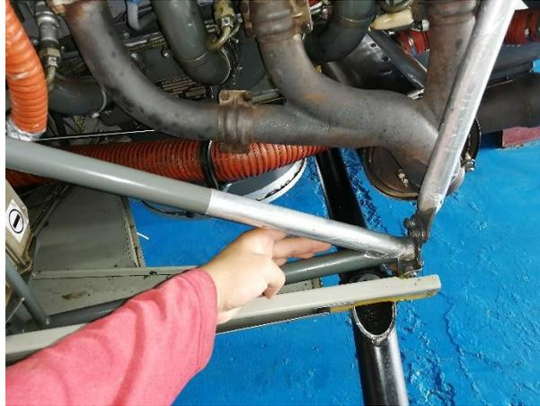
*Nota.* La figura muestra la inspección de los tubos de acero del marco inferior.
