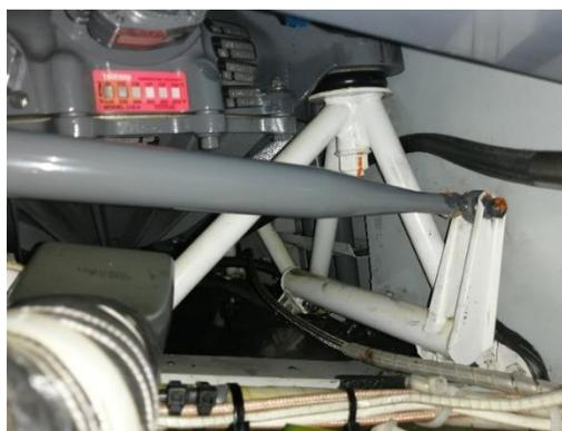
*Nota.* La figura muestra la inspección del tubo Push-Pull del rotor de cola y condición del bellcrank superior.
