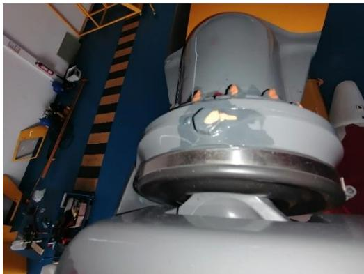
*Nota.* La figura muestra la inspección de las Botas de las palas del Rotor Principal.
