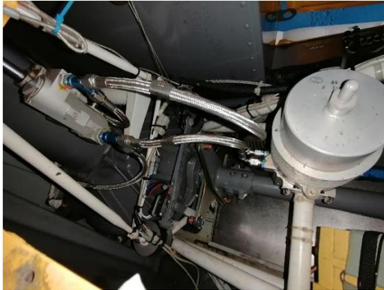
*Nota.* La figura muestra la inspección de la condición de los Fittings y líneas hidráulicas.
