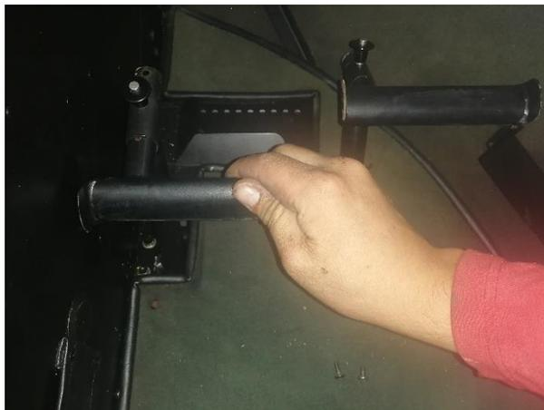
*Nota.* La figura muestra la sección donde se realiza la inspección a todo el conjunto de los pedales del Rotor de Cola.
