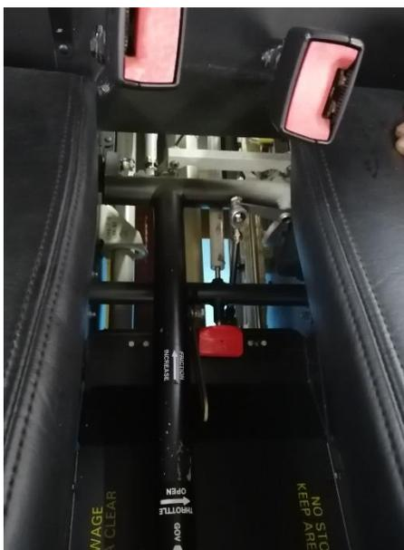
*Nota.* La figura muestra la inspección del tubo de torsión, Tubo Push-Pull, Anchor, Rod Ends y Cojinetes de la sección 3D
