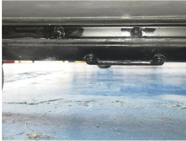
*Nota.* La figura muestra la inspección de los Skids del tren de aterrizaje.
