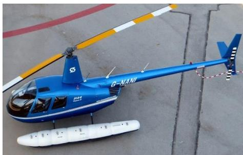
*Nota.* La figura muestra en tren de aterrizaje con flotadores de emergencia de la aeronave Robinson R44 Clipper I. Tomado de (Helitrastorno, 2013).
