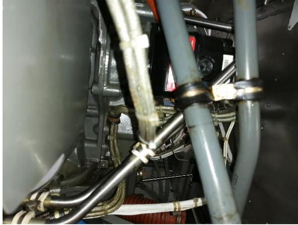
*Nota.* La figura muestra la inspección del sistema de combustible en busca de fugas.
