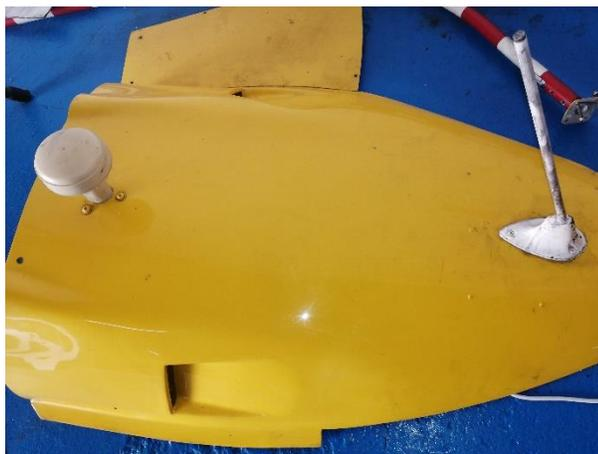
*Nota.* La figura muestra la inspección del Tailcone del Helicóptero.
