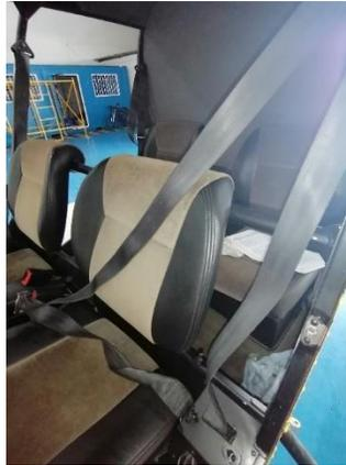
*Nota.* La figura muestra la inspección de la condición de los arneses, cinturón y correas de los asientos posteriores y delanteros.
