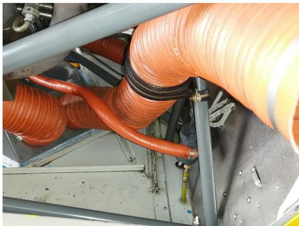
*Nota.* La figura muestra la inspección de la manguera de entrada de aire al motor
