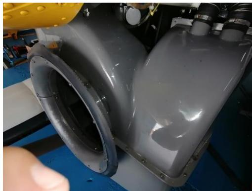
*Nota.* La figura muestra la inspección de toda la fibra de vidrio del Scroll y agujeros de drenaje.
