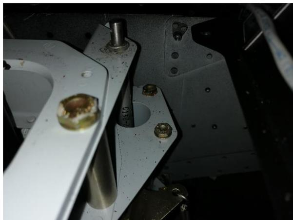
*Nota.* La figura muestra la inspección del espaciador C130-2 y Linkage que van a la palanca del cíclico.
