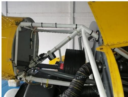
*Nota.* La figura muestra la inspección de los tubos de acero de la estructura superior.
