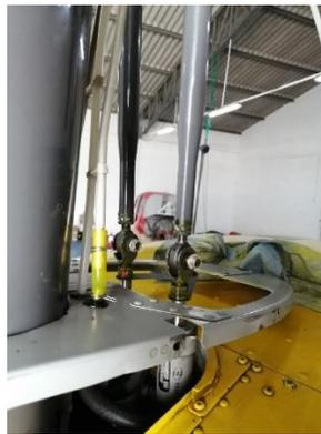
*Nota.* La figura muestra la inspección de los tubos Push-Pull verticales y los Rod Ends de los mismos.
