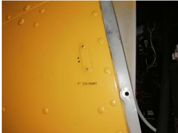
*Nota.* La figura muestra la inspección del puerto estático del lado izquierdo.
