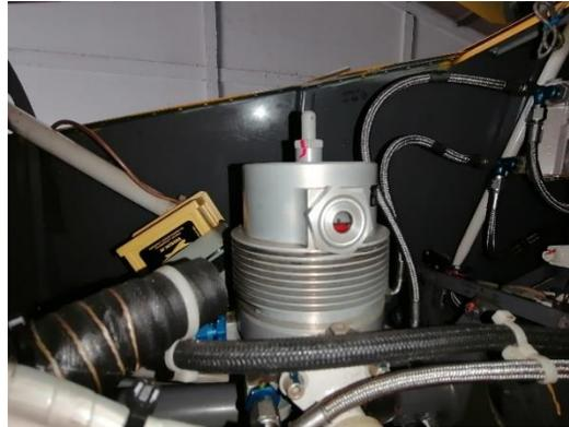
*Nota.* La figura muestra la inspección de la condición del reservorio | y nivel de aceite hidráulico.
