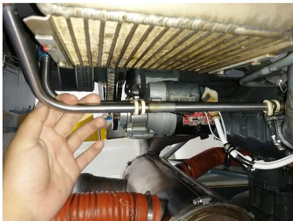
*Nota.* La figura muestra la inspección del conjunto del “Oil Cooler” y Líneas de aceite.
