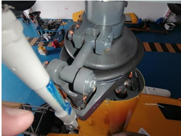
*Nota.* La figura muestra la inspección de las tijeras superiores del Swashplate, Rod Ends y cojinete esférico.
