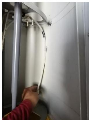
*Nota.* La figura muestra la inspección de la ventilación de los tanques de combustible y la línea del tubo Pitot.
