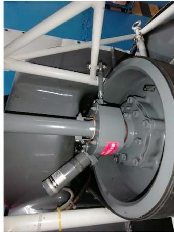
*Nota.* La figura muestra la inspección del conjunto de embrague, drive Shaft y sellos de las poleas.
