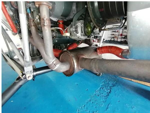
*Nota.* La figura muestra la inspección del sistema de escape y área del tubo de escape.
