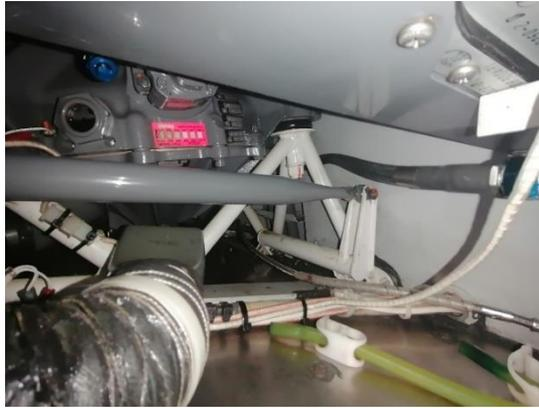
*Nota.* La figura muestra la inspección del Telatemp, montajes, mástil y medidor de aceite de la MRGB.
