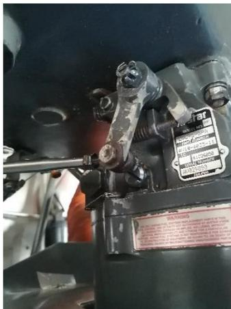
*Nota.* La figura muestra la inspección del control de la mezcla, tubo Push-Pull, Rod Ends y resorte del control.
