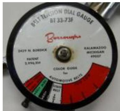
*Nota.* La figura muestra la herramienta especial de Robinson (ST-131) para medir la tensión de la banda del alternador.
