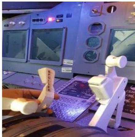
*Nota.* Esta imagen indica la activación del freno de velocidad cuando está fuera de la posición abajo.
