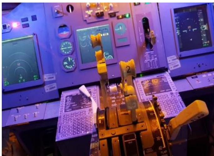
*Nota.* Los flaps cuando están fuera del rango de despegue alertan mediante la luz roja a la tripulación de que existe una mala configuración en la aeronave
