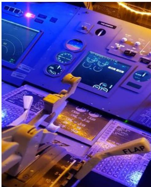
*Nota.* Esta imagen indica que, en la posición de 0 grados, la luz de alerta de despegue no es la adecuada para el procedimiento de despegue.
