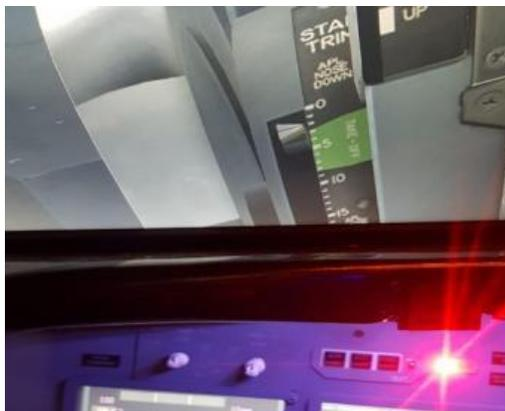
*Nota.* Esta imagen muestra la verificación del stab trim en dirección APL NOSE DOWN, colocando una de las potencias hacia adelante.
