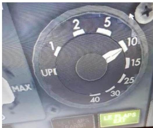
*Nota.* Esta imagen representa el acoplamiento de los flaps dentro del rango entre 1 y 25 grados permitidos para despegue de la aeronave.
