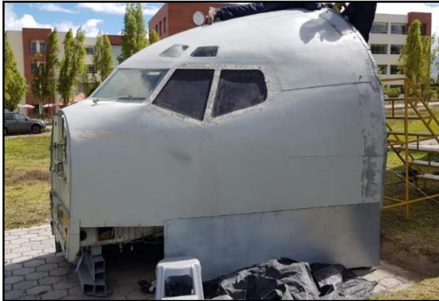
Después de realizar los acoplamientos adicionales en la cabina, se hizo una tarea de masillado, cuya finalidad era, darle un mejor acabado y no presente deformaciones en las uniones hechas en la cabina y ocultando toda deformidad que contiene la estructura.
