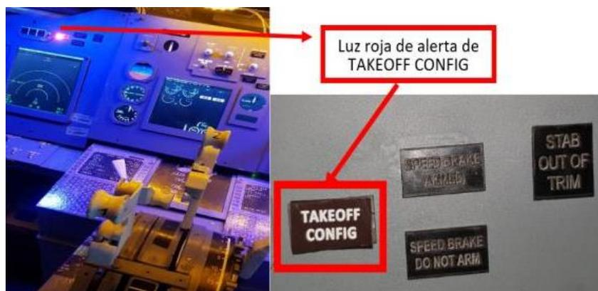
*Nota.* El encendido de la luz roja de Take off, representa el correcto funcionamiento de la palanca de potencia nro2.
