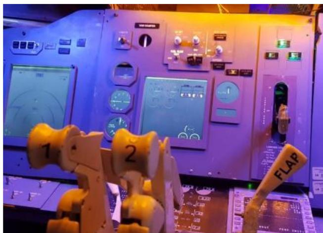
*Nota.* Esta imagen indica la posición de 0 grados de los flaps y las palancas de potencia en reposo, el cual la luz roja no está encendida.
