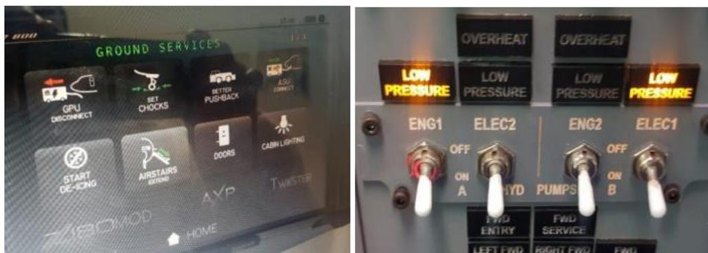
*Nota.* Esta imagen indica la conexión del GPU y del sistema hidráulico, suministrando energía eléctrica y fuerza hidráulica en la aeronave.
