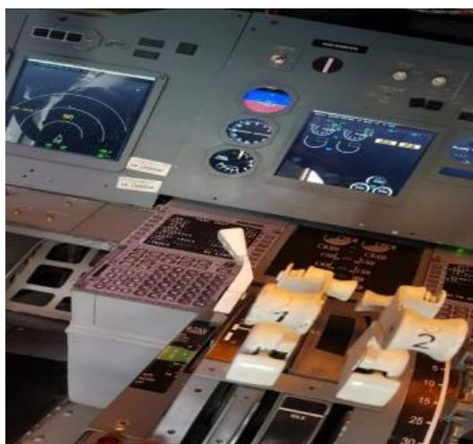
*Nota.* En este paso da a conocer la prueba exitosa en la comprobación del funcionamiento de la palanca de potencia nro2 con la luz roja de Take off apagada.
