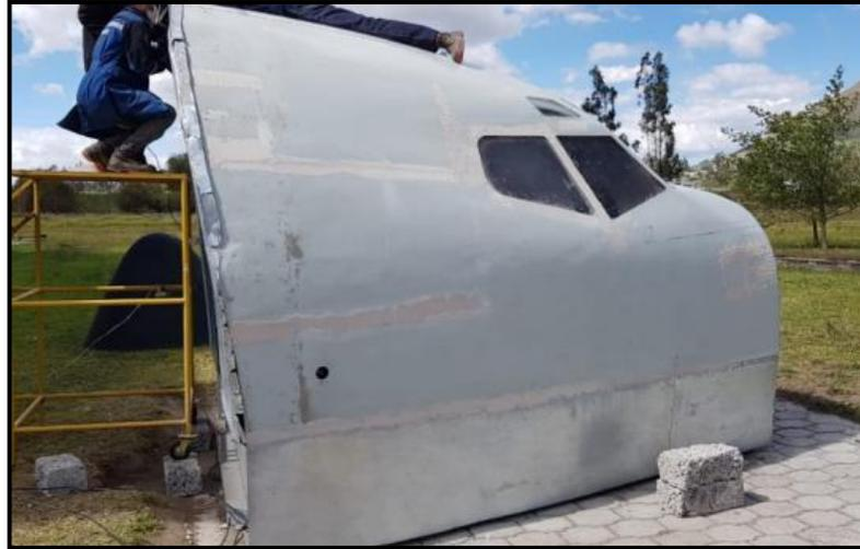
Luego de haber realizado la tarea de masillado en toda la cabina, se procedió a lijar toda la cabina, dar tratamiento anticorrosivo a las láminas acopladas y dar una limpieza fondo, eliminando de esta forma todo polvo, impureza que pueda alterar cualquier proceso de pintado y verificando el trabajo bien hecho. Después de limpiar la cabina se ejecutó la elaboración de las respectivas mezclas en donde contenía como elemento principal el Primer.
