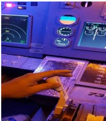
*Nota.* La imagen indica que durante todo el trayecto hasta la posición armado y regresando a la posición abajo, la luz de alerta de despegue roja permanece encendida hasta llegar a su posición Abajo.
