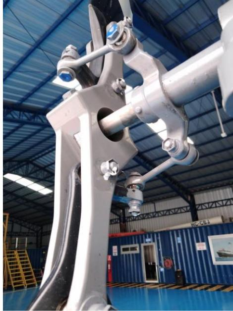
*Nota:* Cabeza del rotor de cola de helicóptero Robinson R44
