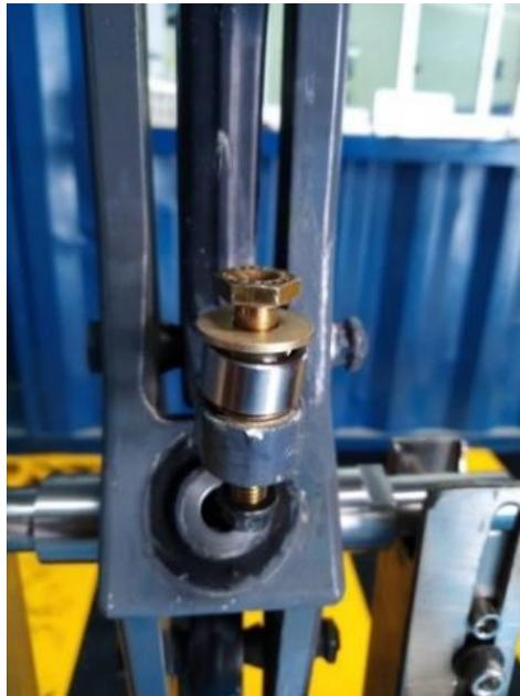
*Nota:* Montaje de perno y arandelas en cuerda
