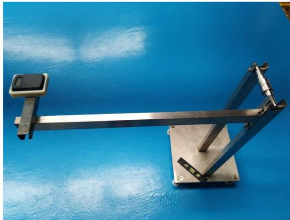
*Nota:* Stand de balance estático con nivel tipo burbuja y balanza en gramos
