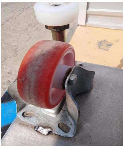
*Nota:* Se muestra representación de la junta de las ruedas a la plataforma de monel del stand de balance estático
