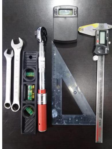
*Nota:* Herramientas necesarias para ejecutar un balance estático en conjunto rotor de cola del helicóptero Robinson R44
