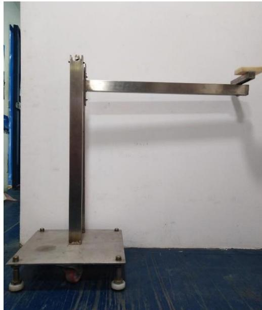
*Nota:* Modelo de stand de balance estático para hélices de helicópteros Robinson.
