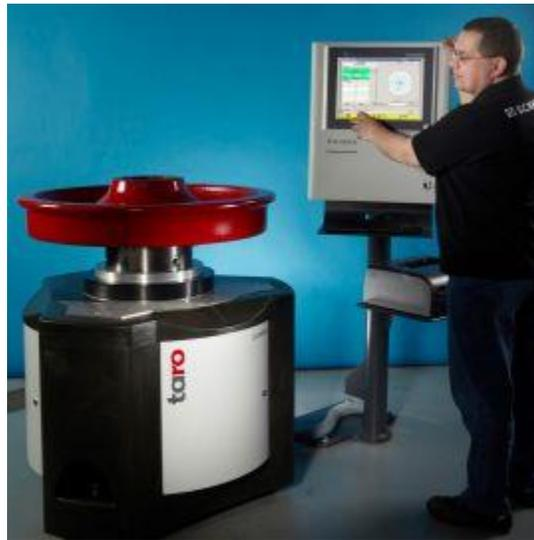
*Nota:* Equipo para realizar balanceo estático con conexión eléctrica. Recuperado de:
