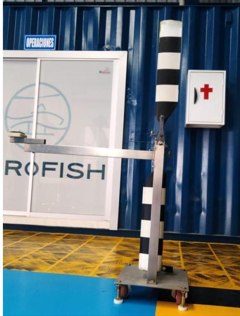
*Nota:* Posición del conjunto rotor de cola insertado en el stand de balance estático
