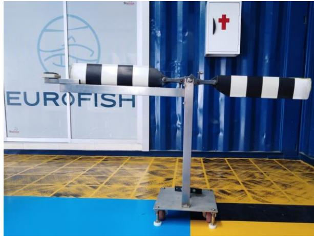
*Nota:* Conjunto rotor de cola posicionado en movimiento de cabeza para balance estático
