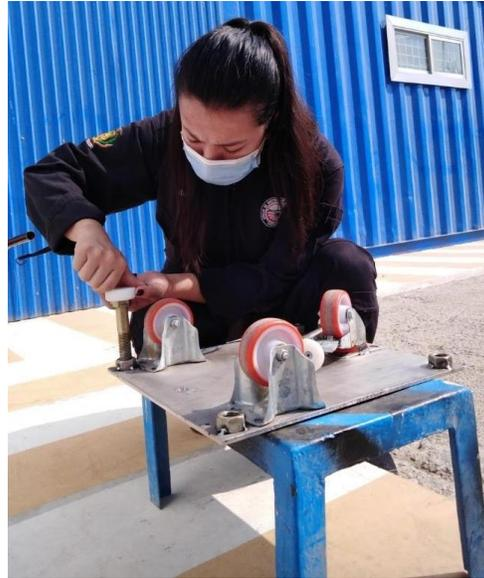
*Nota:* Muestra de la ubicación de los pernos de ajuste en la plataforma del stand de balance
