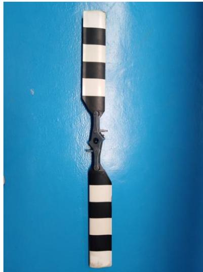
*Nota:* Conjunto rotor de cola preparado para ser insertado en el stand de balance
