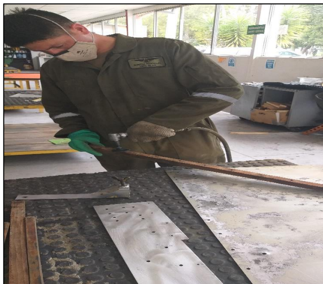
Limpieza de las partes de la herramienta
