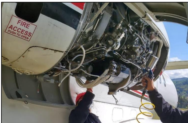
Limpieza del motor
