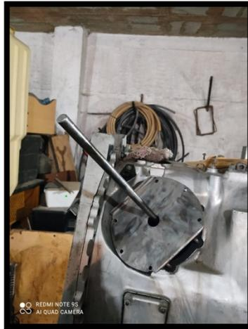
*Nota.* El eje de transmisión debe estar completamente recto ya que si tiene un pequeño imperfecto podría causar vibraciones y dañar el motor eléctrico.
