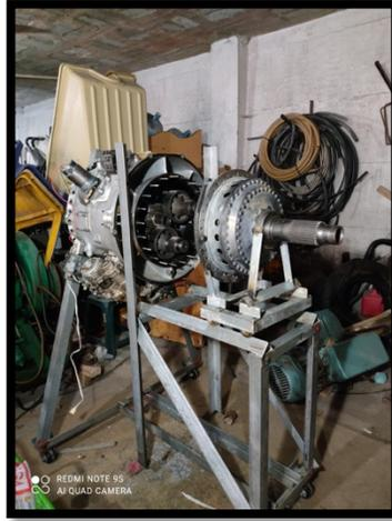
*Nota.* La maqueta cumple la función de demostrar mediante el accionamiento de un motor eléctrico de bajas RPM, como se transmite el movimiento desde el motor de arranque hacia el eje principal y hacia la hélice.
