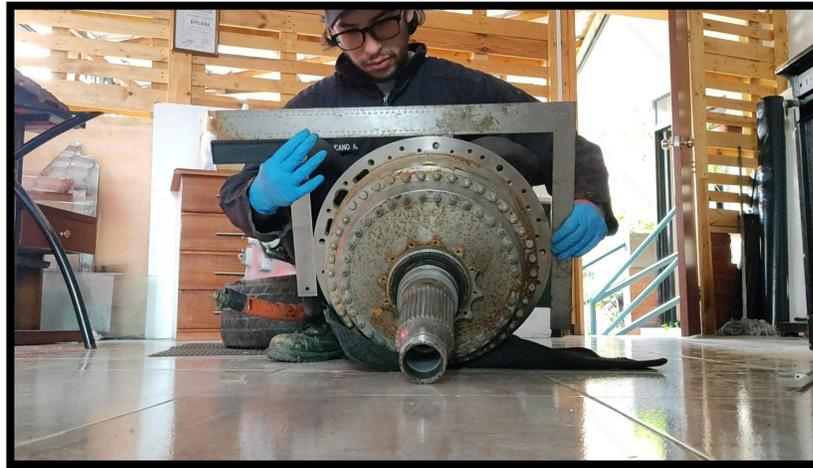
*Nota.* Se tomo las medidas en tres dimensiones incluyendo algunos agujeros y componentes rotativos para diseñar una estructura que soporte el peso de los componentes.
