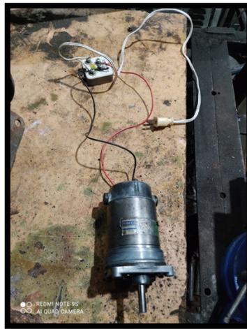
*Nota.* Se incluyo en el circuito un rectificador de onda completa ya que el motor funciona con 110v de corriente directa y de esta manera podemos conectar el motor a la corriente alterna de la red domestica.
