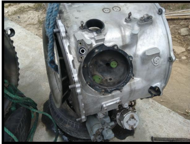
*Nota.* El agujero por donde atraviesan los ejes desde el motor eléctrico y transmiten el movimiento para accionar la caja cónica, se encuentran libres de obstrucción y FOD.
