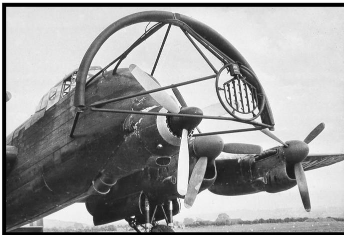
*Nota.* Esta aeronave posee el Dart instalado en el morro junto con una rejilla que rociaba agua para las pruebas de protección contra hielo y lluvia.
