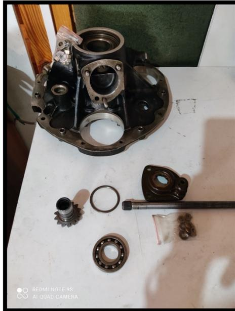
*Nota.* La remoción del engranaje cónico del sistema de arranque, se realizó satisfactoriamente empleando un Manual de Overhaul del Rolls Royce Dart como guía.
