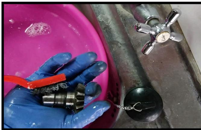
*Nota.* El cepillo que empleemos para esta tarea no debe ser duro y lastimar el material del componente, pero debe remover las impurezas y oxido sobre este.
