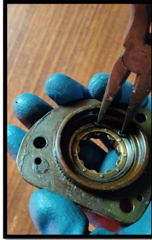
*Nota.* Para extraer un Circlip sin causar daños en el o el componentes debemos usar pinzas adecuadas para extraer arandelas de seguridad.
