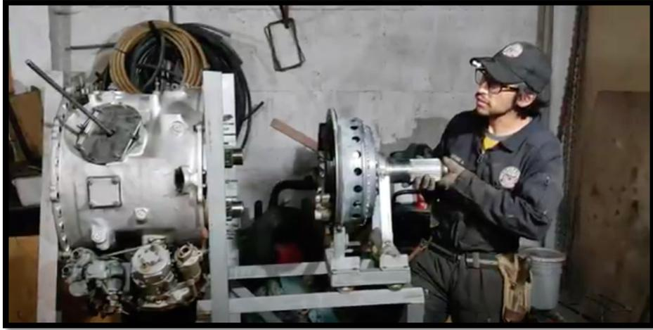
*Nota.* Al momento de acoplar el conjunto de la hélice con la carcasa de la toma de aire debemos hacerlo girando el eje de la hélice en sentido anti horario.
