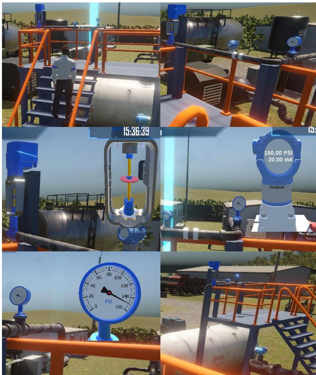
El tanque de separador bifásico es el que mayor instrumentación posee, se tiene transmisores de presión, indicadores de presión, válvulas de control, válvulas tipo manija y válvula tipo globo con animaciones de apertura y cierre de las mismas.
