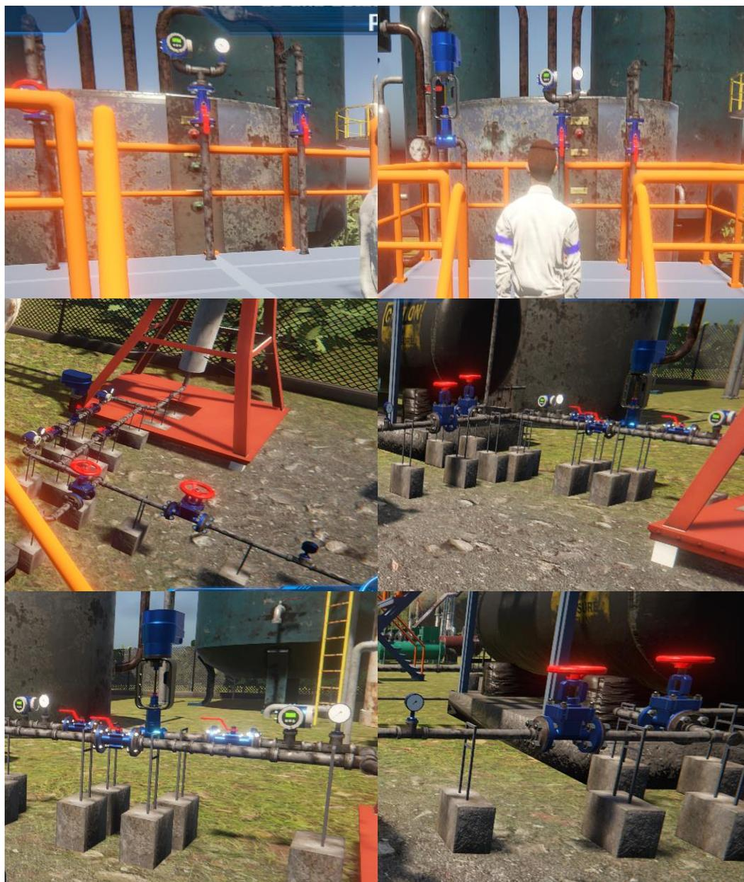
Las animaciones en la parte superior del Separador Bifásico del indicador de presión, transmisor de presión y válvula, se las realiza mediante apertura de la válvula y se visualiza conforme se va cerrando la válvula al cambio de presión, sin afectar al proceso.
