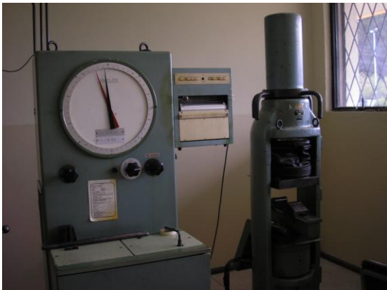
Imagen 4.63 Maquina de Ensayos Universales RM 29
