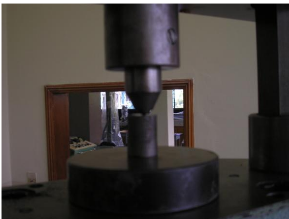
Imagen 4.51 Indentación de Muestras Imagen 4.52 Probeta con Indentación
