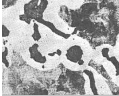
Figura 2.11 Grafito Vermicular mostrando algunos nódulos irregulares en la matriz perlítica-ferrítica, x 250 perfilada con nital .
