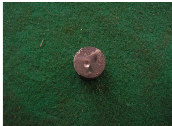
Imagen 4.51 Indentación de Muestras Imagen 4.52 Probeta con Indentación
