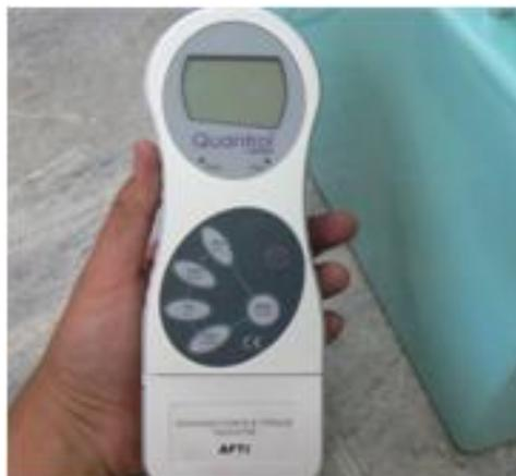
**Figura 2.28. Display AFTI para la celda de carga tipo “S”.**
