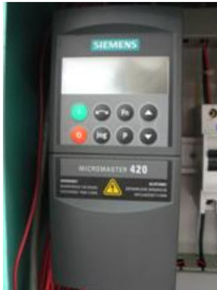
**Figura 2.21. Variador de velocidad de la máquina MTS TK/T5002.**
