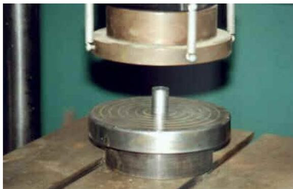
**Figura 2.6 Ensayo de compresión.**
