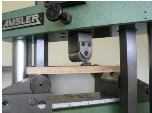
**Figura 6.4. Ensayo de flexión de madera en la máquina AMSLER RM-09.**
