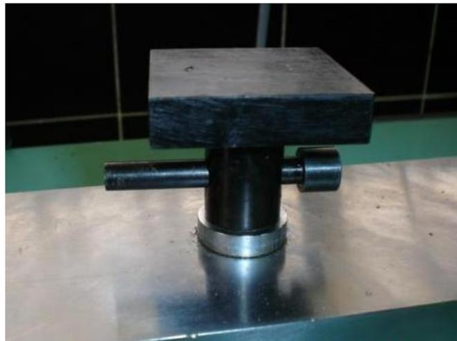
**Figura 4.25. Montaje del accesorio inferior de dureza en la máquina MTS TK/T5002.**
