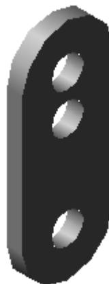
**Figura 3.21. Esquema de placas de sujeción del accesorio superior de flexión.**
