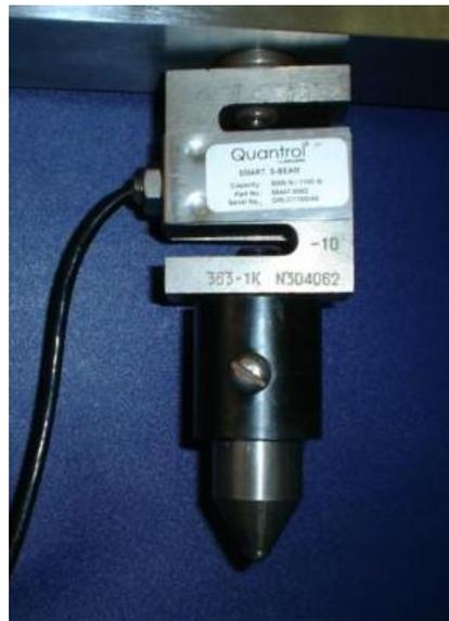
**Figura 4.23. Montaje del accesorio superior de dureza en la máquina MTS TK/T5002.**
