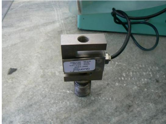
**Figura 3.13. Unión roscada de la celda de carga tipo "S"**
