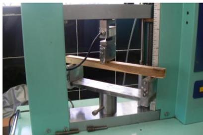
**Figura 6.1 Ensayo de flexión de madera en la máquina MTS TK/T5002.**
