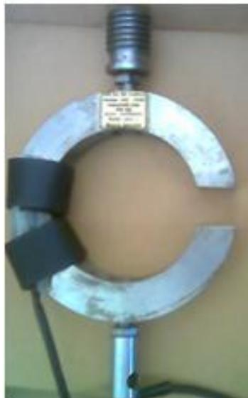
**Figura 2.16. Celda de carga tipo “C”.**
