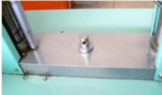
**Figura 3.11. Elemento de acople de accesorios en el cabezal fijo.**
