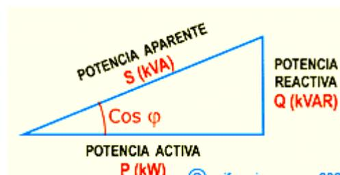
**Figura 2.23. Triángulo de potencias.**
