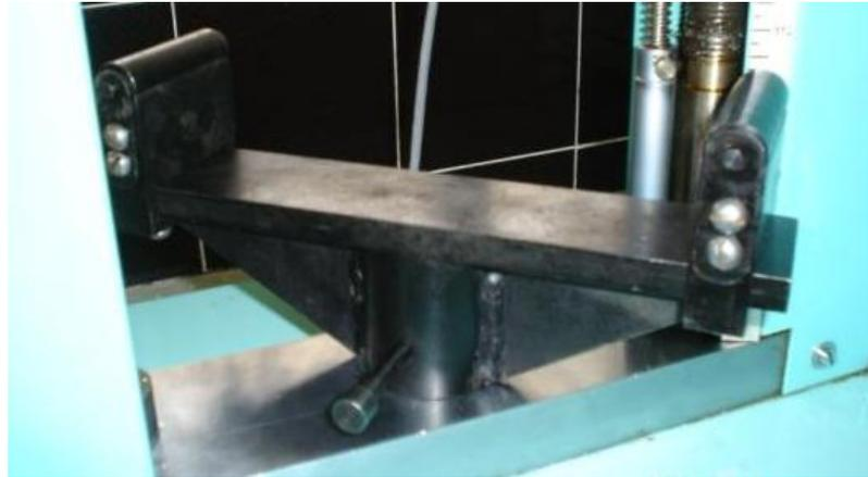
**Figura 4.21. Montaje del accesorio inferior de flexión en la máquina MTS TK/T5002.**
