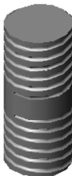
**Figura 3.23. Esquema del tornillo de sujeción del accesorio superior de flexión.**
