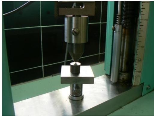
**Figura 6.3. Ensayo de dureza en hierro fundido en la máquina MTS TK/T5002.**
