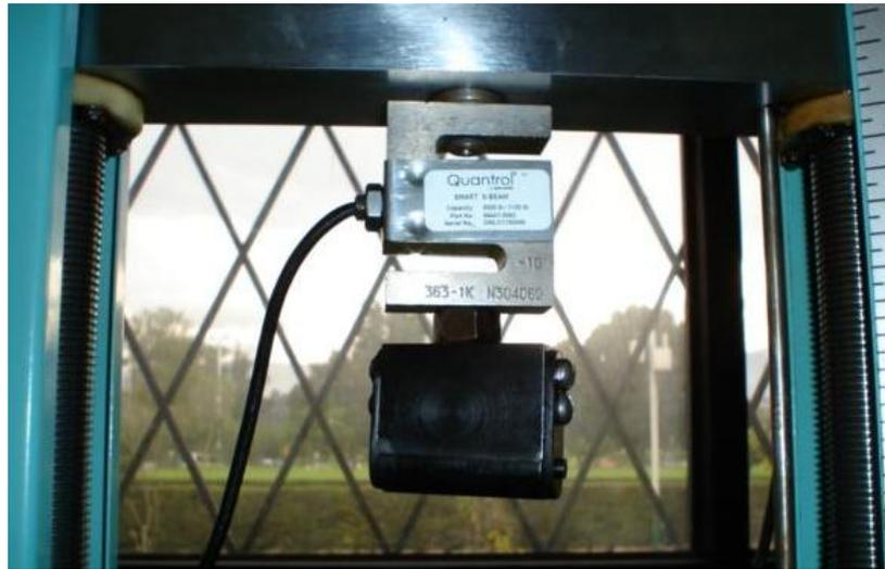
**Figura 4.19. Montaje del accesorio superior de flexión en la máquina MTS TK/T5002.**
