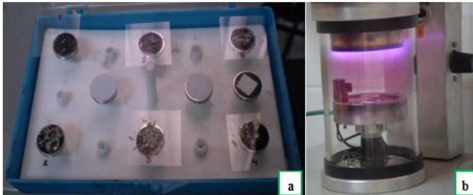
**Figura 2.6.** Recubrimiento de las muestras con (a) carbono adhesivo y con oro (b).
