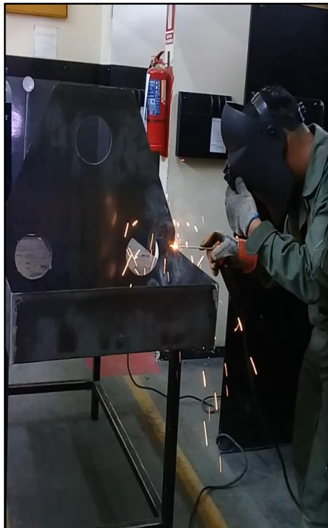
Figura 31 Base de los manómetros
