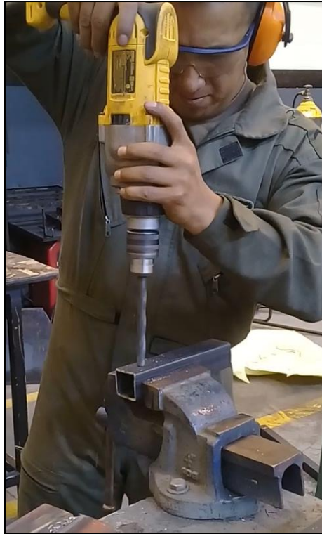
Figura 51 Perforado del Soporte
