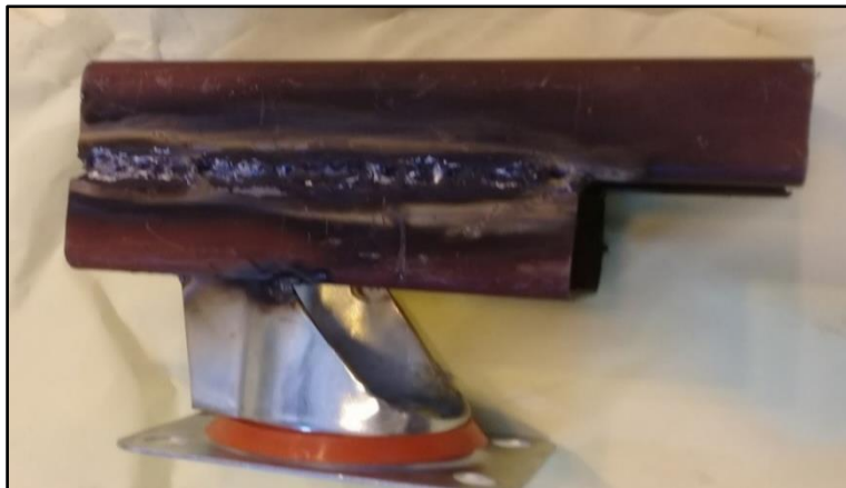
Figura 25 Suelda de la base del cojinete
