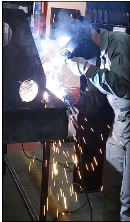
Figura 49 Suelda de la Base
