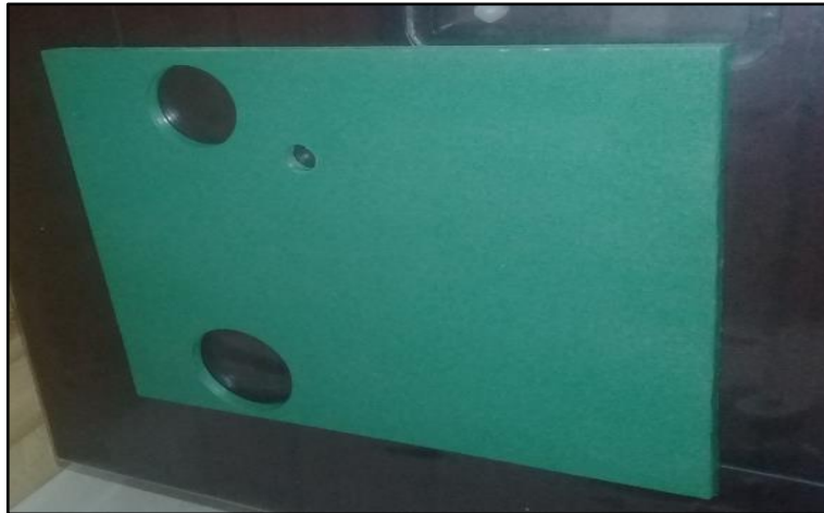
Figura 61 Base de manómetros
