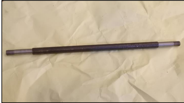
Figura 53 Eje Macizo de las ruedas posteriores.
