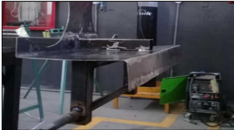
Figura 54 Suelda del eje con el soporte de las ruedas
