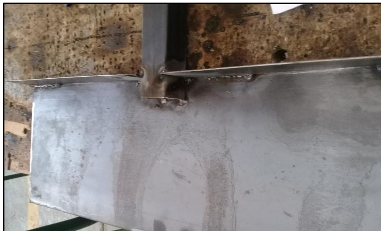
Figura 47 Suelda del eje con la Base Posterior.
