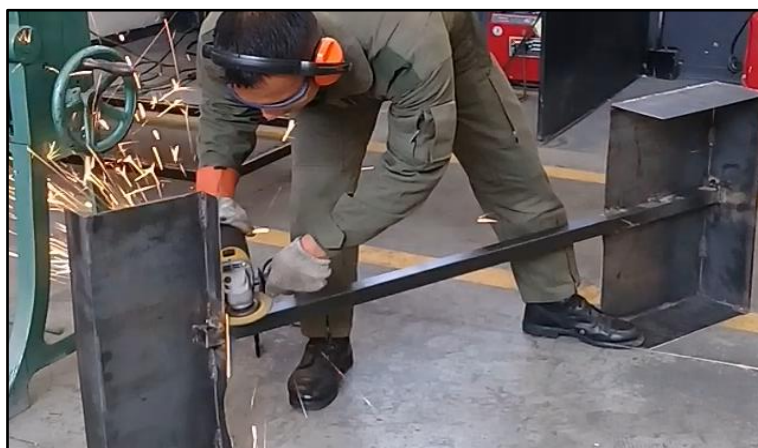
Figura 48 Pulida de las rebabas con la amoladora
