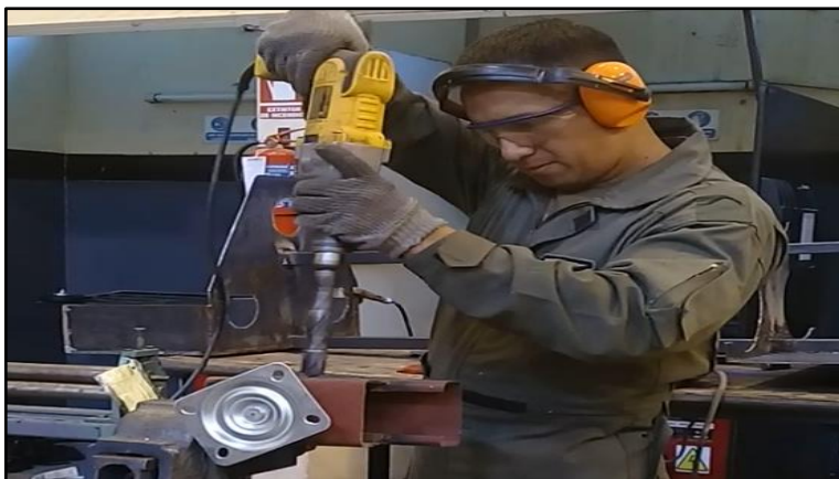
Figura 26 Perforación de la base de dirección
