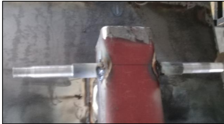
Figura 27 Suelda del eje de las llantas delanteras
