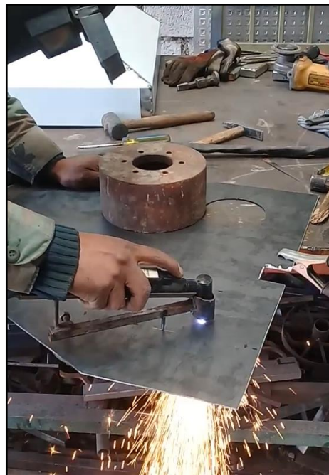
Figura 30 Corte con el plasma
