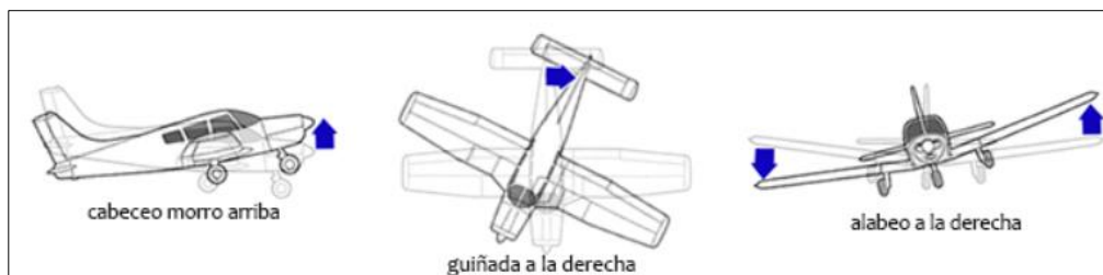
Figura 11. Movimiento del avión en sus ejes Fuente: (Muñoz, 2019)
