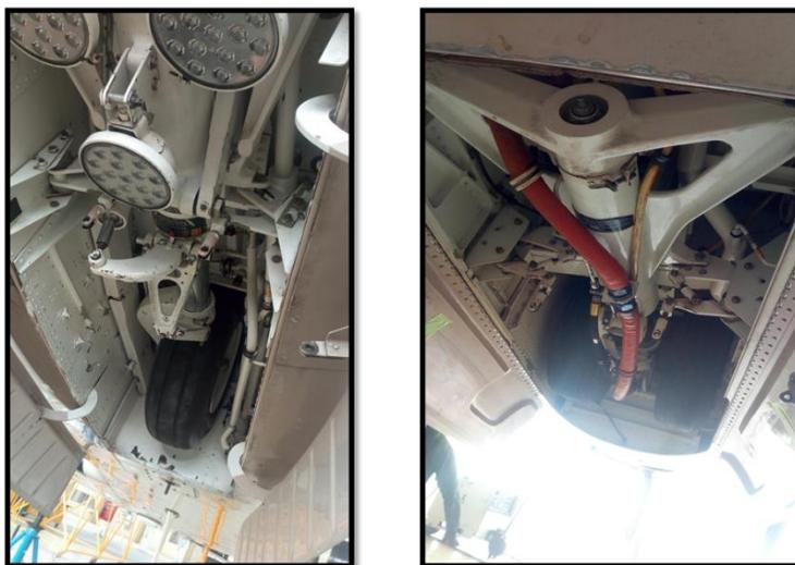
**Figura 89.** Retracción del tren.
