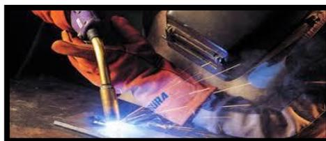
**Figura 23.** Soldadura MIG.
