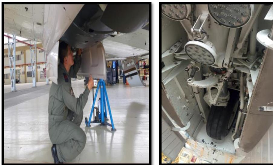
**Figura 82.** Chequeo visual del tren asegurado en los compartimentos de los trenes.
