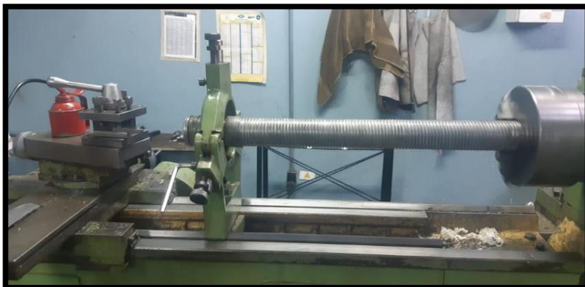
**Figura41.** Rectificación de anillos del tubo tipo tornillo de gatos hidráulicos.
