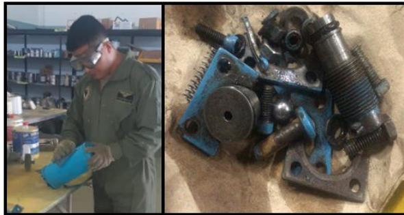
**Figura 40.** Lavado de reservorios de hidráulico y componentes de armado.
