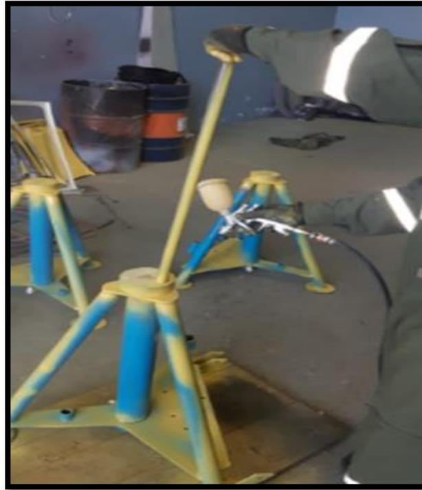
**Figura 61.** Aplicación de primer en palancas de fuerza.
