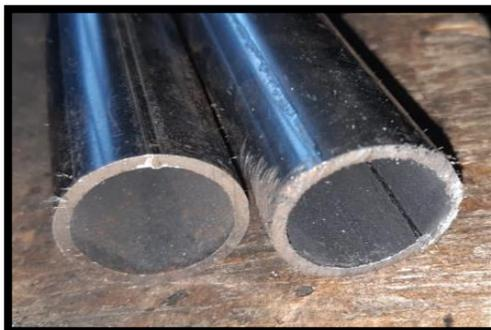
**Figura 56.** Primer acabado después del corte.
