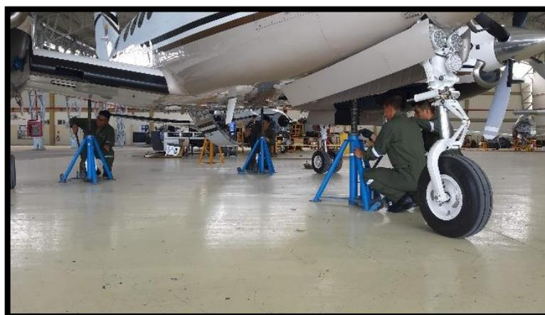
**Figura 75.** Colocando los gatos hidráulicos en los puntos de para acople.
