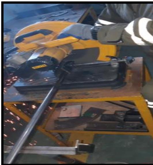
**Figura 55.** Cortando tubo de 1in x2mm en un largo de 1m.
