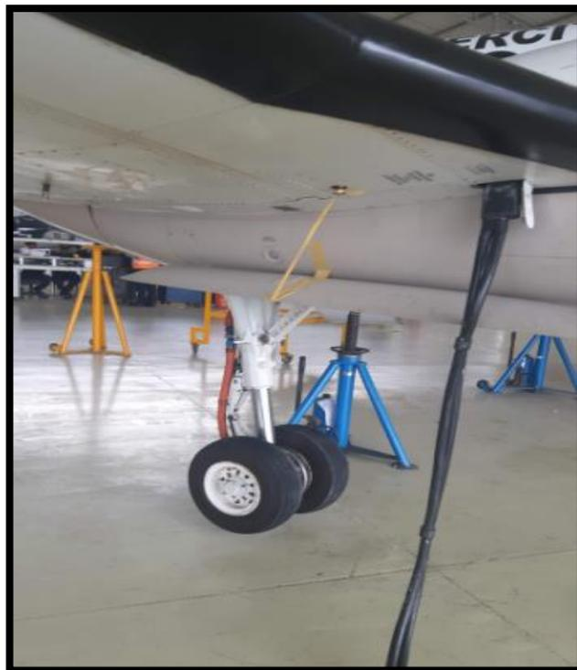
**Figura 79.** Puerto de conexión para planta externa.
