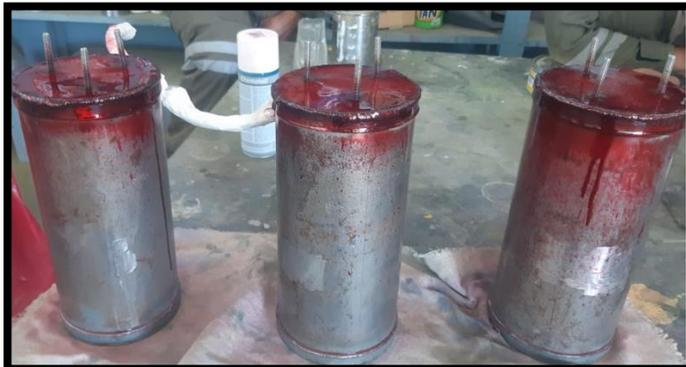
**Figura 48.** Aplicación de líquido penetrante a reservorios de hidráulico.
