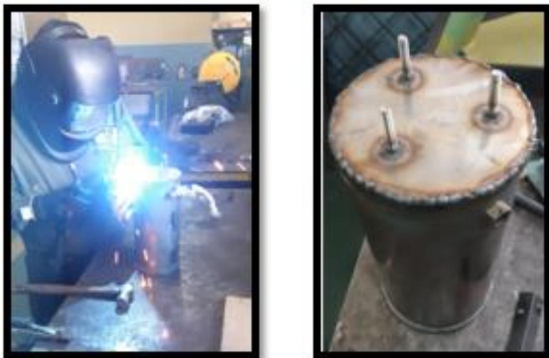
**Figura 47.** Soldadura de base de reservorios de hidráulico.
