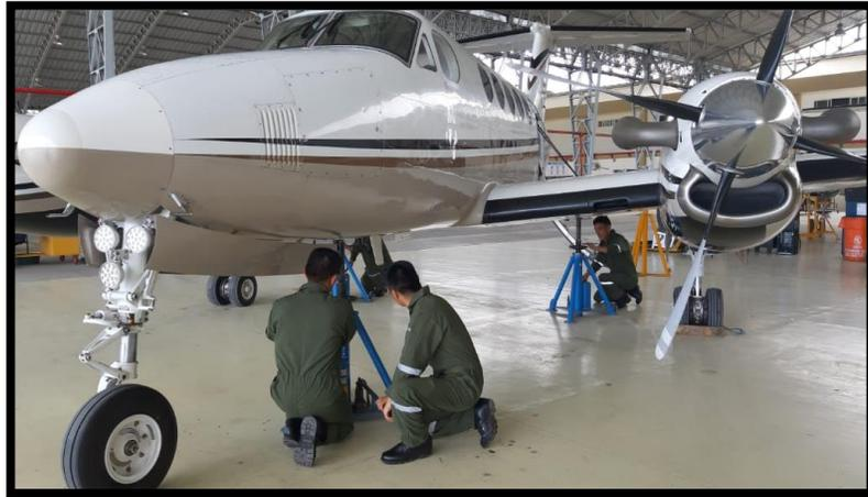
**Figura 78.** Proceso de descenso de la aeronave.
