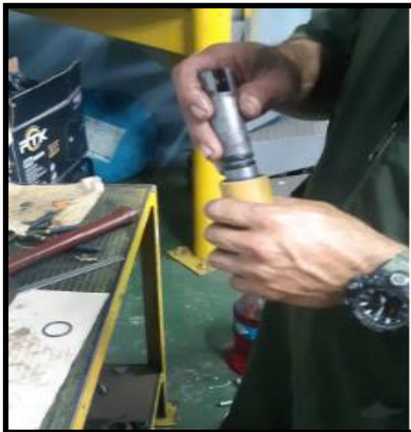
**Figura 65.** Unión de embolo interior y exterior de bomba de hidráulico.
