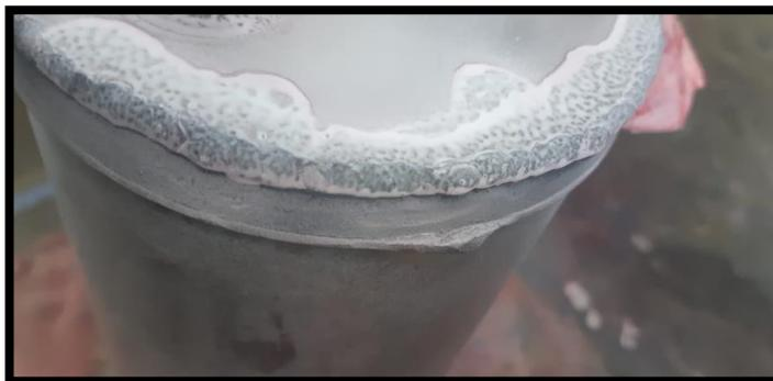
**Figura 49.** Aplicación de revelador a reservorios de hidráulico.
