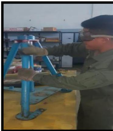
**Figura 53.** Lijado de los gatos hidráulicos.
