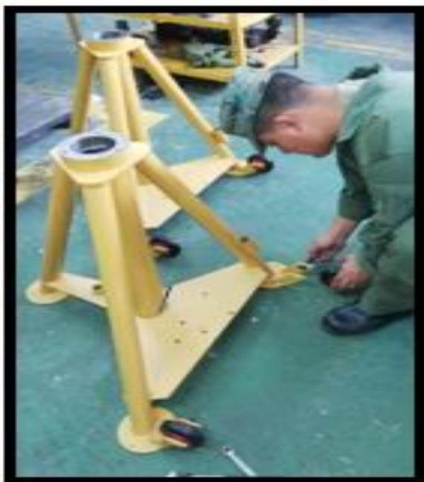
**Figura 66.** Colocación de llantas.
