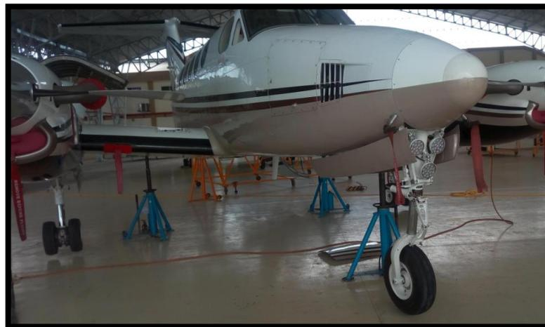
**Figura 77.** Proceso de levantamiento de la aeronave.
