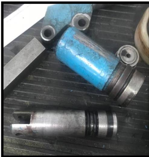
**Figura32.** Embolo exterior/interior de la Bomba de Hidráulicos empaques en mal estado
