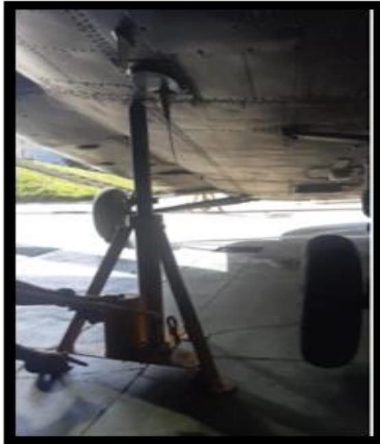
**Figura 69.** Prueba realizada para comprobar presión y funcionamiento de los gatos hidráulicos.
