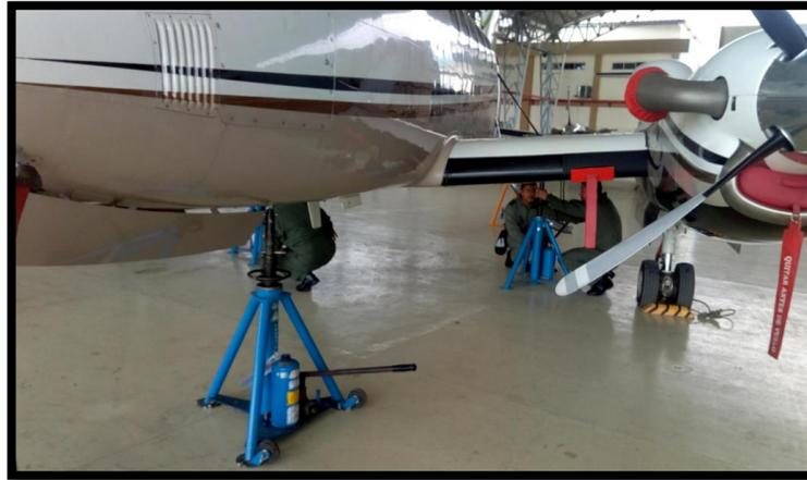
**Figura 76.** Colocando los gatos hidráulicos en los puntos de apoyo para levantamiento.
