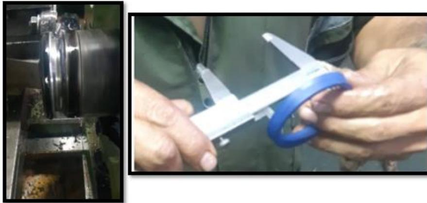
**Figura 42.** Rectificación de cavidad para empaque de presión hidráulica.
