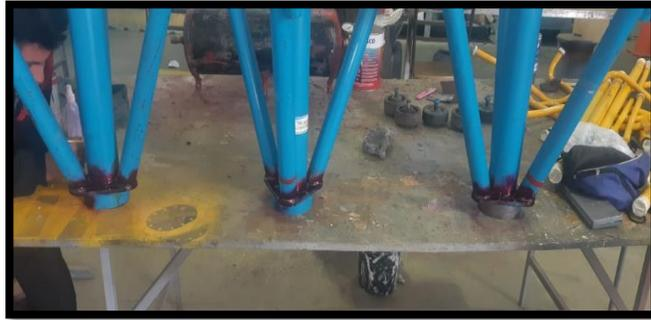
**Figura 51.** Aplicación de líquidos penetrantes.
