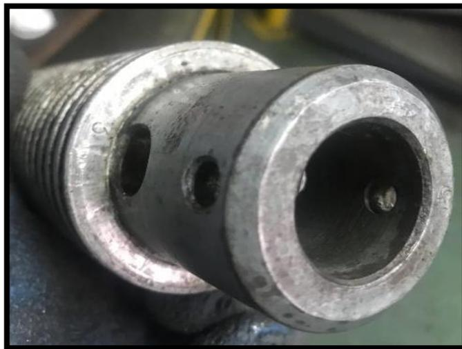
**Figura 34.** Tubo tipo tornillo y tubo de extensión de altura.
