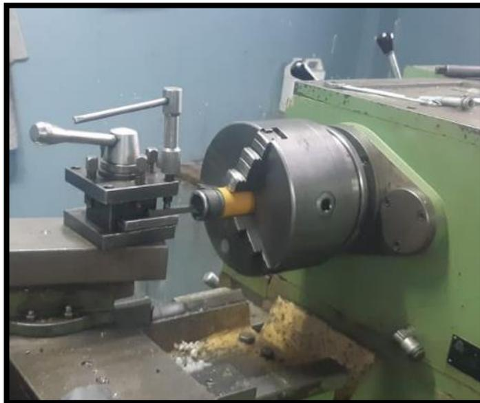
**Figura 43.** Rectificación de embolo principal de bomba de gatos hidráulicos.
