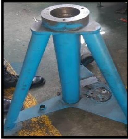
**Figura29.** Estructura principal de Gatos hidráulicos.
