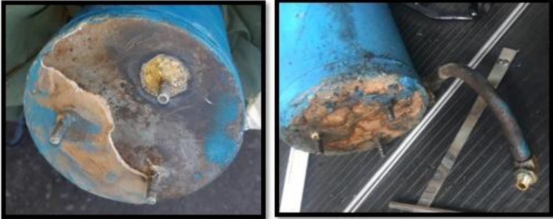
**Figura 44.** Base de reservorios de hidráulico corroída.
