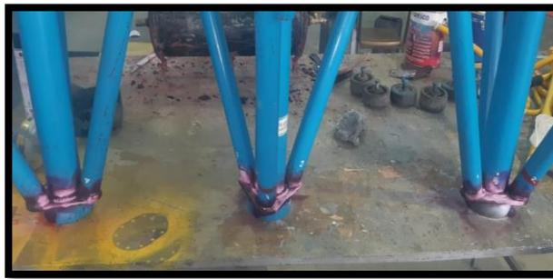
**Figura 52.** Aplicación de revelador en las uniones de los gatos hidráulicos.
