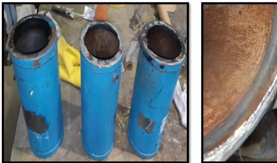
**Figura 46.** Lavado de interior de los Reservorios de hidráulico.
