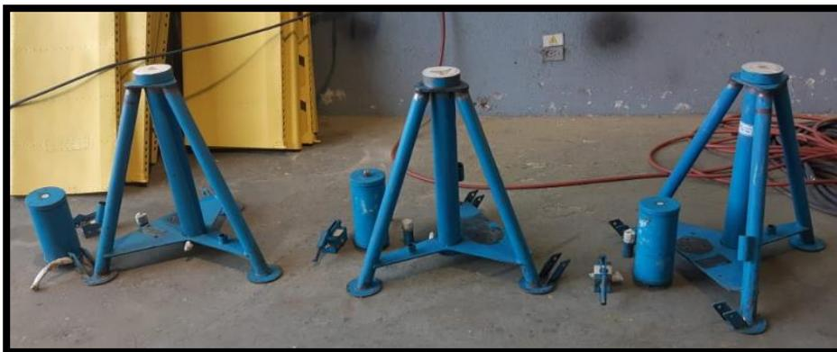
**Figura 58.** Empapelado de gatos hidráulicos.
