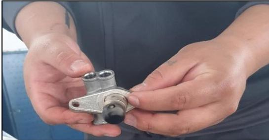
Colocación del inyector en la boquilla.
