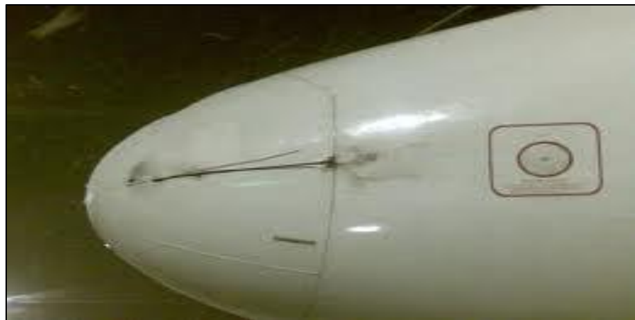
Figura 15 Daños de un rayo
