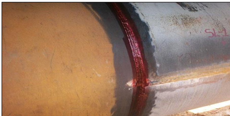
Figura 40 Aplicación del líquido penetrante.
