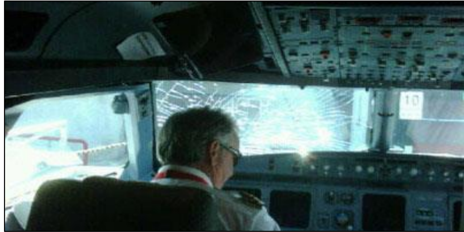
Figura 16 Detalle del cristal craqueado
