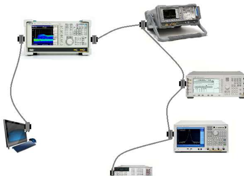
Figura. 2.10. Combinación de equipos lineales y bus 16
