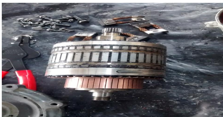
Figura 16 Inspección del Rotor del starter
