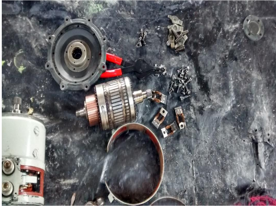
Figura 22 Limpieza rotor, banda y tapa de la carcasa del starter
