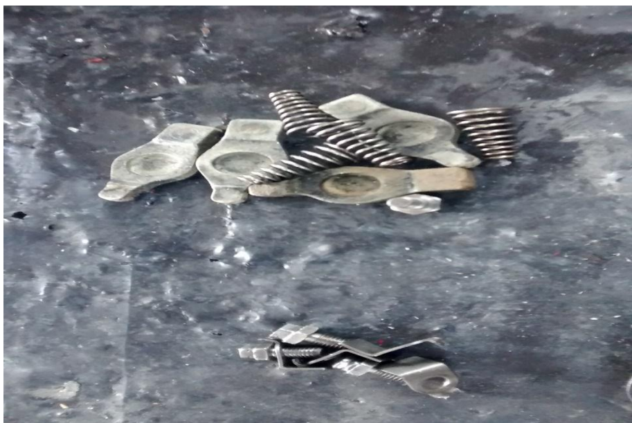
Figura 20 Verificación del estado de los resortes y asientos de escobillas
