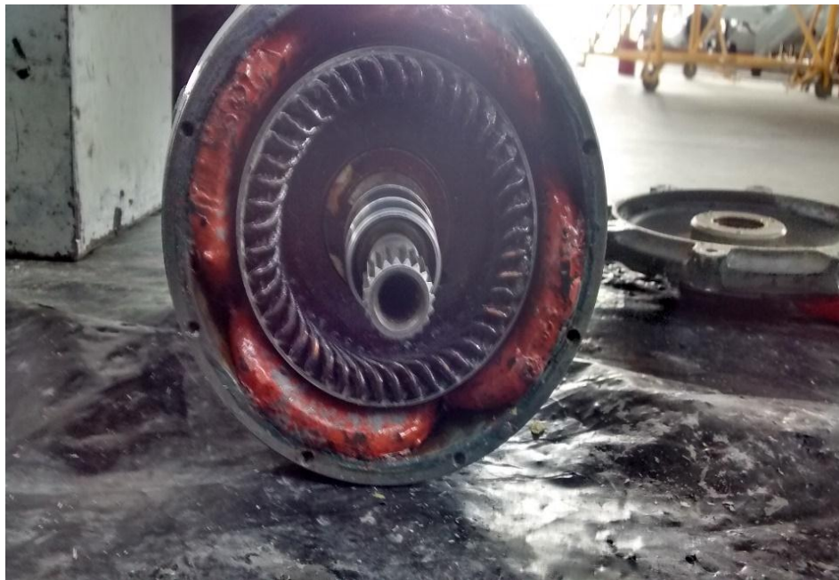
Figura 23 Inspección visual y limpieza del estator, béndix y eje del starter
