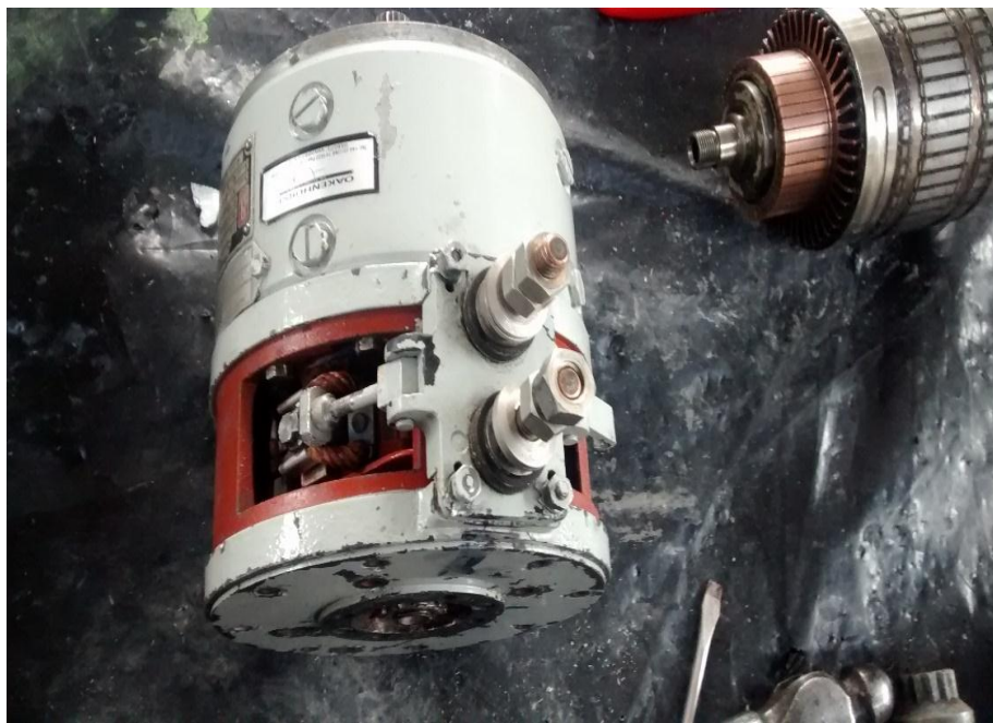
Figura 17 Verificación polos de conexión starter
