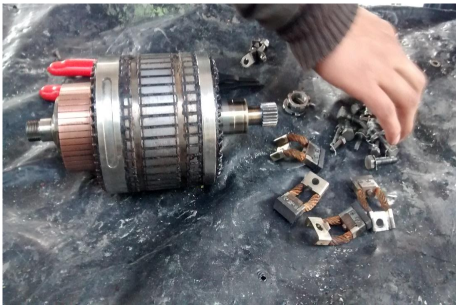
Figura 21 Medida de escobillas 0.800 in
