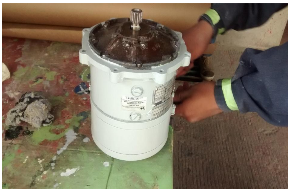
Figura 25 Proceso de pintado del starter
