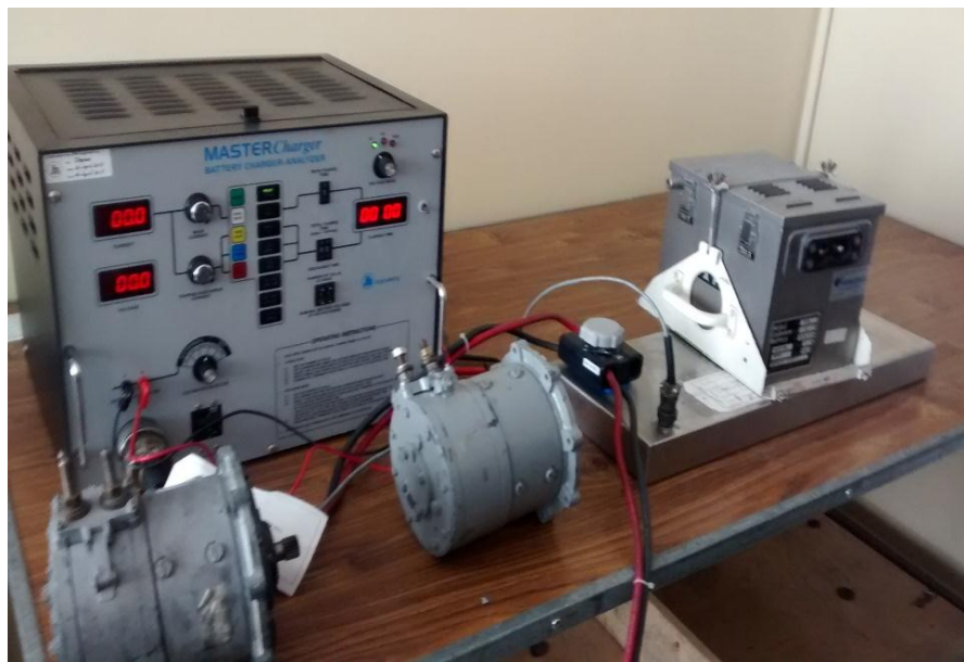
Figura 15 Chequeo funcional del starter
