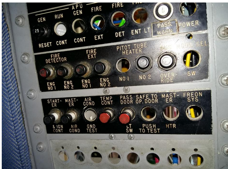
Figura 36 Circuit breaker starter panel eléctrico N° 2
