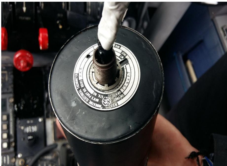
Figura 34 Conexión terminales del indicador tacómetro
