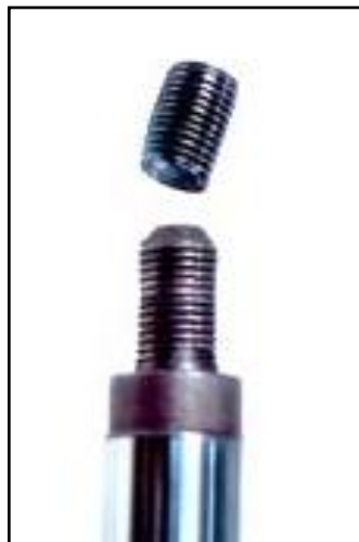
Figura 1.27. Rotura de espigas de anclajes.
