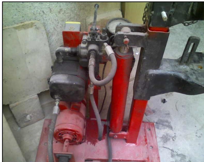
Figura 4.13 Instalación de conexiones del sistema.
