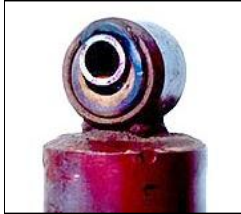
Figura 1.24. Tope de compresión averiado.
