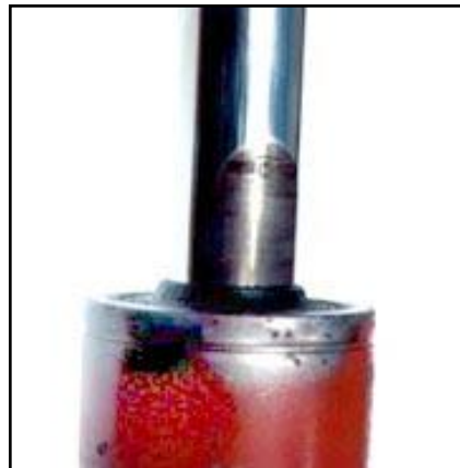
Figura 1.21. Capa cromada del vástago desgastada por roce.
