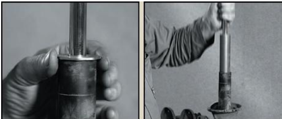
Figura 1.36. Desarme del amortiguador.
