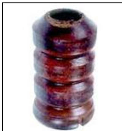
Figura 1.23. Tope de compresión averiado.
