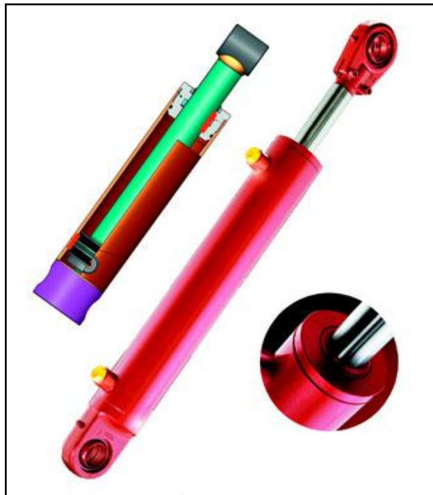
Fig. 3.2 Cilindro hidráulico de doble efecto.
