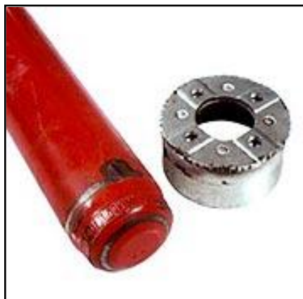
Figura 1.25. Cápsulas: montaje inadecuado.
