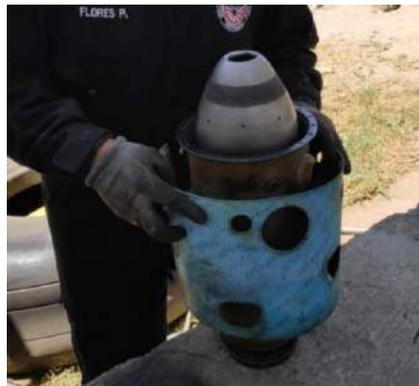
**A.4. remoción tubo de llama.** Una vez removido los componentes anteriormente mencionados, se procedió a realizar la remoción del tubo de llama de la cámara de combustión.
