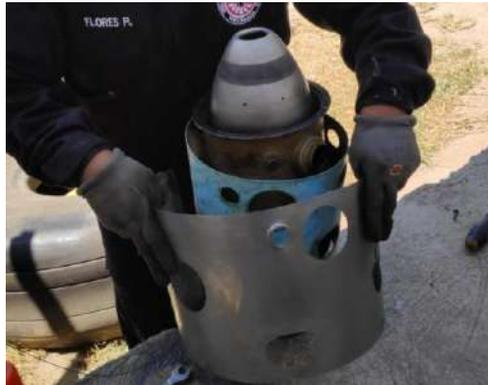
**A.3. Remoción del empaque de tira anti calor.** Para proceder a remover este componente, fue necesario remover la correa anti - desgarr, de tal manera que este empaque quede totalmente libre, y pueda ser removido del cárter de aire.
