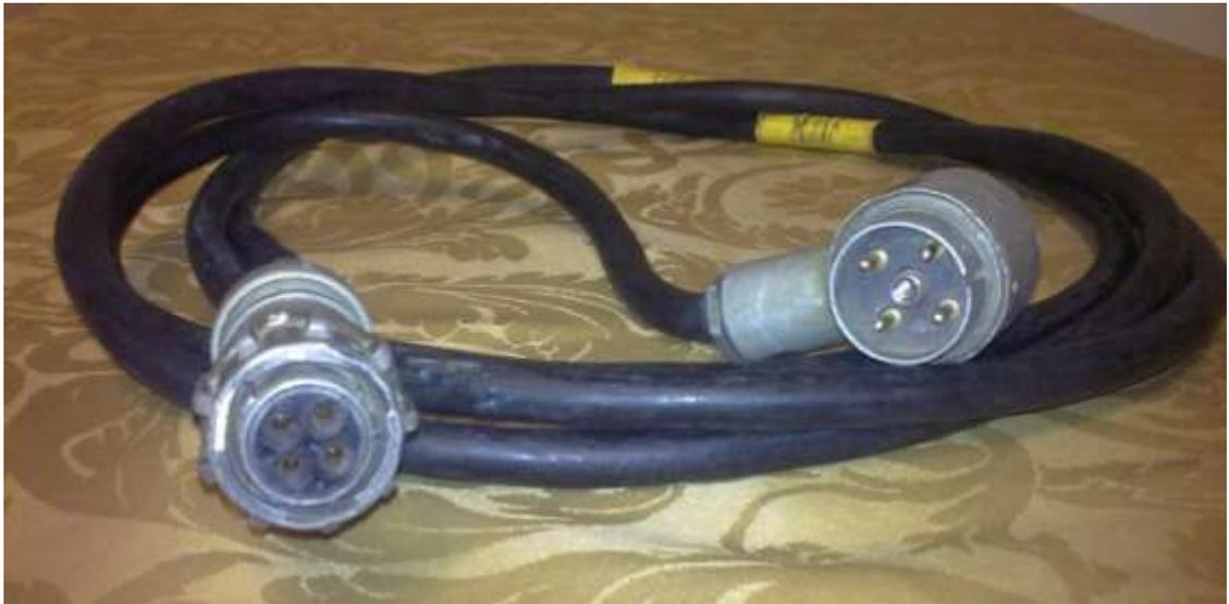
**Figura. 1.7. Cable de alimentación de CC CX-8020**
