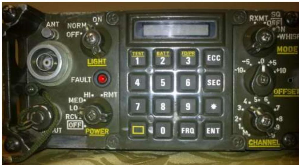
Figura. 1.1. Receptor transmisor RT-3088
