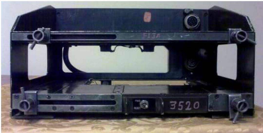
Figura. 1.4. Base de montaje MT-7088
