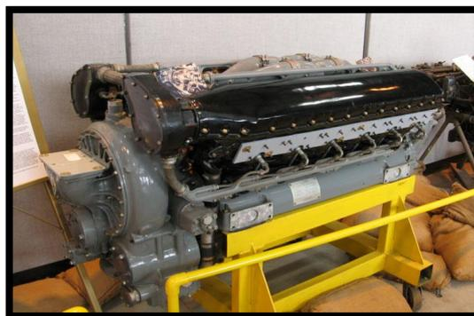
**FIGURA 7 Motor de cilindros en V**
