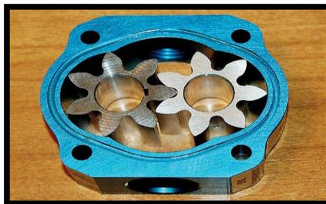
**FIGURA 28 Bomba tipo engranaje**
