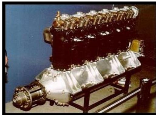
**FIGURA 5 Motor de cilindros en línea**
