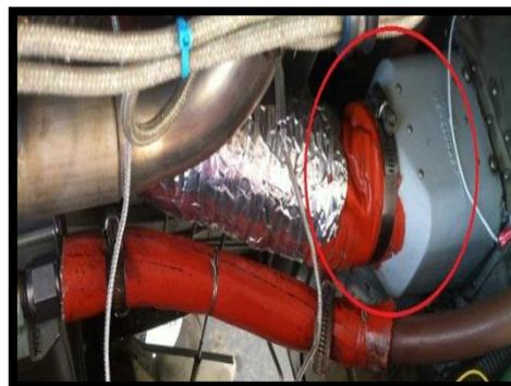
**FIGURA 71 Conexión ducto flexible a la pared de fuego**
