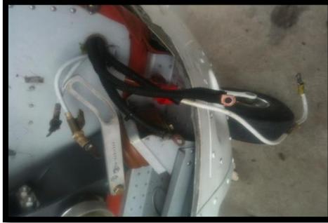
**FIGURA 54 Cables del alternador y motor de arranque**
