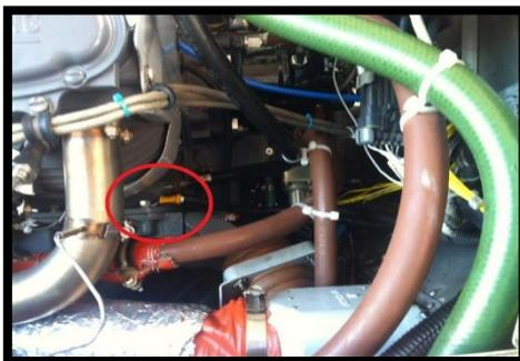
**FIGURA 53 Conexión a tierra del motor**
