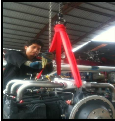
**FIGURA 44 Colocación de faja en puntos de levantamiento**
