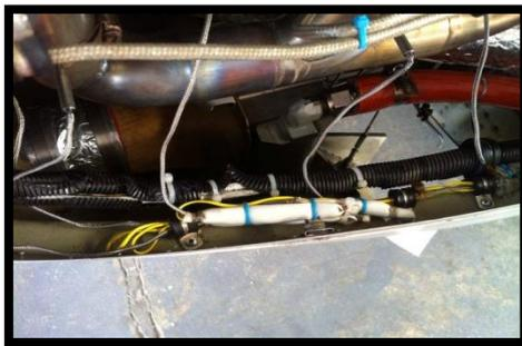
**FIGURA 57 Conjuntos de cables asegurados**
