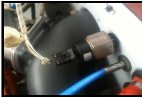
**FIGURA 50 Transductor de presión de aceite**
