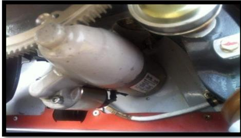
**FIGURA 56 Motor de arranque**
