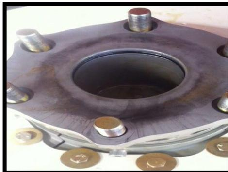
**FIGURA 78 O-ring en la base del eje**
