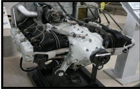
**FIGURA 6 Motor horizontalmente opuesto**
