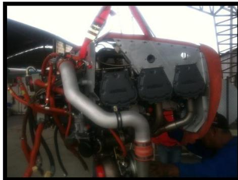
**FIGURA 45 Levantamiento del motor**
