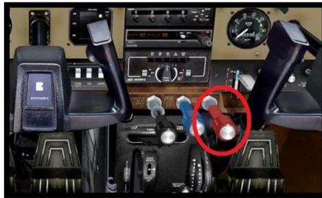
**FIGURA 36 Control de mezcla de combustible**
