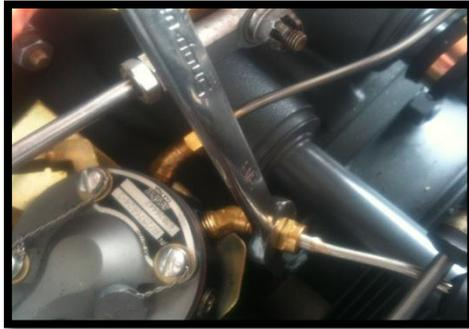
**FIGURA 74 Verificación de conexión en línea de combustible**
