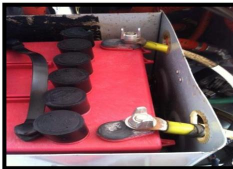
**FIGURA 75 Conexión cable a batería**
