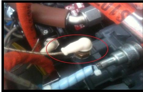
**FIGURA 49 Sensor de temperatura de aceite**
