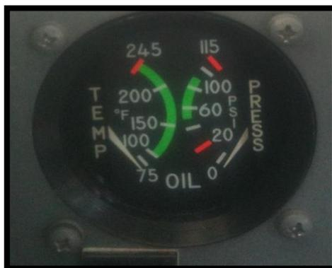
**FIGURA 32 Indicador de presión y temperatura de aceite**
