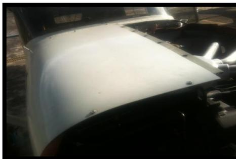
**FIGURA 76 Colocación de capotas del motor**
