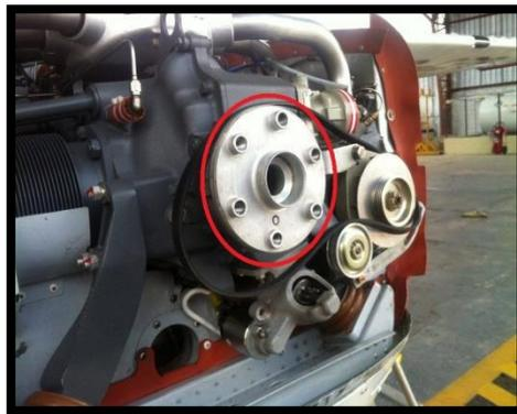
**FIGURA 77 Base del eje del motor**
