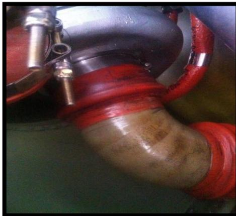
**FIGURA 73 Conexión del ducto a la entrada del turbo cargador**
