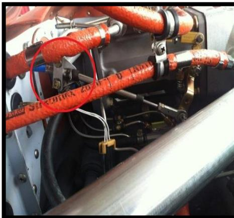
**FIGURA 62** Cable de control de mezcla
