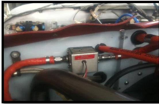
**FIGURA 21 Sensor de flujo de combustible**
