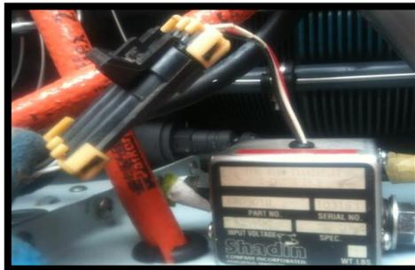
**FIGURA 52 Transductor de flujo de combustible**
