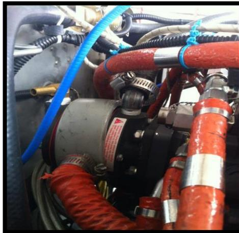
**FIGURA 59 Bomba de vacío y sus conexiones**
