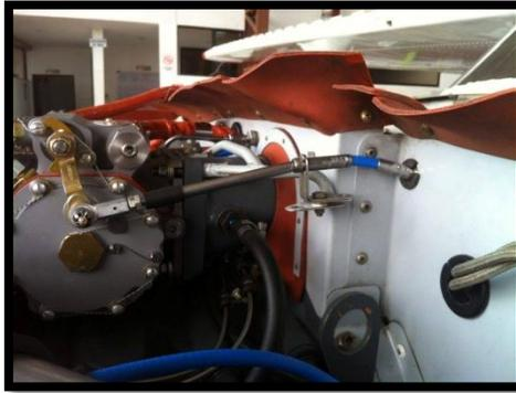
**FIGURA 63 Cable de control de potencia**
