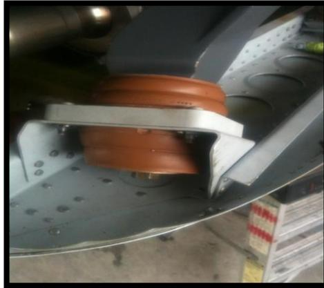
**FIGURA 46 Montante del motor tipo sándwich**
