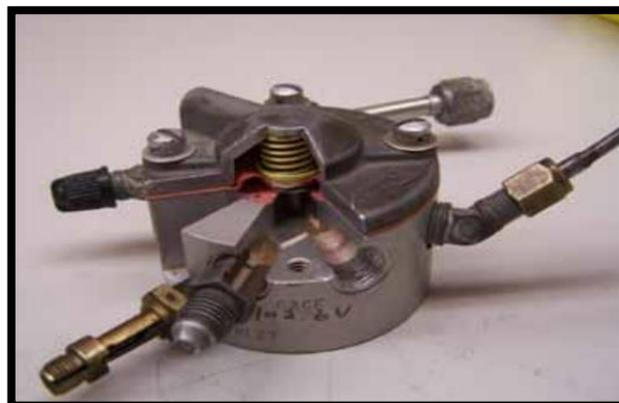
**FIGURA 18 Válvula distribuidora de combustible**
