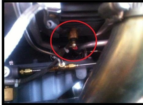
**FIGURA 68 Ubicación del sensor de CHT tipo bulbo**
