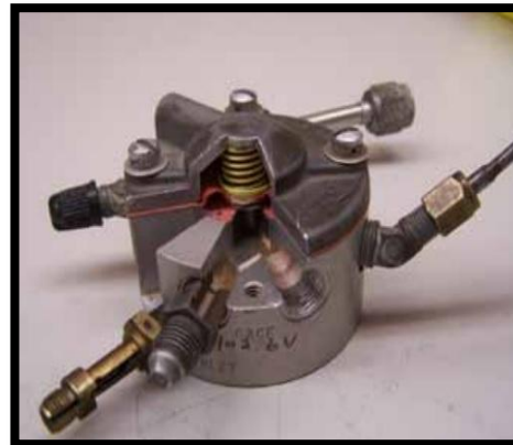
Válvula distribuidora de combustible
