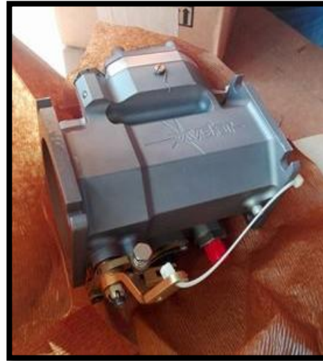
Unidad de Control Aire Combustible
