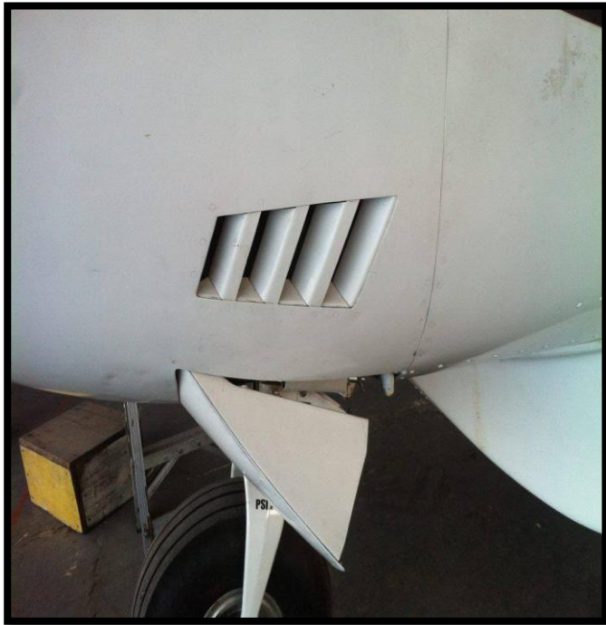
Aletas de refrigeración
