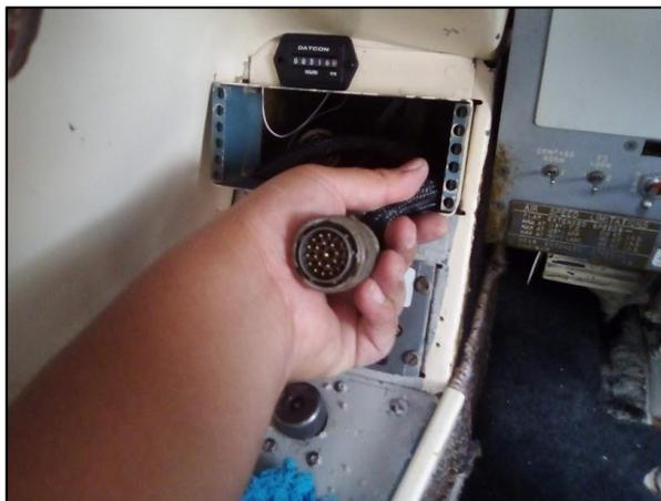
**Figura 62 Remoción de la conexión eléctrica de la caja de estación.**
