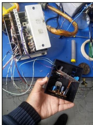
**Figura 46.- Circuito interphone y amplificador ubicados en la caja de protección lista para su instalación.**
