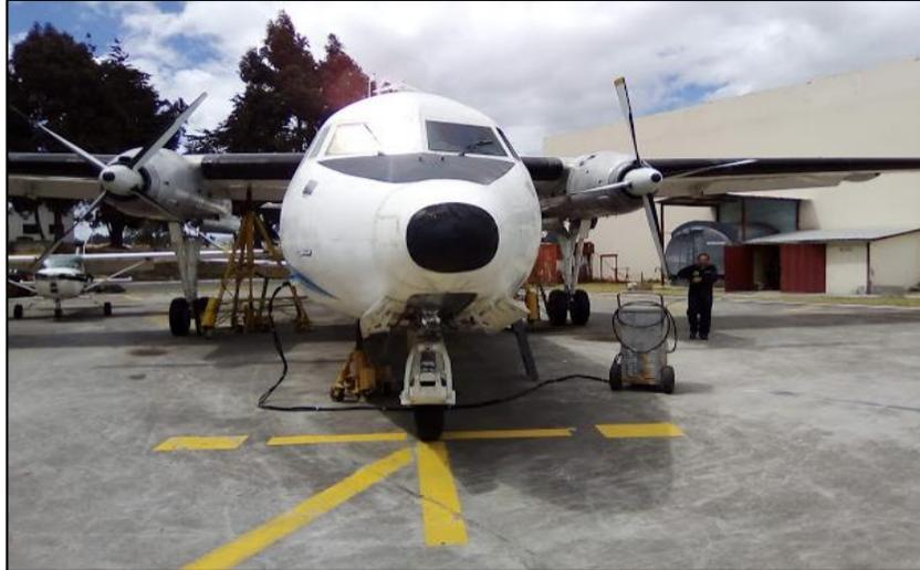
**Figura 68 Aeronave Fairchild FH – 227 energizada a través de la planta en tierra.**
