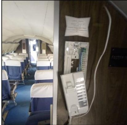
**Figura 47 Intercomunicador ubicado parte posterior interna aeronave Fairchild.**
