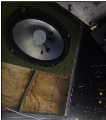
**Figura 50 Instalación del parlante en la cabina de la aeronave Fairchild FH – 227.**
