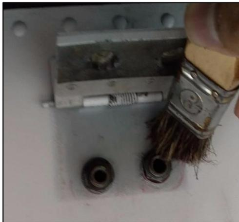
**Figura 65 Remoción de humedad de las tomas de conexión.**
