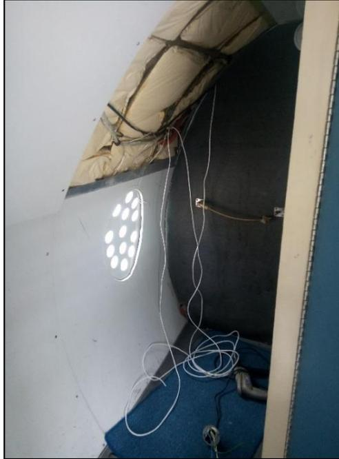
**Figura 49 Instalación del cableado para los intercomunicadores aeronave Fairchild.**
