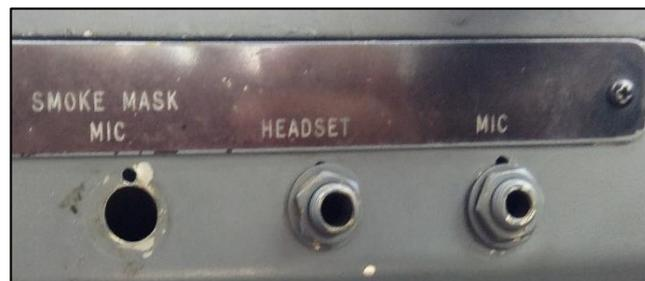
**Figura 22 Tomas de conexión en cabina de la aeronave Fairchild FH – 227.**
