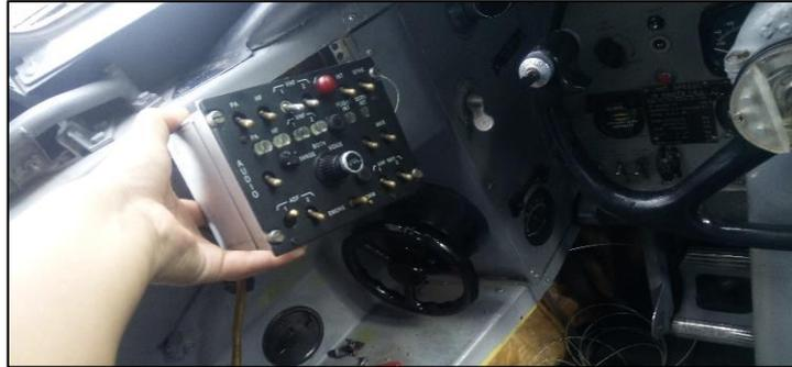
**Figura 56 Instalación del Panel Selector de Audio.**
