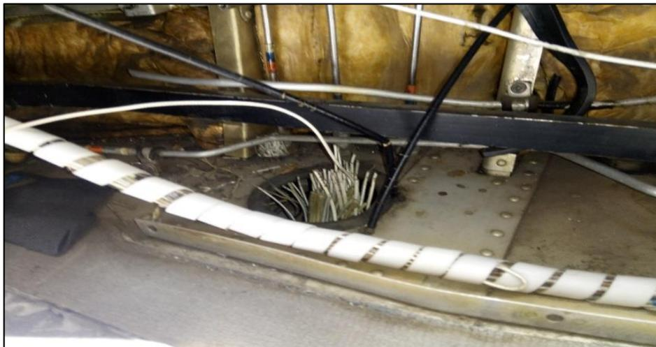
**Figura 21 Sistema de cableado para la caja de audio copiloto totalmente cortado e inservible aeronave Fairchild FH – 227.**
