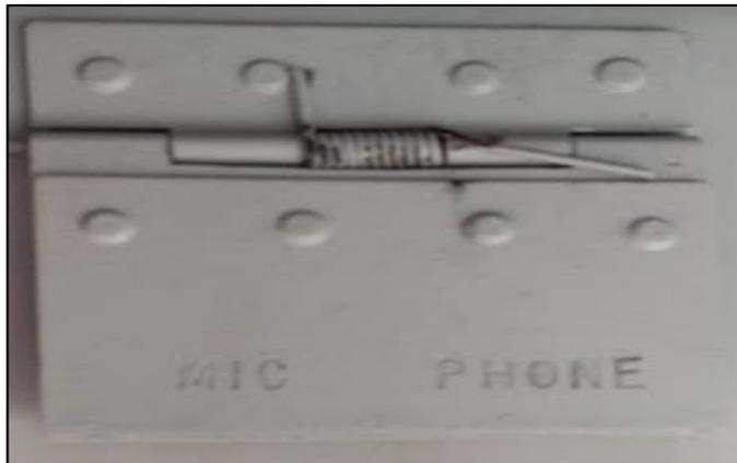
**Figura 15 Caja de conectores de tripulación en tierra avión Hawker 125 – 400.**
