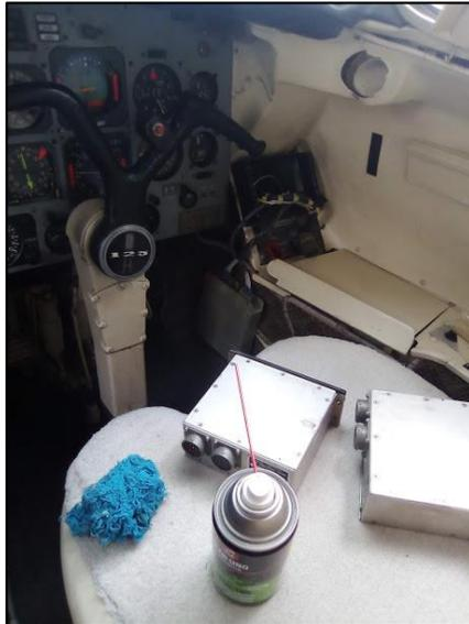
**Figura 63 Limpieza de las cajas de audio.**
