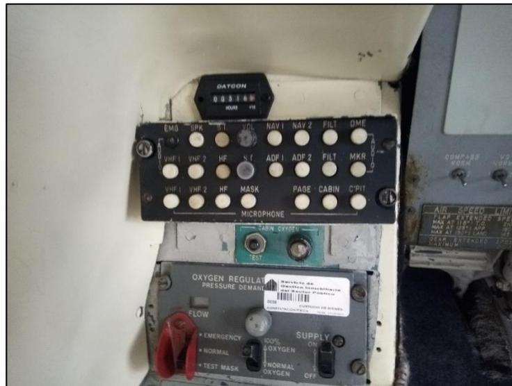
**Figura 27 Caja de estación o panel de audio
