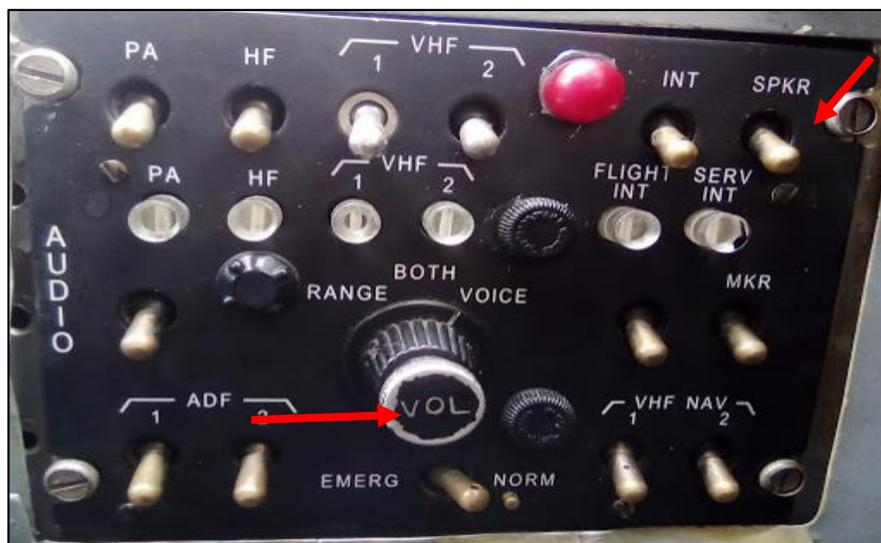
**Figura 72 Activación de interruptor SPKR y regulador de volumen en la caja de audio.**
