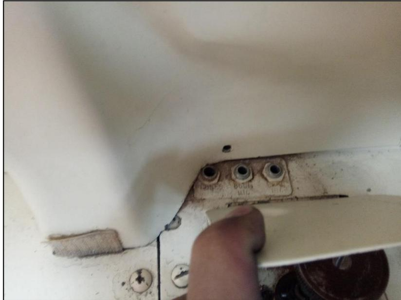
**Figura 25 Tomas de conexión de auricular y micrófono del piloto en cabina de la aeronave Hawker Siddeley 125 – 400.**
