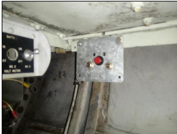
**Figura 52 Tomas de conexión de headsets y pulsador aeronave Fairchild FH – 227.**
