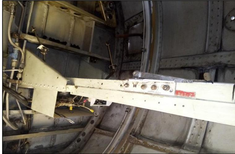
**Figura 18 Verificación de las tomas de conexión en el alojamiento del tren de nariz aeronave Fairchild FH – 227.**
