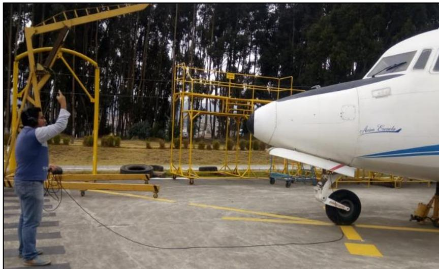
**Figura 4 Comunicación a través del sistema interphone Fairchild FH – 227.**
