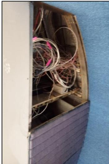
**Figura 24 Compartimiento de aviónica de la aeronave Fairchild FH – 227.**
