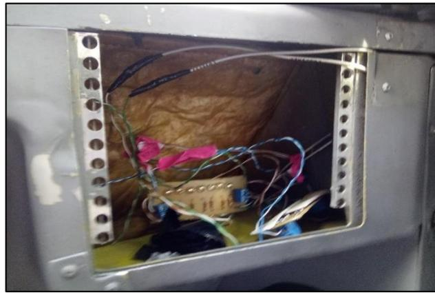
**Figura 20 Ubicación de la caja de audio del copiloto aeronave Fairchild FH – 227.**
