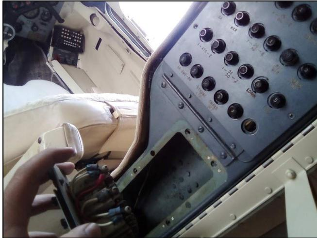
**Figura 67 Remoción del panel circuit breakers.**
