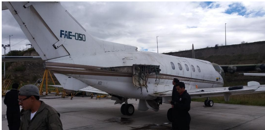
Figura 30 Desmontaje del motor
