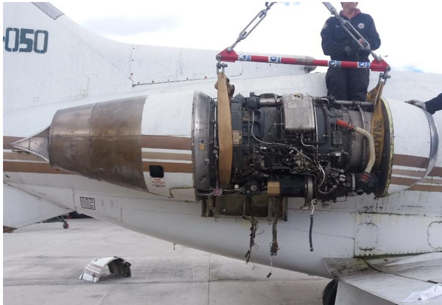
Figura 22 Colocación de la eslinga al motor
