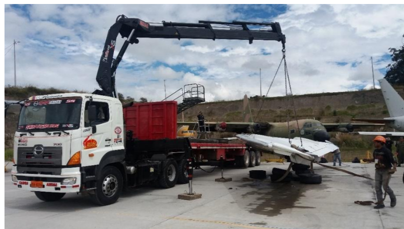
Figura 60 Elevación de las alas con la grúa
