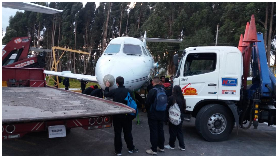
Figura 67 Elevación de las alas para su montaje
