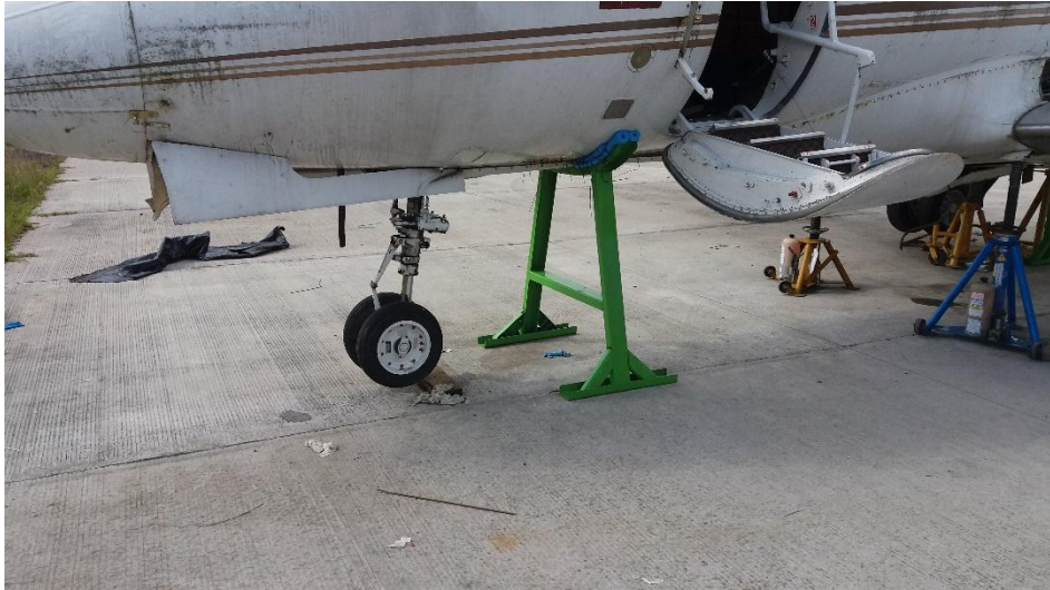
Figura 32 Colocación del soporte delantero del avión
