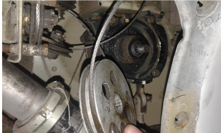
Figura 47 Desmontaje de la polea de los cables del flap
