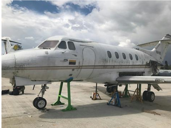
Figura 34 Avión colocado sobre los soportes
