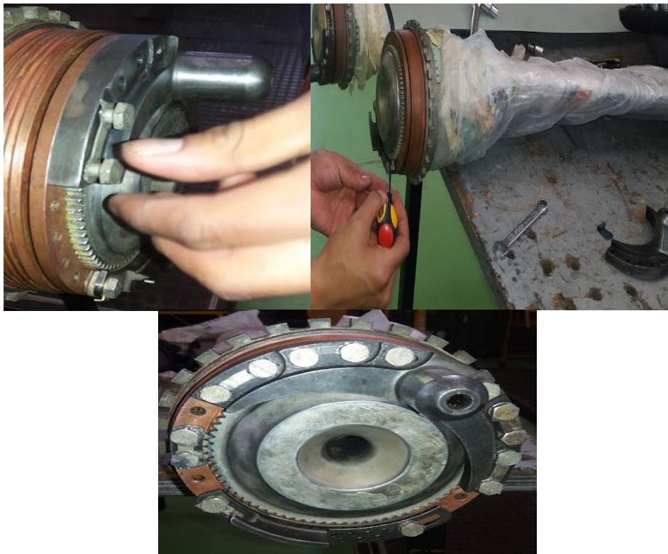
Figura 80: Montaje de los seguros, pernos y Pin Operating de la blade group.
