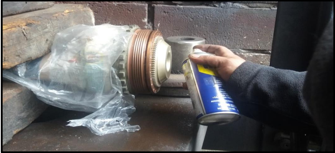
Figura 47: Lubricación con W40
