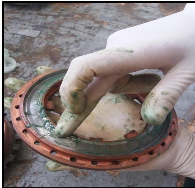
Figura 70: Lubricación de la race botton
