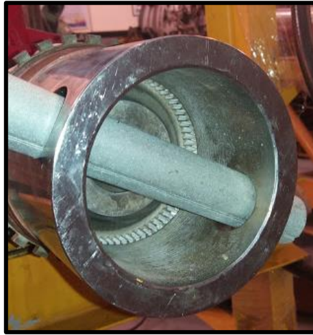
Figura 79: ajuste de la bolt blade con la herramienta especial.
