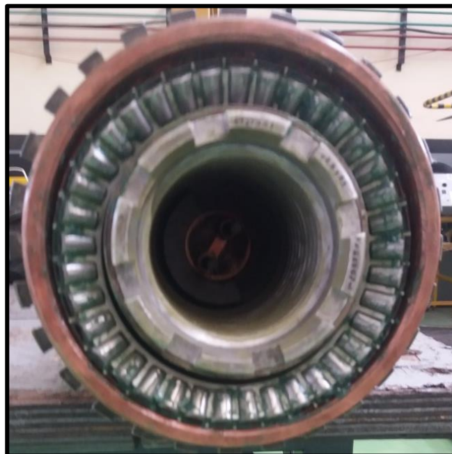
Figura 74: Montaje de la Race Center en el Blade and bushes assembly
