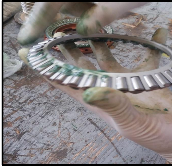
Figura 69: Lubricación de las case assembly
