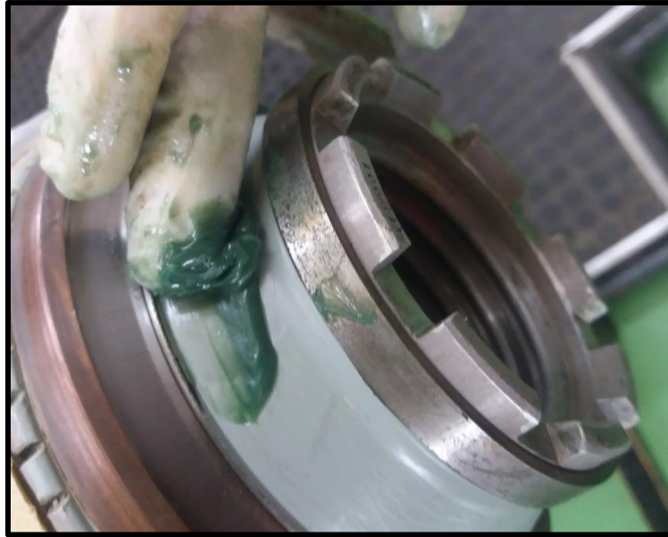
Figura 71: Lubricación de la Blade and bushes assembly
