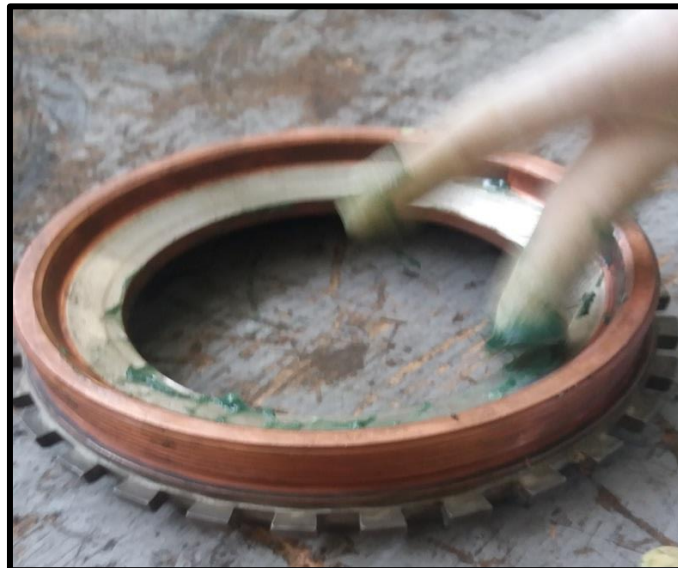
Figura 68: Lubricación de la race center
