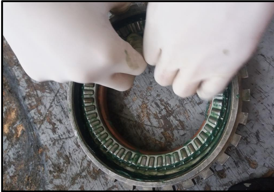
Figura 73: Montaje de los case assembly propeller en la Race center.
