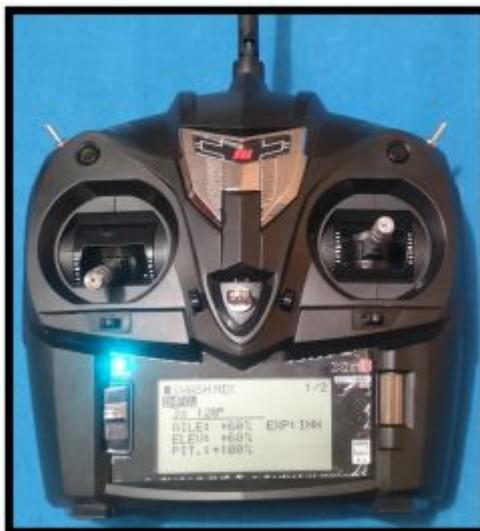
**Figura 49** Configuración del Control Remoto (SWASH MIX)
