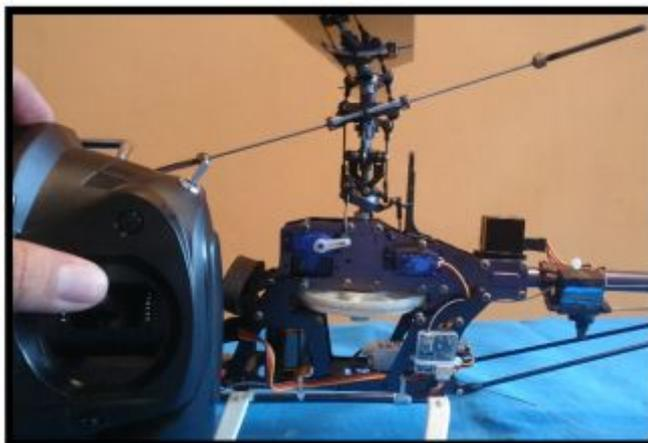
**Figura 47** Comprobación del movimiento hacia adelante
