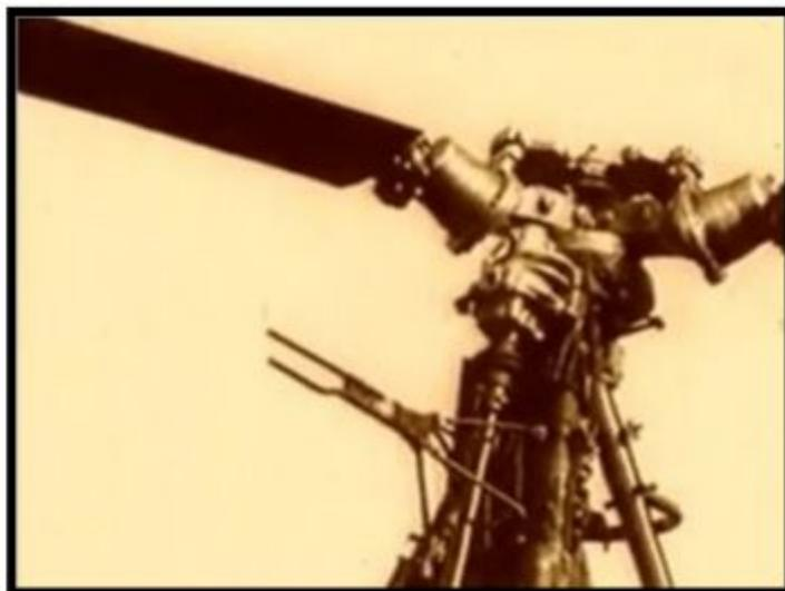
**Figura 6** Bisagra para las hélices
