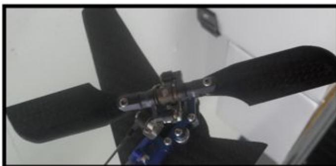
**Figura 20** Aspas del Rotor de cola
