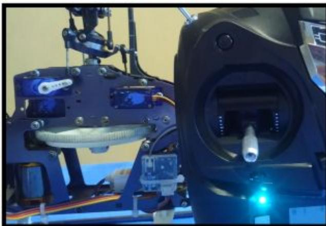
**Figura 42** Verificación sin aceleración del plato cíclico
