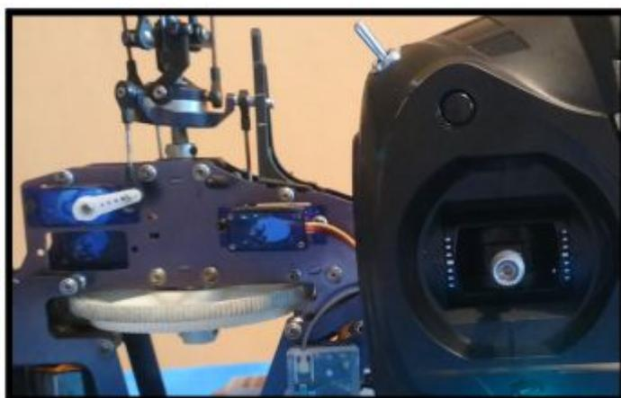
**Figura 43** Verificación al 50% de aceleración del plato cíclico
