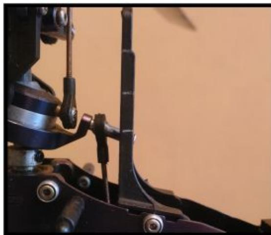
**Figura 41** Marcas previas antes de la calibración del plato cíclico
