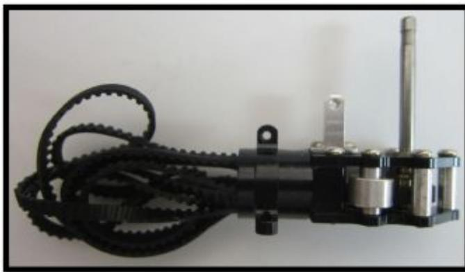
**Figura 25** Banda de Transmisión y Rotor de cola
