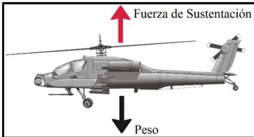
**Figura 7** Diagrama de empuje vertical
