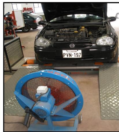
FIGURA 6 VEHÍCULO EN PRUEBAS PRUEBAS DE EMISIONES DE GASES (CO<sub>2</sub>, NO<sub>x</sub>, HC, ENTRE OTROS)
