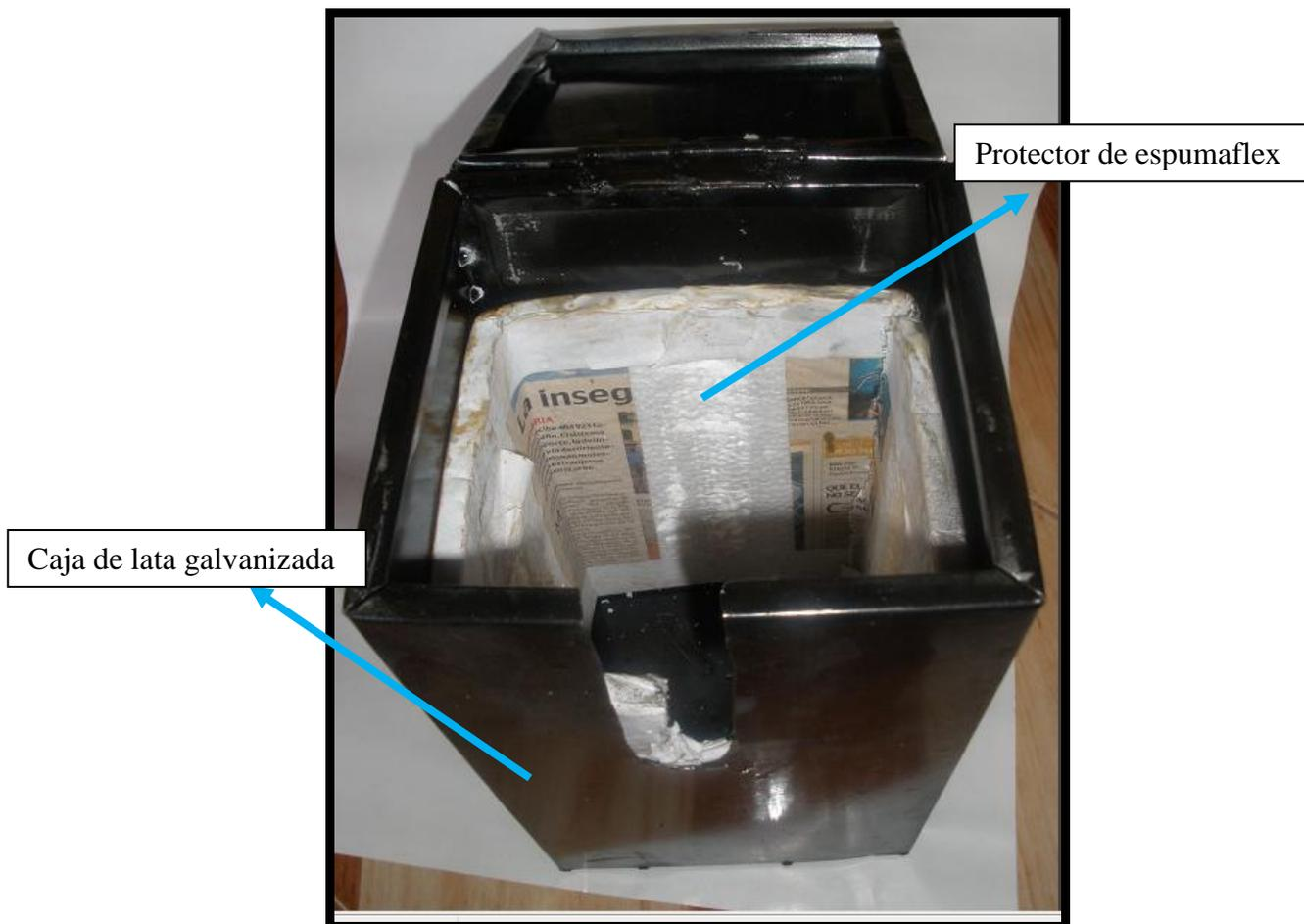
**FIGURA 4.3 CAJA DE PROTECCIÓN PARA EL MATRAZ**
