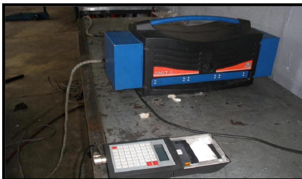
**FIGURA 5.5 EQUIPO PARA LAS MEDICIONES DE GASES**
