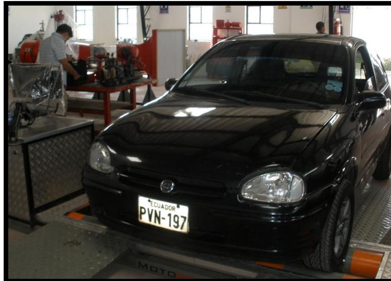
**FIGURA 5.14 UBICACIÓN DEL VEHÍCULO EN LOS RODILLOS DEL DINAMÓMETRO**
