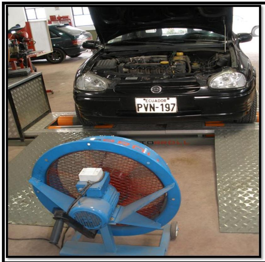
**FIGURA 5.2 DISPOSICIÓN DEL VEHÍCULO Y LOS INSTRUMENTOS PARA LAS PRUEBAS**
