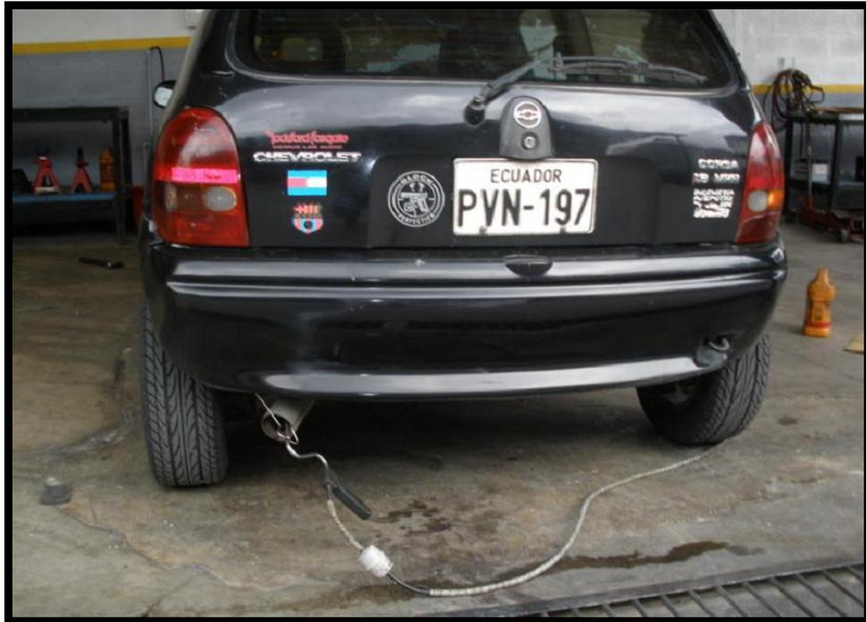
FIGURA 5.6 ANALIZADOR CONECTADO
