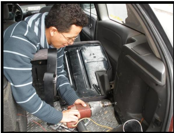
Ajuste de las abrazaderas de soporte del almacenamiento del hidrógeno
