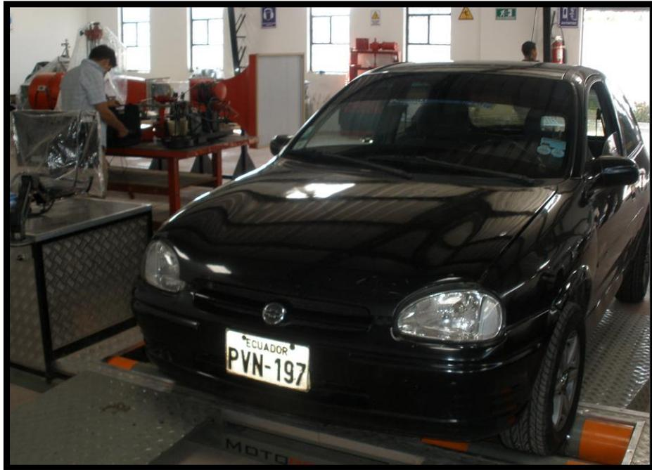
**FIGURA 5.1 VEHÍCULO EN EL DINAMÓMETRO**
