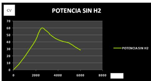
FIGURA 10 POTENCIA SIN HIDRÓGENO
