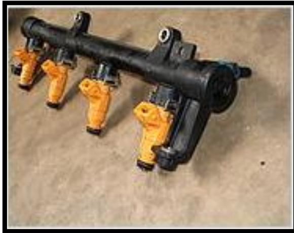
**FIGURA 1.4 RIEL DE INYECCIÓN GASOLINA**
