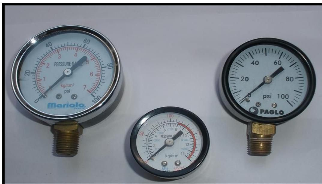
**FIGURA 3.30 MANÓMETROS DE CONTROL DE PRESIÓN**
