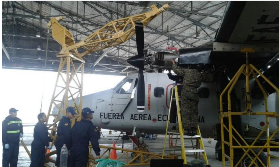
Figura 32 Remoción de los aisladores de vibración inferiores
