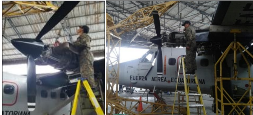
Figura 30 Motor preparado para su remoción
