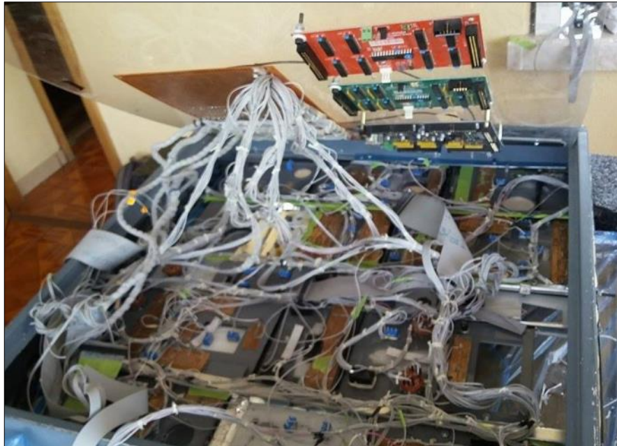
Figura 72 Ensamble de las placas al OVERHEAD
