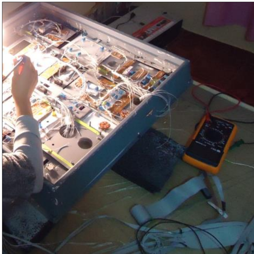
Figura 71 Soldadura del arnés a los DEVICE
