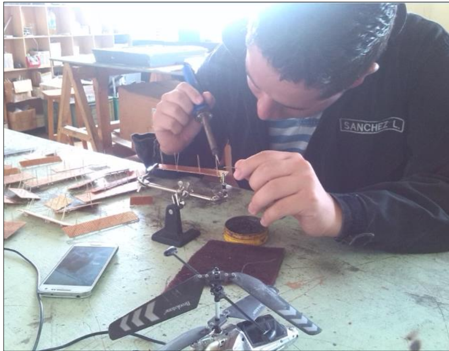
Figura 59 Soldadura de las placas de recepción de datos
