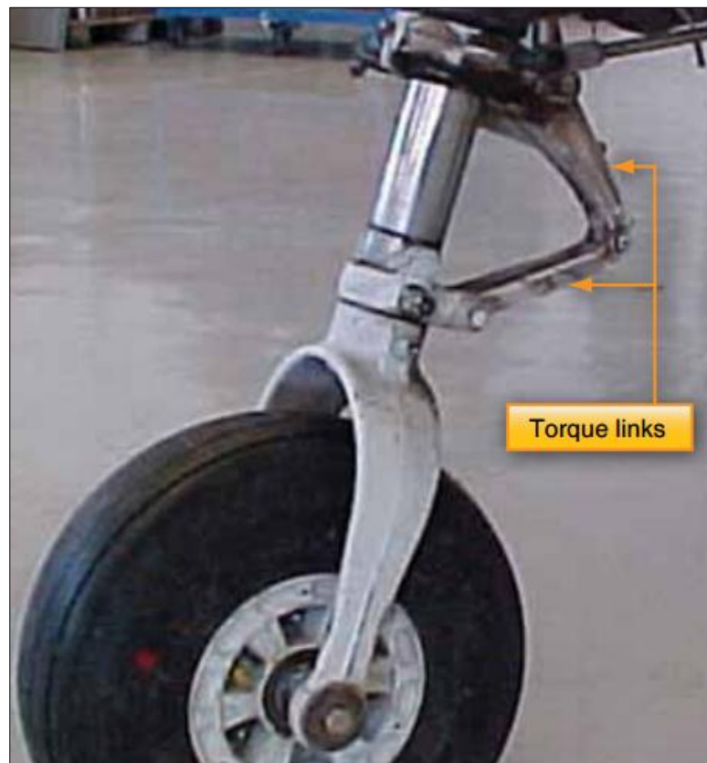
FIGURA 5 Torque links de un montante amortiguador
