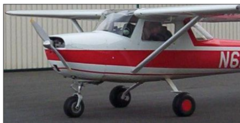
FIGURA 4 Cessna 150 con trenes Leaf-Type Spring Gear
