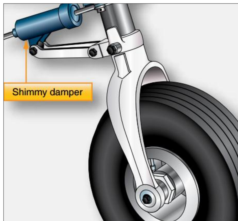
FIGURA 8 Shimmy Damper del tren de nariz
