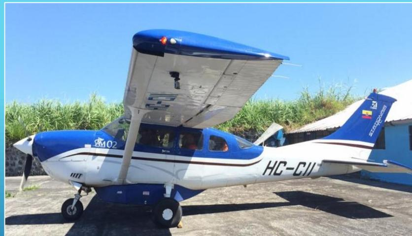
**Para proceder con las tareas de la inspección progresiva de 200 horas se utilizó las 4 operaciones respectivas (operación 1,2,3 y 4) que se encuentra en el capítulo 5 del Manual de Mantenimiento de la aeronave CESSNA T206H.**
