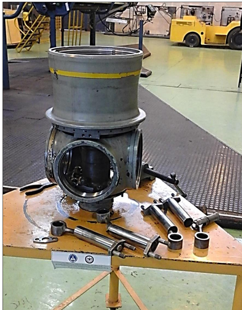
FIGURA 26 Cubo de la hélice desmantelado
