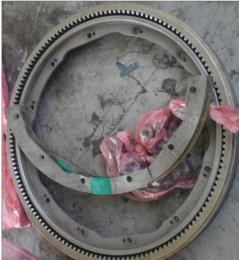
FIGURA 20 Elementos de retención extraídos y ordenados
