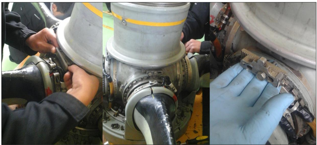
FIGURA 13 Remoción de los seguros de las palas
