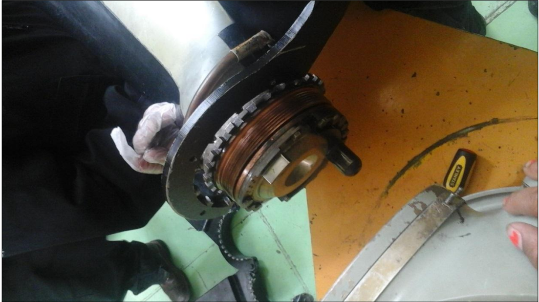
FIGURA 23 Desmontaje de las palas
