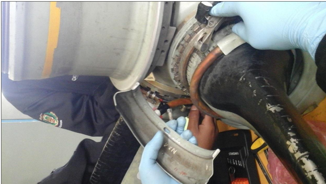
FIGURA 15 Separación de las dos cubiertas de la raíz de la pala
