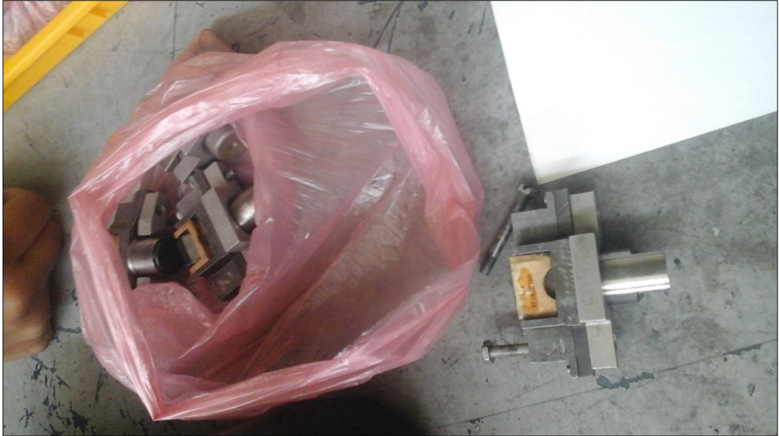
FIGURA 21 Contactos del plato móvil
