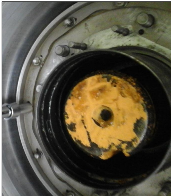
FIGURA 19 Desmantelamiento del pistón
