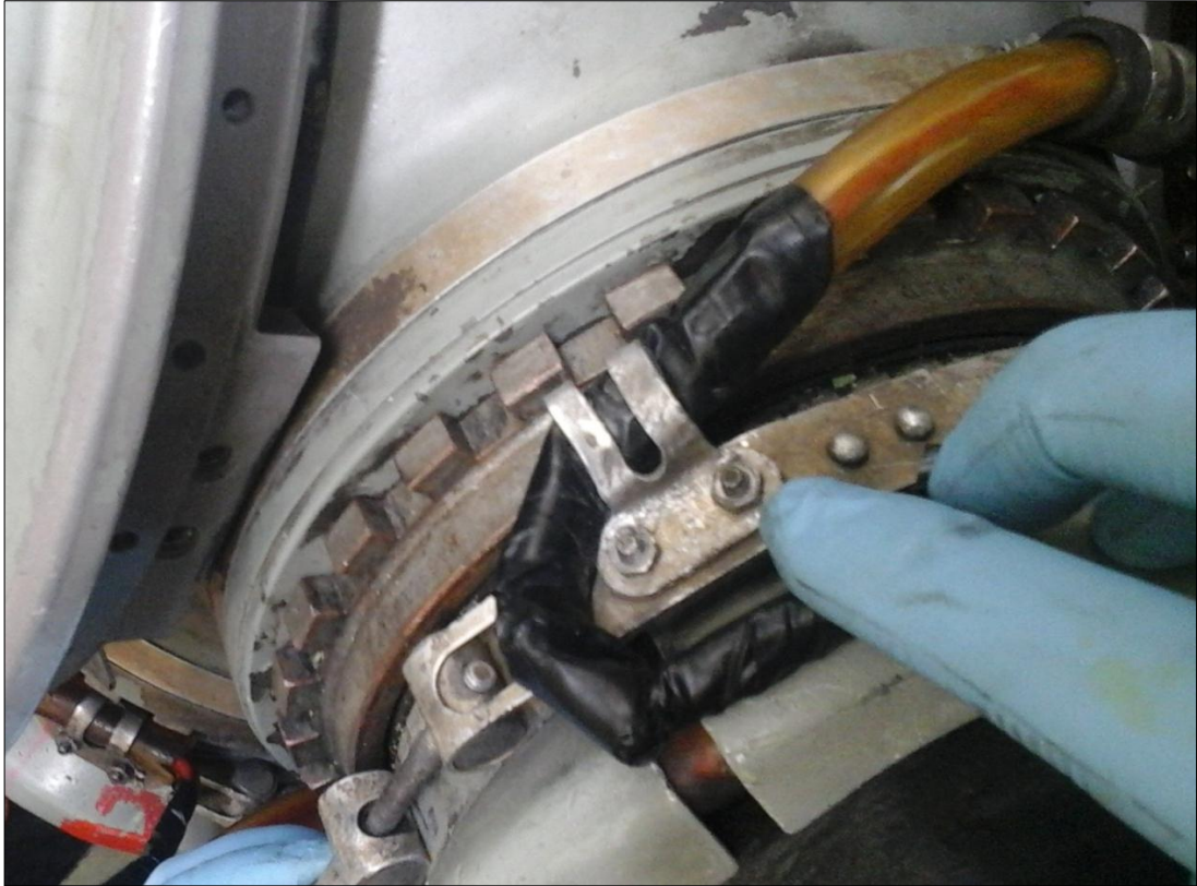
FIGURA 14 Remoción del punto de anclaje de los cables
