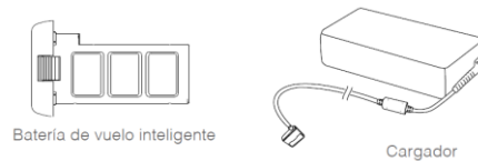
Figura 39 Batería de vuelo inteligente de vuelo y cargador Fuente: (Phantom 3 Standard, Manual del usuario, 2015)
