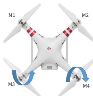
Figura 42 Mayor potencia para avance del dron
