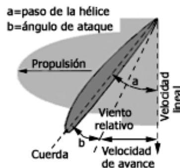
Figura 16 Paso de la hélice
