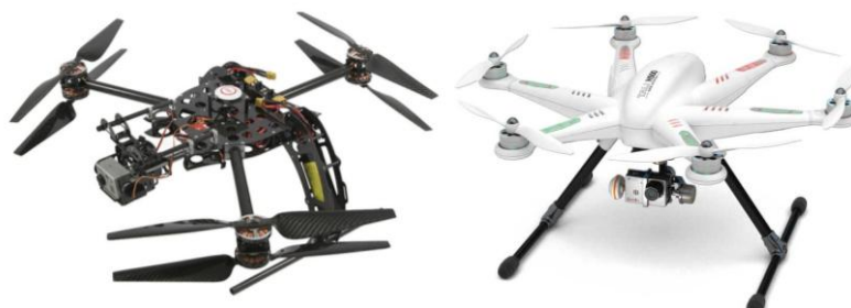
Figura 53 Hexacópteros con disposición de motores Y6 y disposición de motores tradicional
