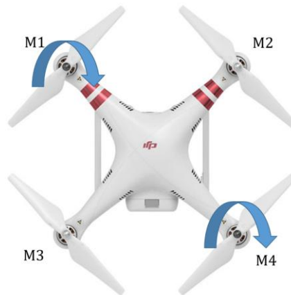
Figura 44 Potencia de motores para rotación hacia la izquierda
