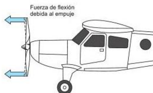
Figura 19 Fuerza de empuje sometida a una hélice
