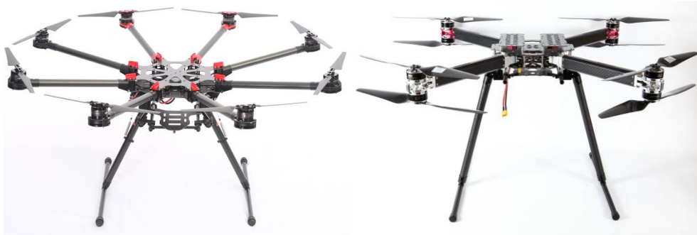
Figura 54 Octocópteros con disposición de motores X8 y disposición de motores tradicional
