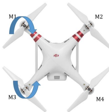
Figura 43 Mayor potencia para desplazamiento hacia la izquierda
