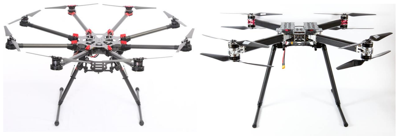
Octocópteros con disposición de motores X8 y disposición de motores tradicional
