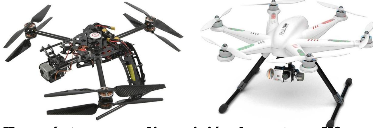
Hexacópteros con disposición de motores Y6 y disposición de motores tradicional
