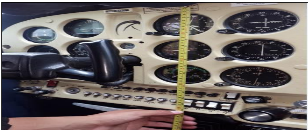
Figura 13 Medición de altura del panel con un Flexometro.
