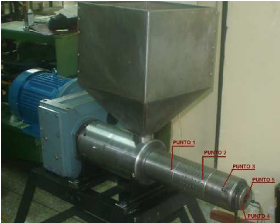
Figura 5.1 Puntos de toma de temperatura
