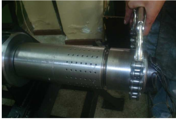
Figura 4.10 Montaje de camisas de extrusión en máquina expeller
