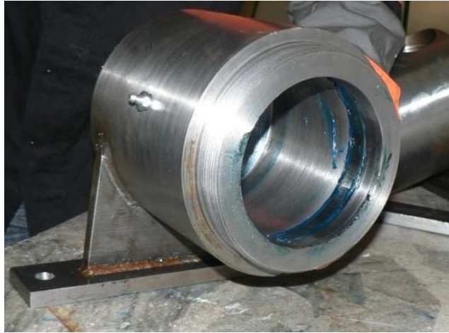
Figura 4.3 Alojamiento de rodamientos con pista externa in situ
