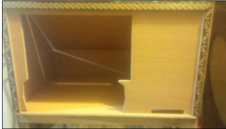
Figura 56. Corte de las aberturas para los equipos del simulador.
