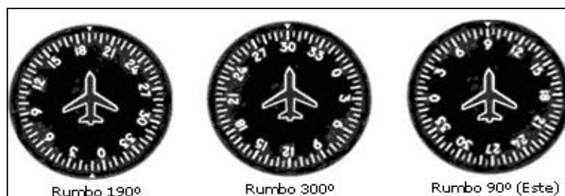
Figura 18. Diferentes marcaciones en un indicador de dirección.
