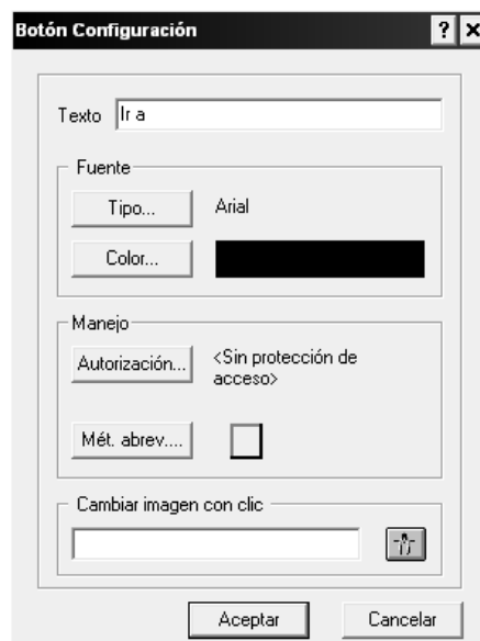
Figura 6. 48. Configuración del Botón en “Editor Gráfico” de WinCC
