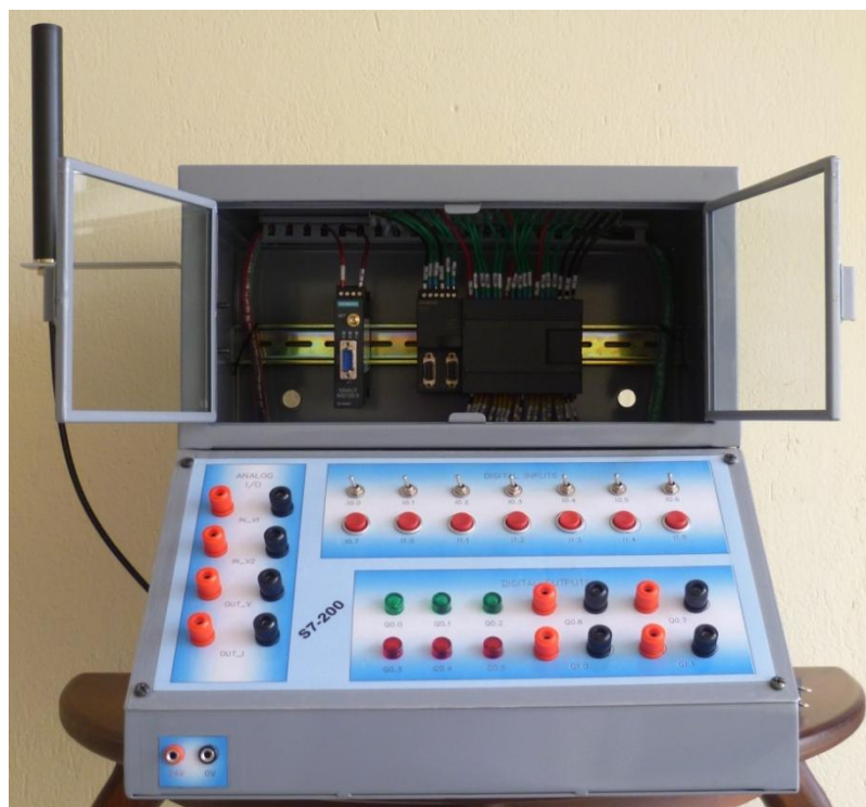
Figura 7. 9. Acceso a los Elementos Internos del “Sistema de Entrenamiento en Telecontrol”
