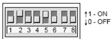
Figura 3. 5. Configuración Cable Multimaestro RS-232/PPI para conexión con la PC 8
