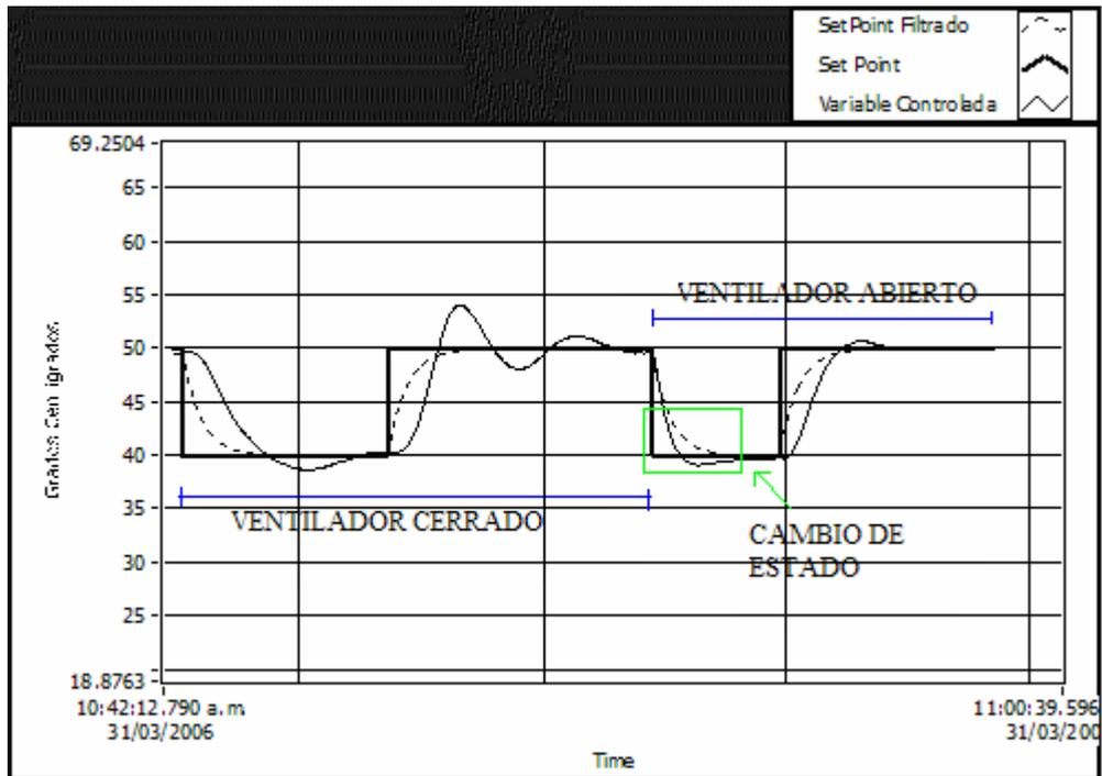
**Figura.7.25. Respuesta de la planta con self-tuning ante perturbaciones utilizando la ley de control tipo A**
