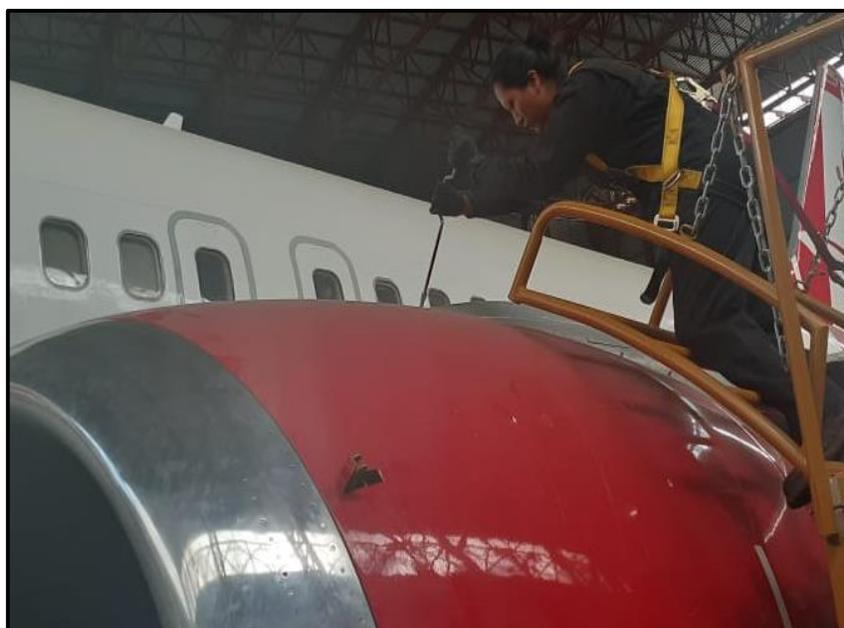
**Figura 27.** Desinstalación de los carenados
