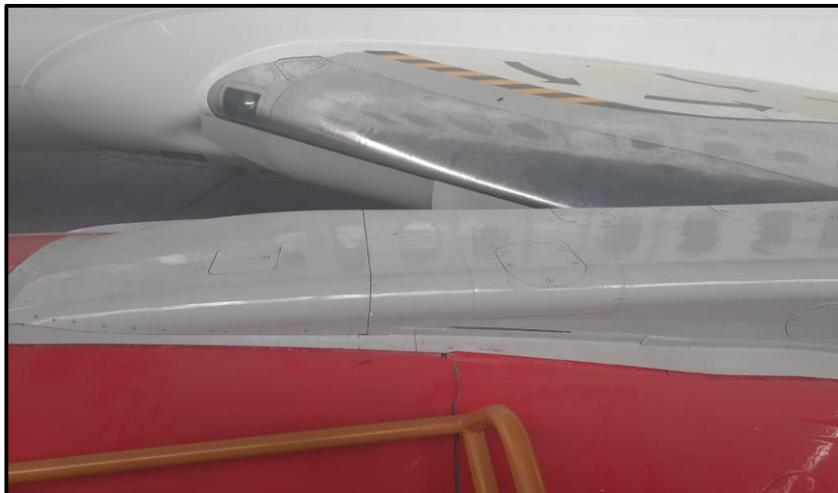
**Figura 49.** Instalación de los carenados del motor
