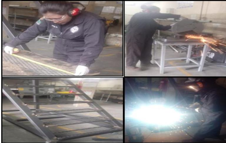
**Figura 21.** Ensamblaje del equipo de apoyo
