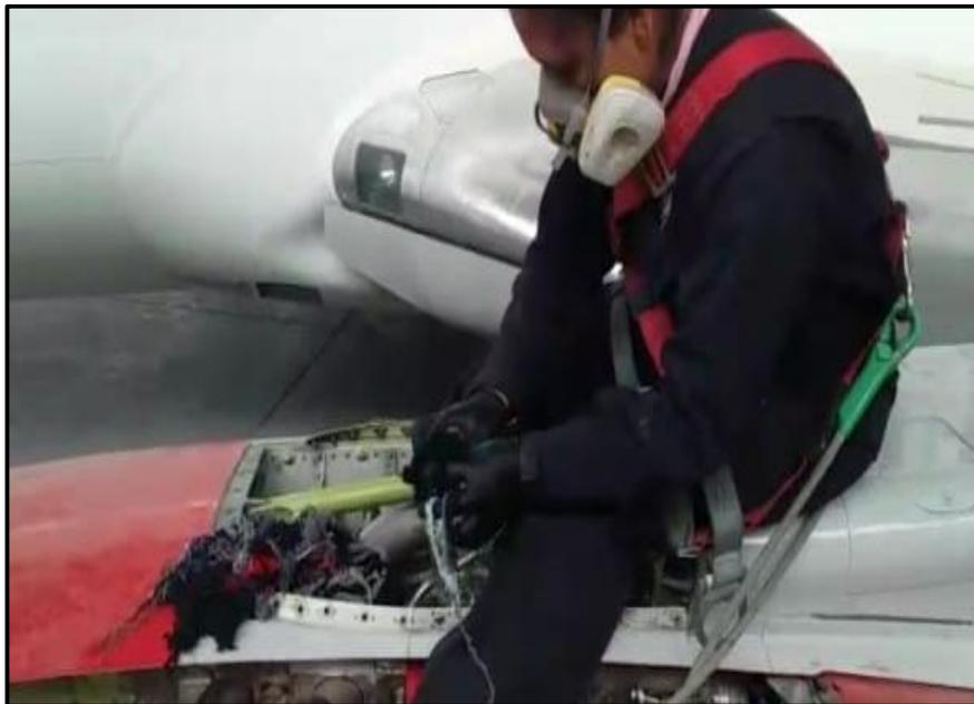
**Figura 32.** Limpieza del área del Strut
