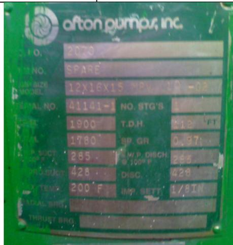
Figura 3.7 Placa de una bomba Booster 1900 GPM
