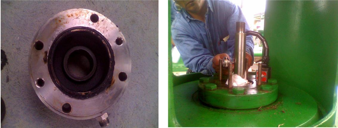
**Figura 3.15** Sello Mecánico y Procedimiento de medición del juego radial
