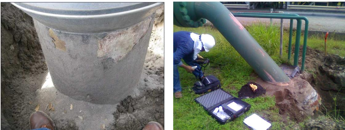
**Figura 3.29** Interfaces y equipo ultrasonido de medición de espesores
