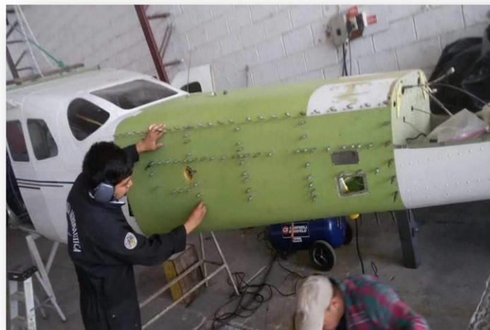
Figura 58 Colocación de la Piel nueva del Tailcone
