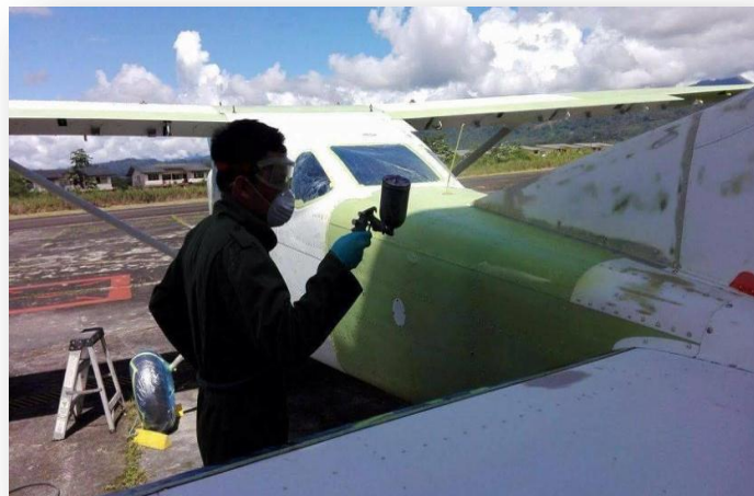
Figura 63 Aplicación de Primer
