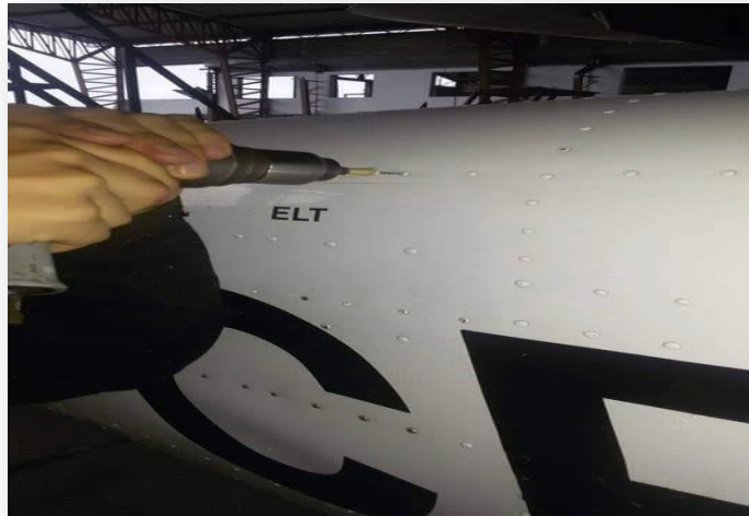
Figura 50 Eliminación de Remaches
