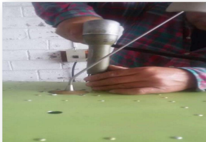
Figura 61 Final del Remachado
