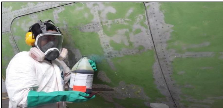
**Figura 55** Equipos de protección personal y material para aplicación de Alodine (Ácido Fosfórico)
