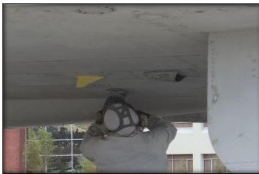
**Figura 48** Antena protegidas con papel industrial y cinta adhesiva
