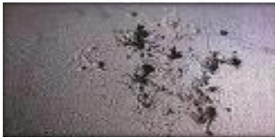
**Figura 7** Corrosión por picaduras
