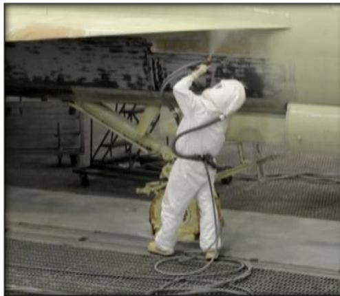
**Figura 17** Tratamiento químico de superficie inhibidores
