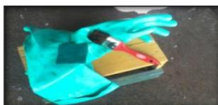
**Figura 51** Materiales y equipo protección personal para aplicar Alumiprep (Ácido Fosfórico)
