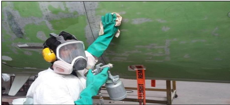
**Figura 61** Pistola de rociado y equipos de protección personal precio a la aplicación de Primer (Fondo)
