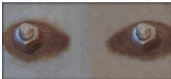
**Figura 8** Corrosión galvánica
