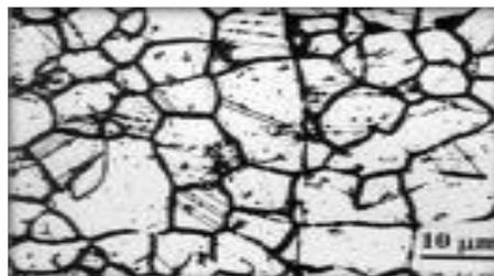
**Figura 11 Corrosión intergranular**
