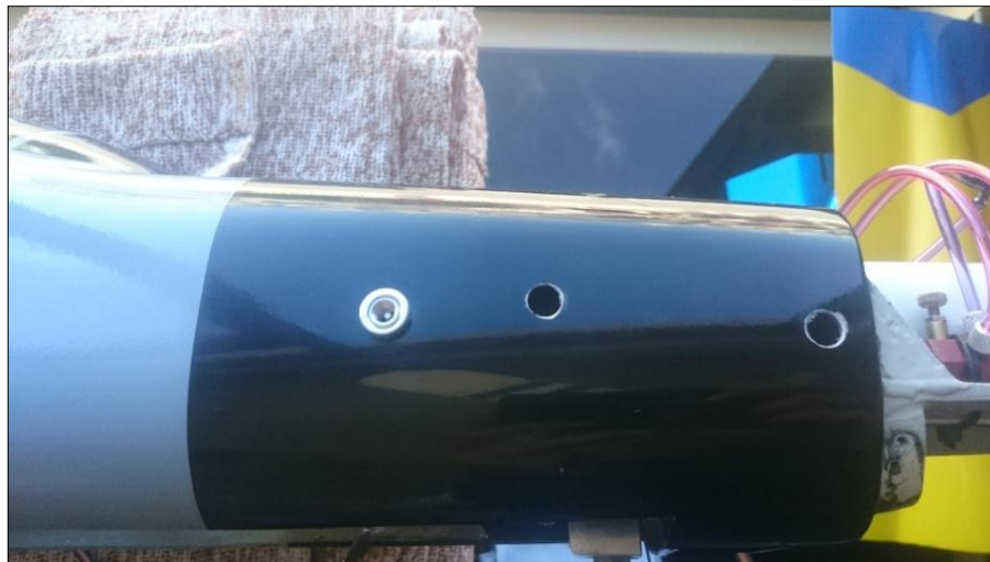
Figura 42: Boca de llenado del tanque de aire
