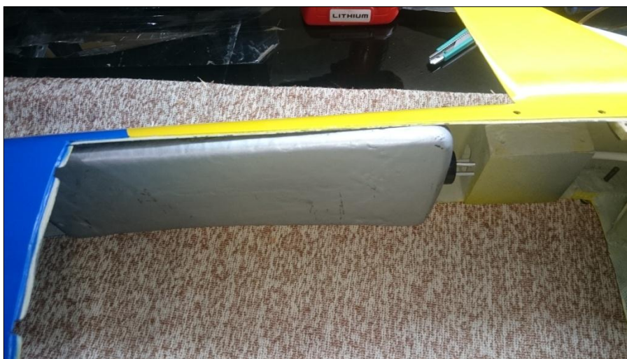
Figura 56: Tanque de combustible
