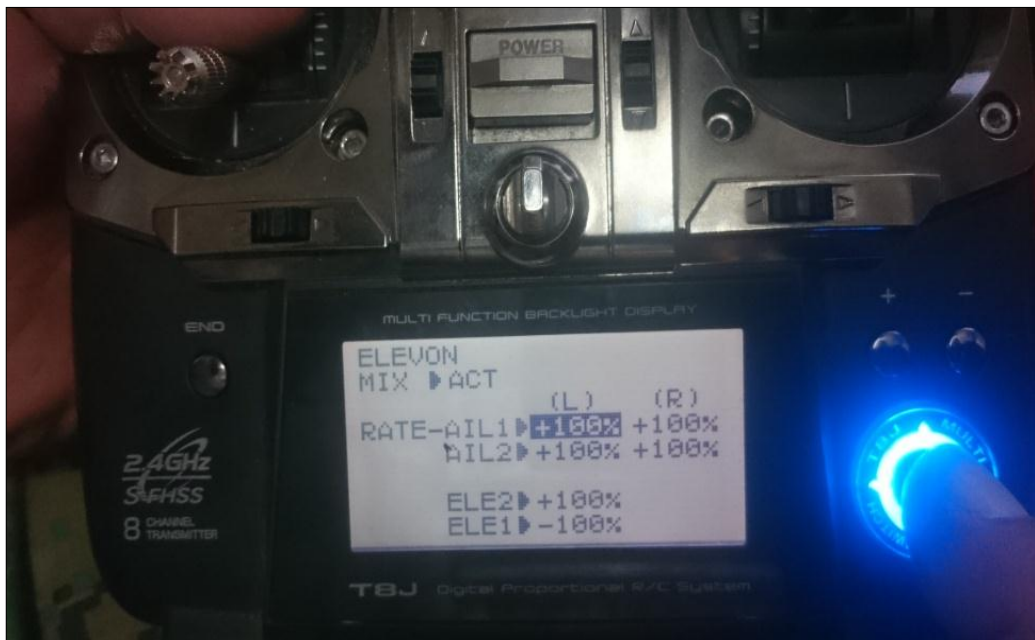
Figura 50: Programación de los servos en el intermix elevón
