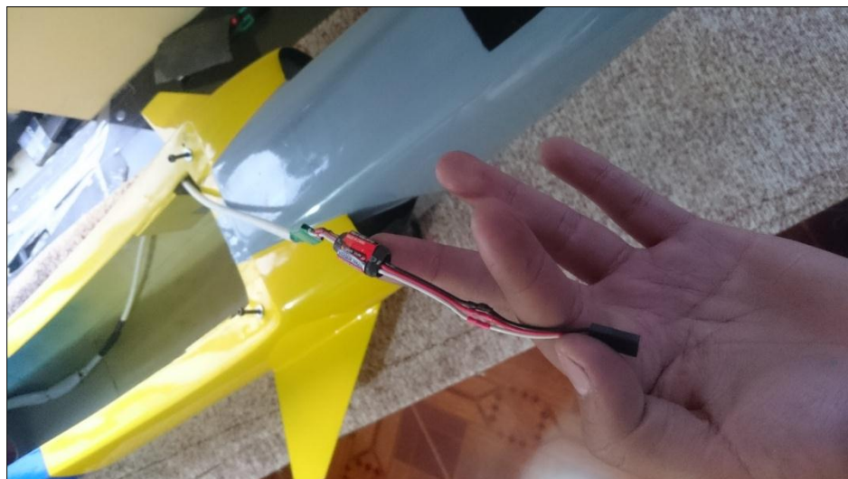
Figura 47: Conexión del inversor
