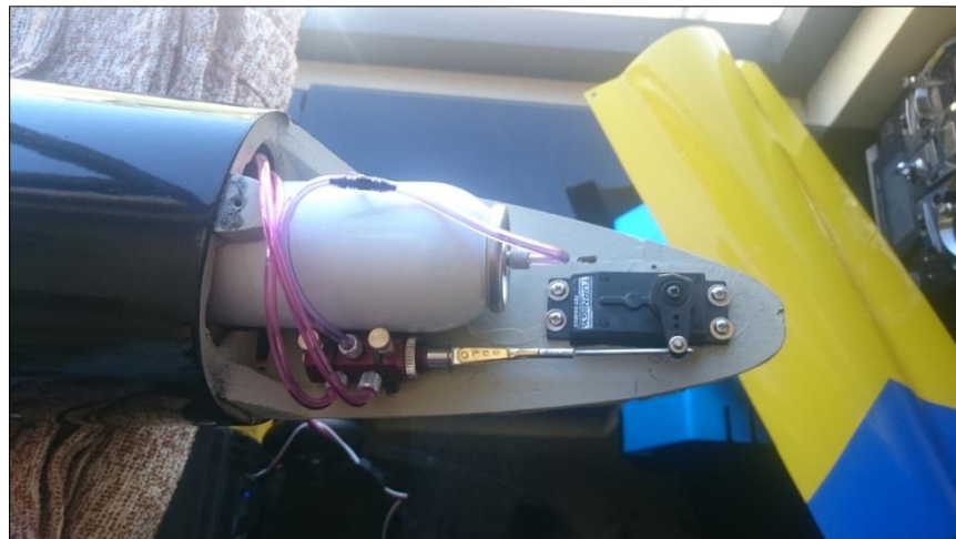
Figura 39: Instalación del servo y la válvula de control
