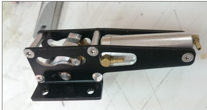
Figura 37: Montaje del tren de nariz
