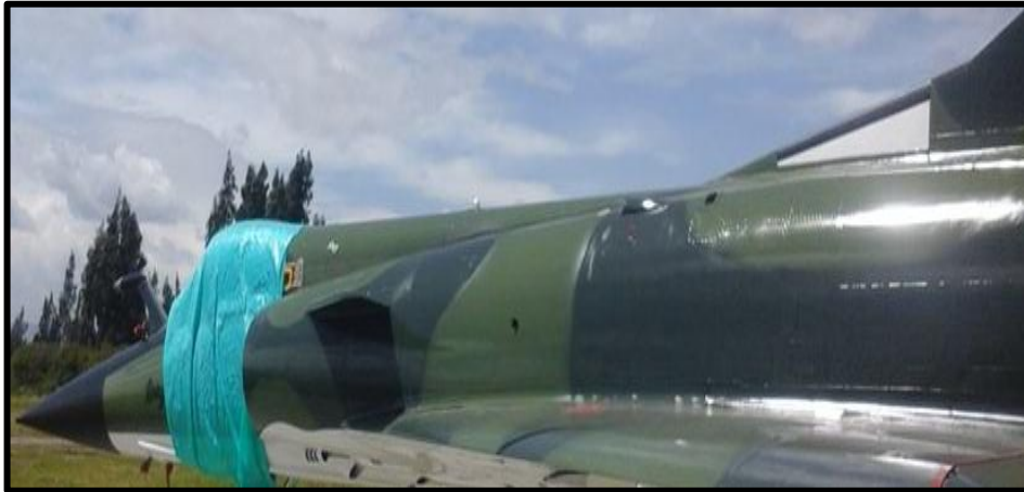
Figura 37 Acabado del pintado en el fuselaje
