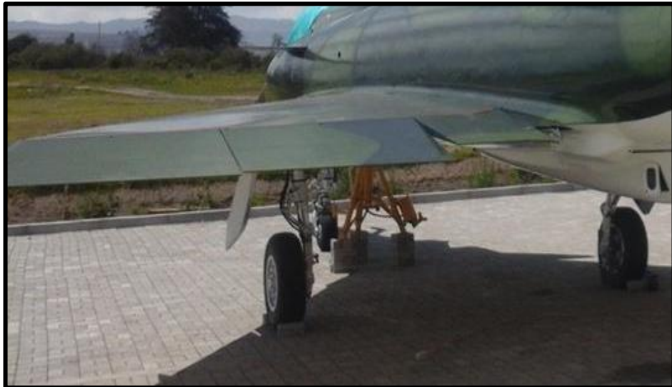
Figura 36 Acabado del pintado en las alas
