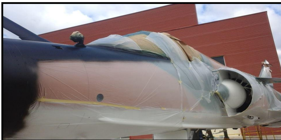
Figura 29 Aeronave enmascarada totalmente.
