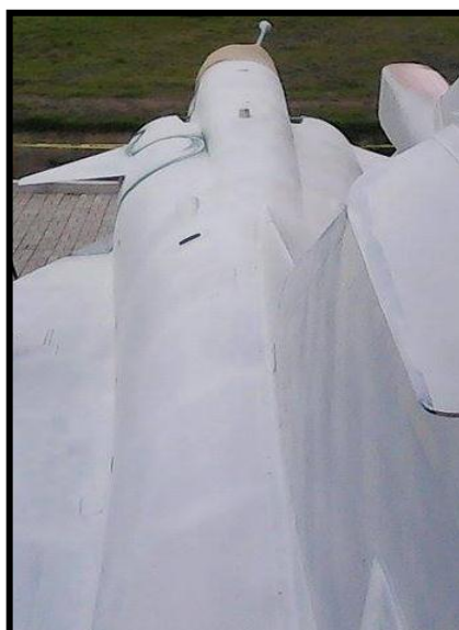
Figura 32 Aplicación finalizada del fondo en el empenaje
