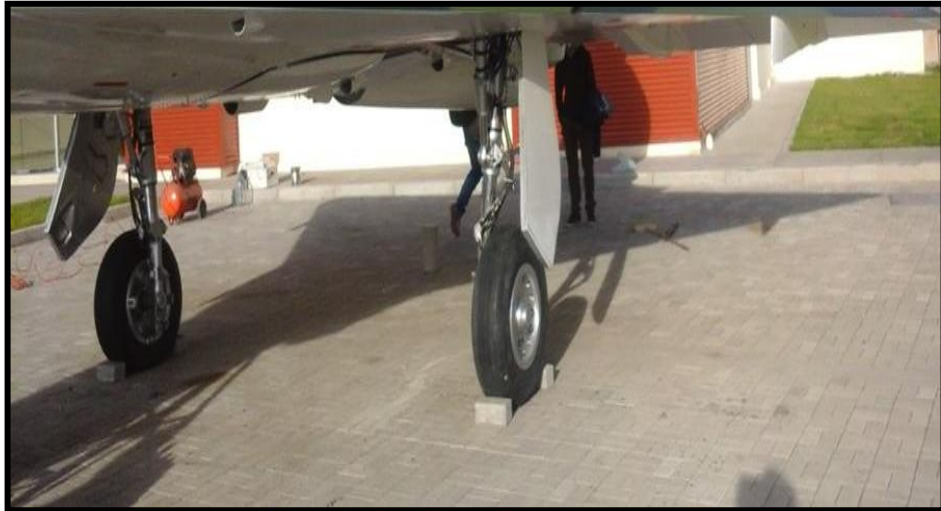
Figura 38 Acabado del pintado en los trenes de aterrizaje
