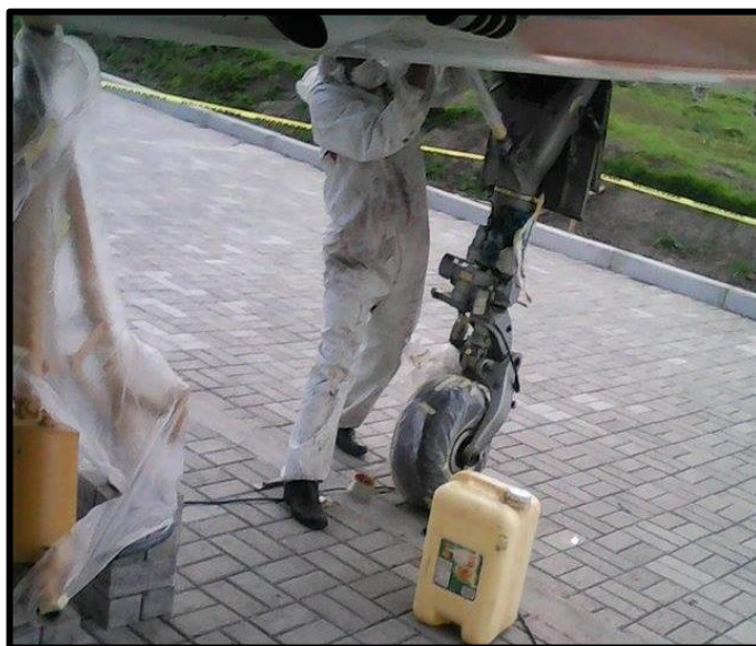
Figura 34 Aplicación de fondo en los trenes de aterrizaje
