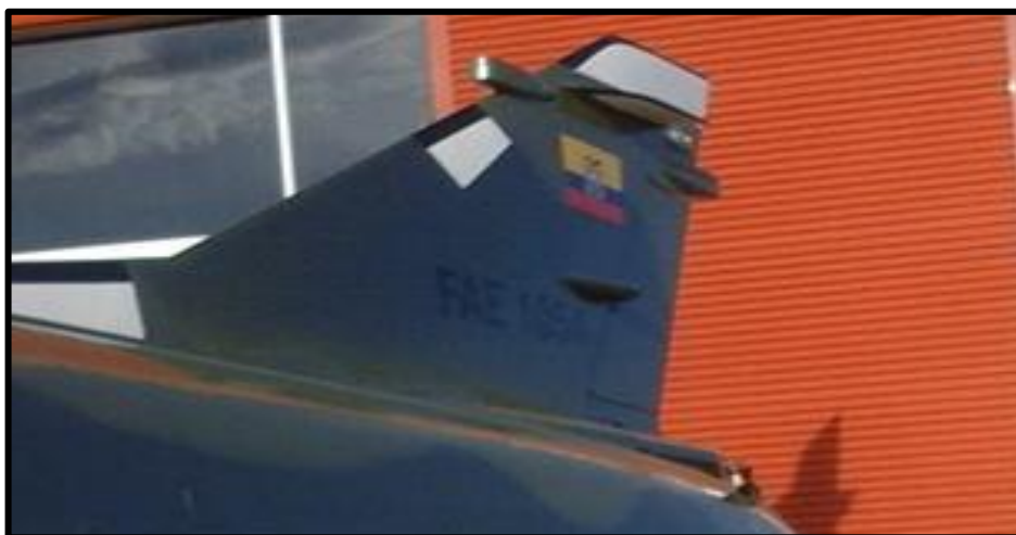
Figura 35 Acabado del pintado en el empenaje
