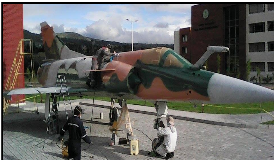
Figura 39 Aeronave aplicada la primera capa
