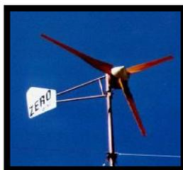
Figura 1.11. Orientación del aerogenerador mediante una veleta.
