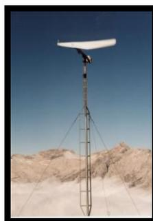
Figura 1.6. Aerogenerador Monopala.
