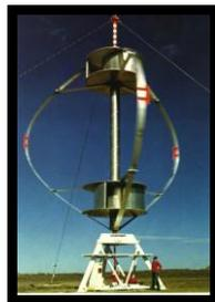
Figura 1.4. Aerogenerador de eje vertical Darrieus.
