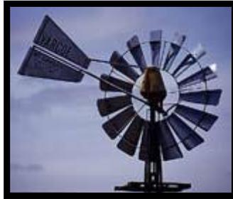
Figura 1.9. Aerogenerador Multipala.
