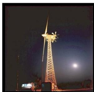
Figura 1.12. Orientación del aerogenerador mediante un molino auxiliar.
