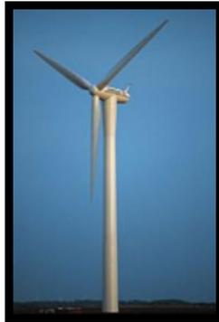
Figura 1.5. Aerogenerador de eje horizontal que genera una potencia de 1.5 Mw.
