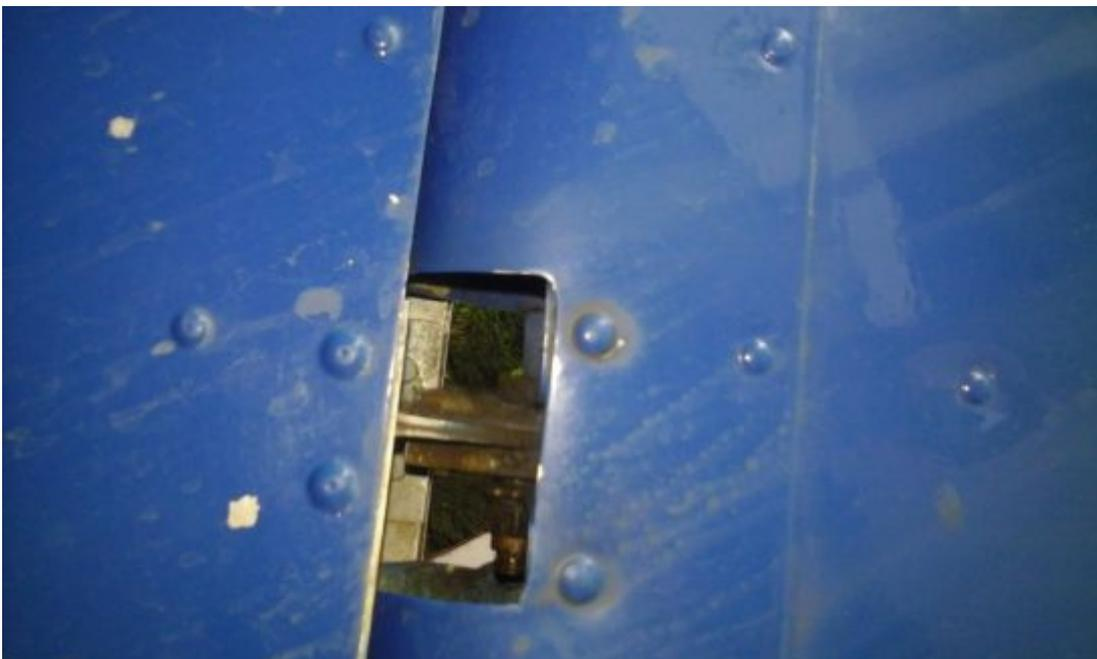
**Figura 56** Fijación de perno superior de Rudder
