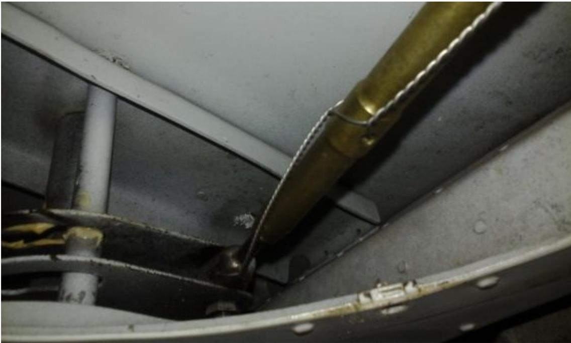
**Figura 38** Turnbuckle Alerón derecho
