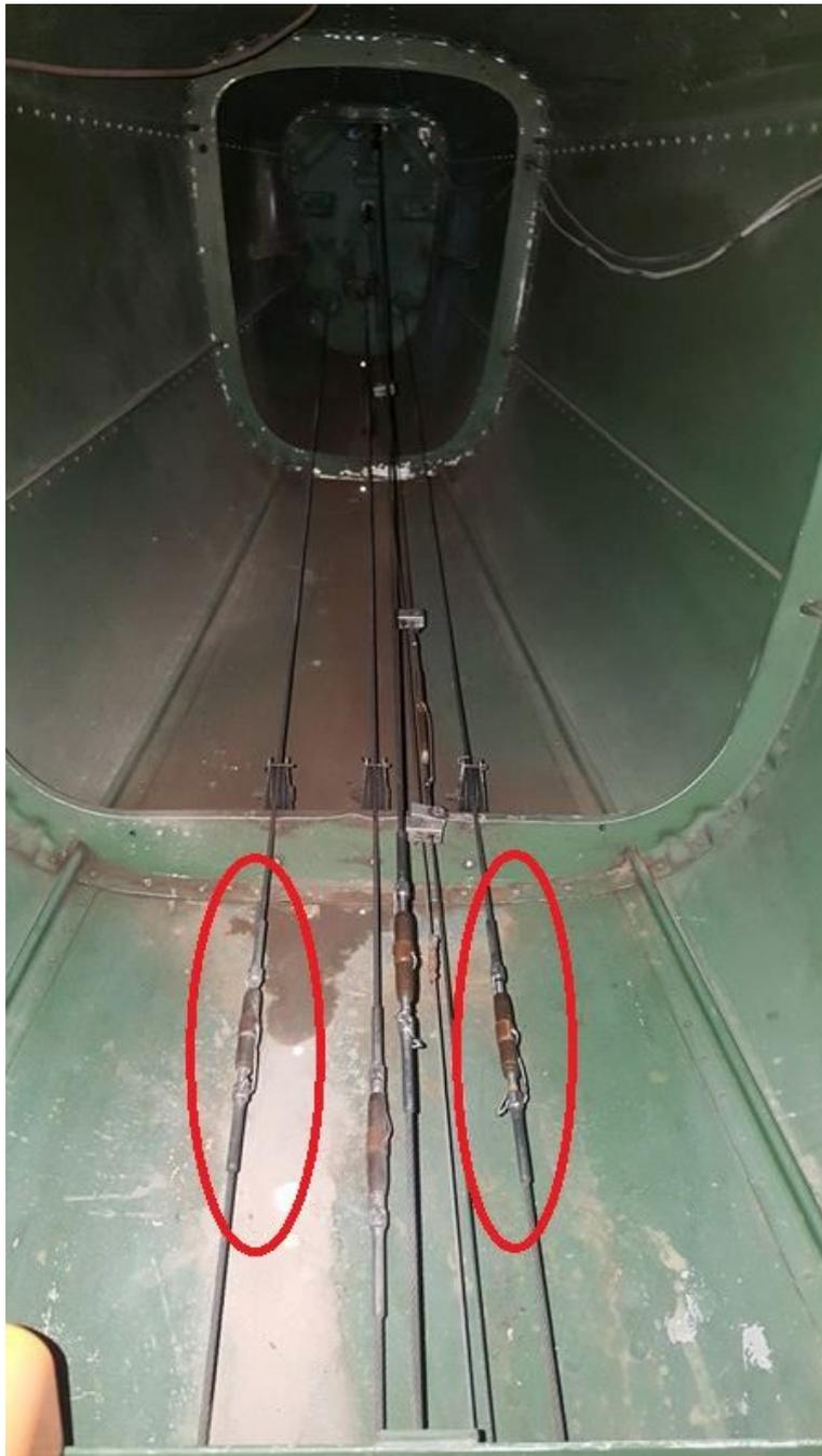
**Figura 60** Ajuste de Turnbuckles de Rudder
