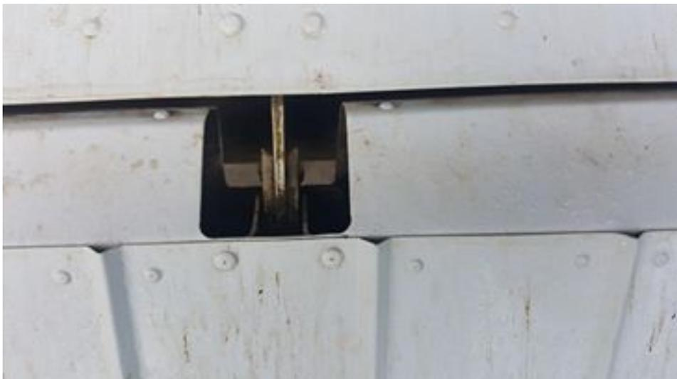
**Figura 43** Instalación de perno intermedio de elevador
