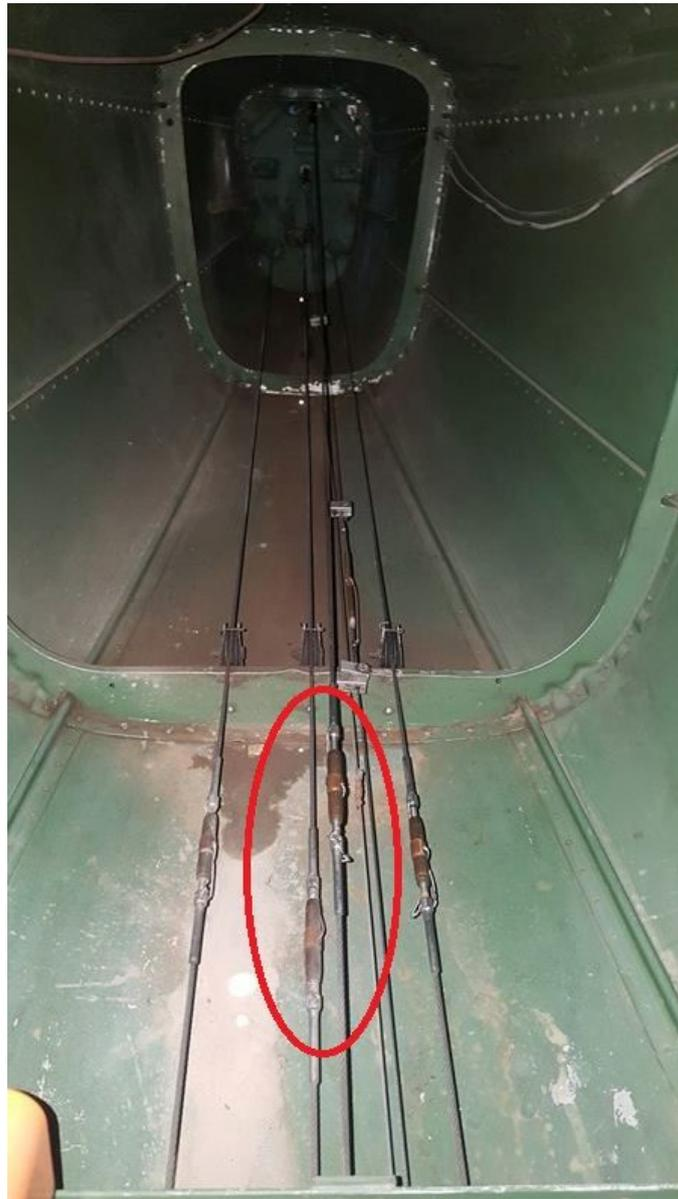
**Figura 48** Ajuste de turnbuckles de Elevadores
