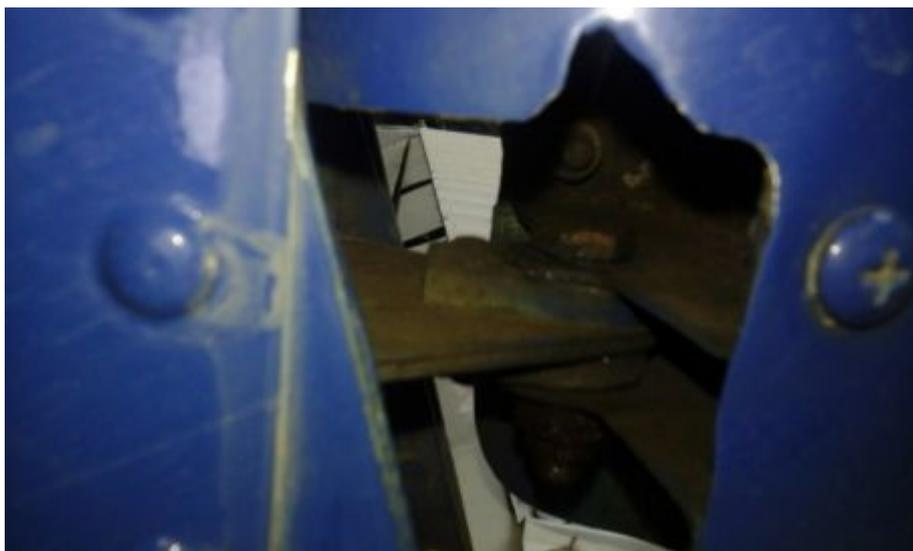
**Figura 54** Fijación de perno inferior de Rudder
