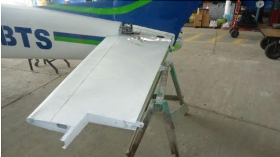
**Figura 29** Inspección de bisagras de estabilizador horizontal
