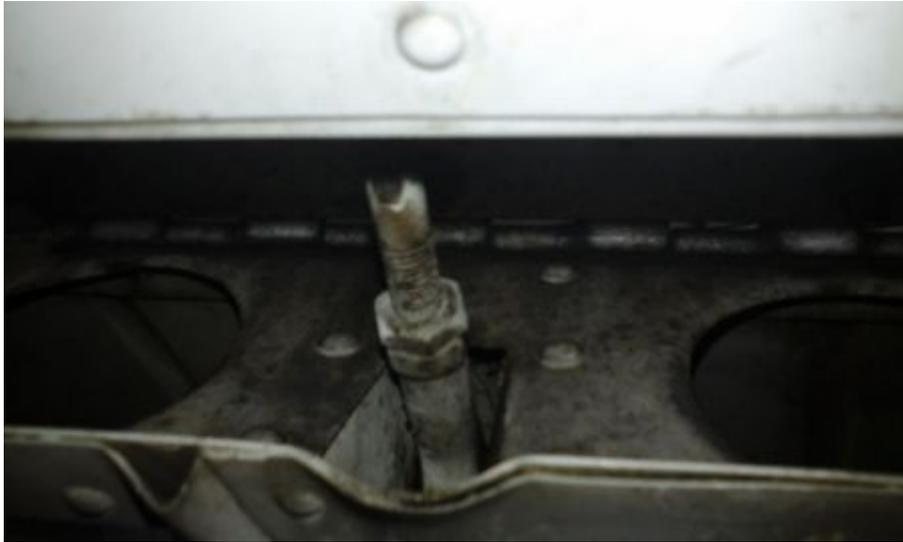
**Figura 40** Unión push-pull rod al alerón
