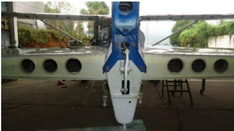
**Figura 30** Inspección de bellcranck de elevador
