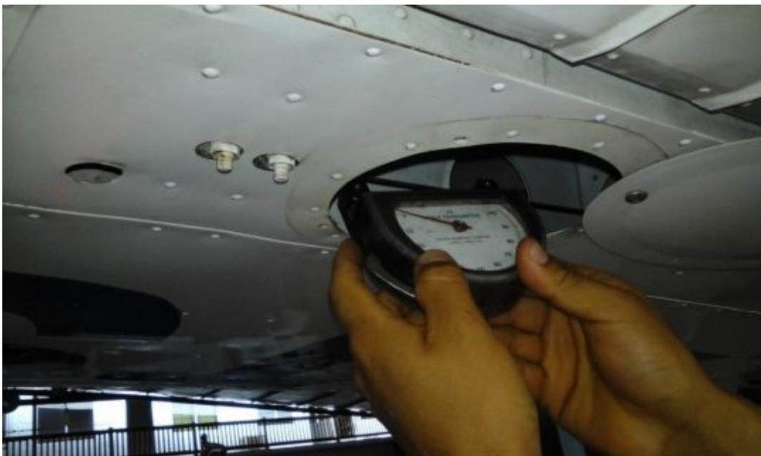
**Figura 39** Tensión de cables
