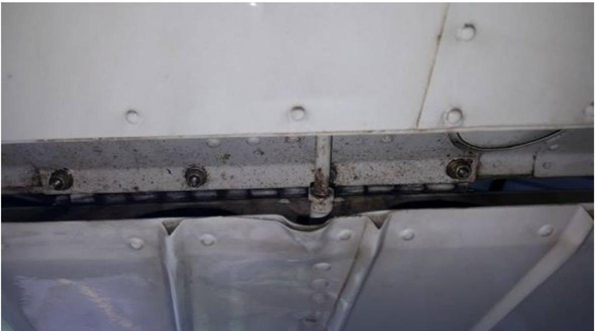
**Figura 34** Unión Push-Pull rod al Alerón
