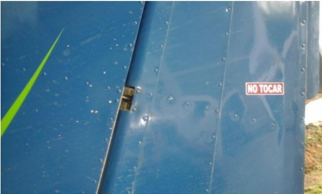
**Figura 55** Fijación de perno intermedio de Rudder
