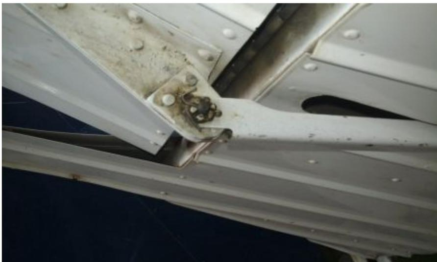
**Figura 50** Unión push-pull rod elevador al trim tab
