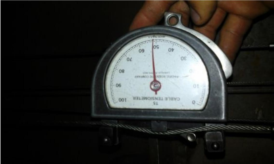
**Figura 61** Control de tensión de cables
