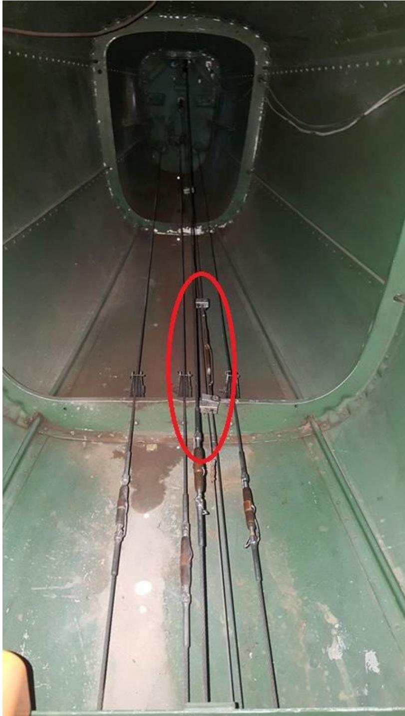
**Figura 51** Ajuste de turnbuckles de Elevadores
