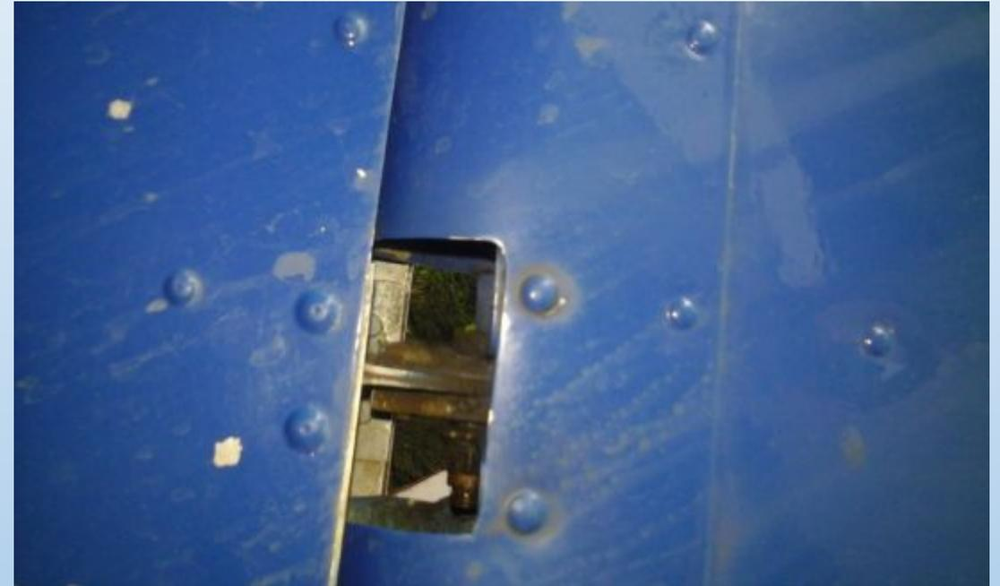
Fijación de perno superior de Rudder
